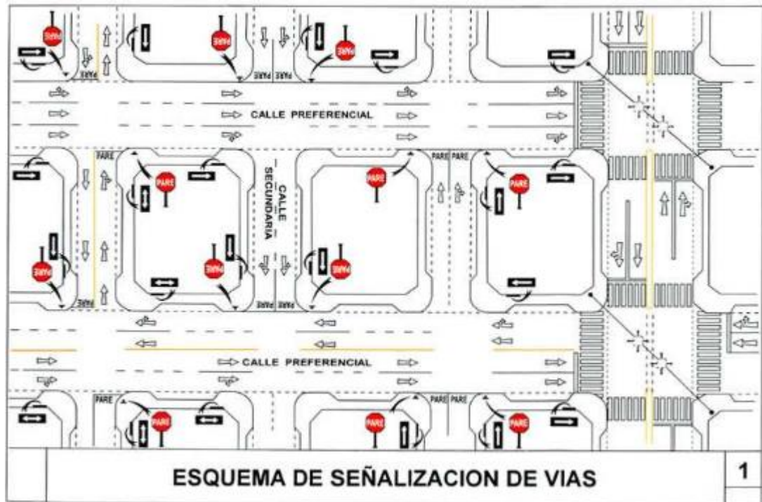
Figura 6 - Señalización de vías
