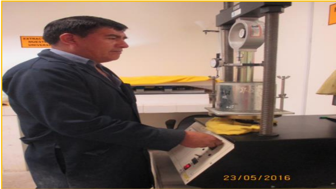
Fotografía N° 22: Se aprecia al laboratorista preparando la prensa hidráulica para el ensayo de penetración.
