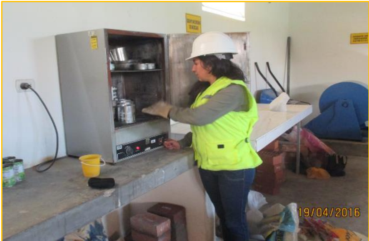
Fotografía N° 4: Colocación del material húmedo y el contenedor en el horno.
