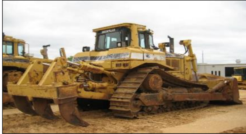
Figura N° 04: Escarificación de suelo.
