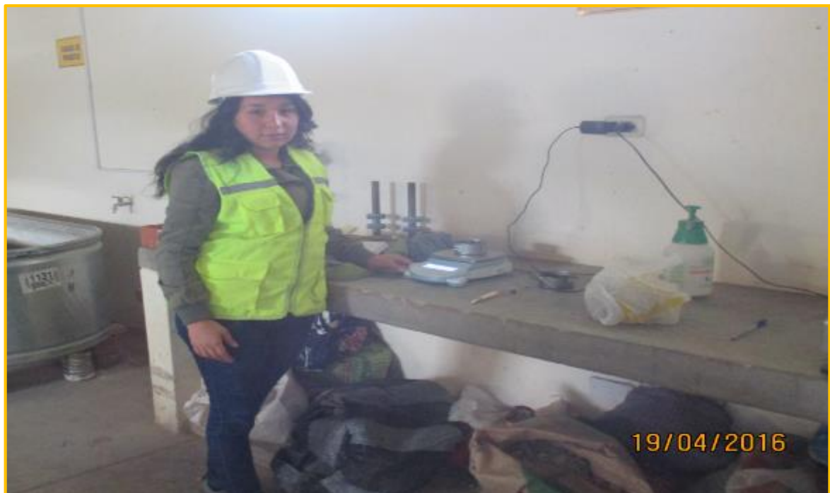
Fotografía N° 5: Se determinó el peso del contenedor y el material secado al homo.
