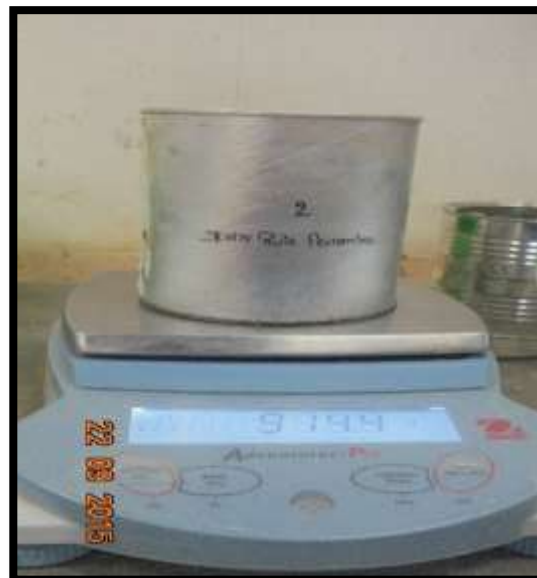
Fotografía N° 04: Toma de muestras de arcilla en la tara 02, para el contenido de humedad.
