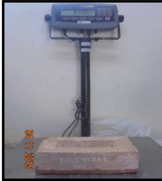
Fotografía N° 37: Pesado de los ladrillos sometidos al ensayo de succión.
