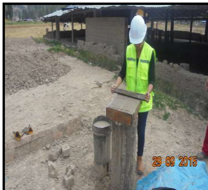
Fotografía N° 16: Enrazado de la mezcla de arcilla.
