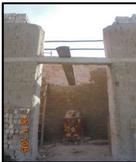
Fotografía N° 22: Quemado de los ladrillos de arcilla con 5%,10%,15%, 25%, 50%.
