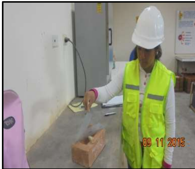
Fotografía N° 43: Ensayo de alabeo, sección convexa.
