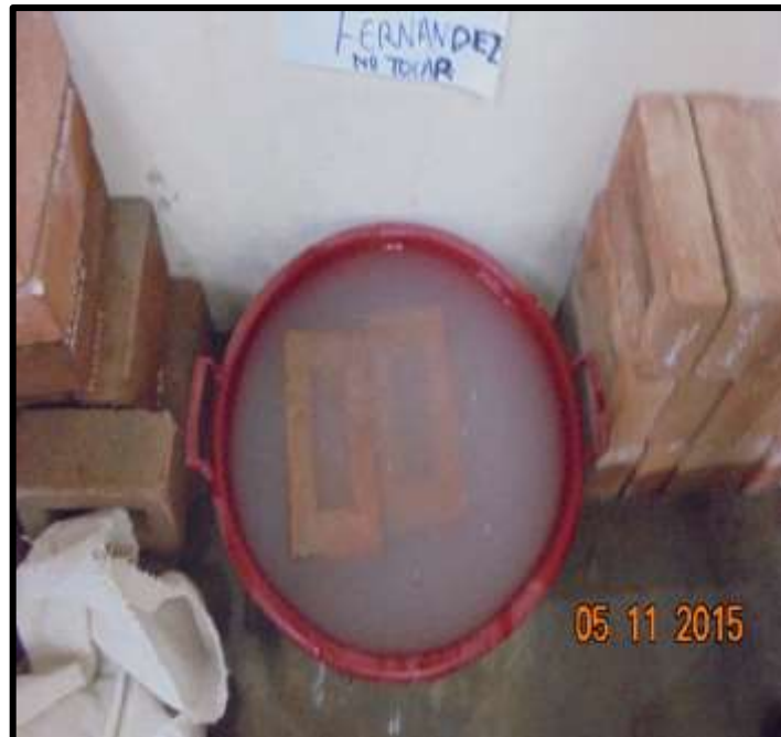
Fotografía N° 38: Ladrillos sometidos al ensayo de absorción por 24 horas.
