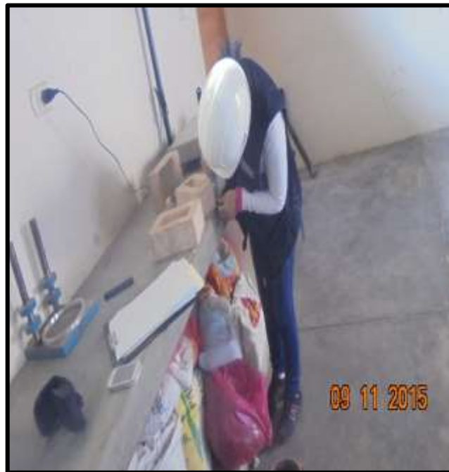
Fotografía Nº 27: Medición del alto del ladrillo de arcilla.
