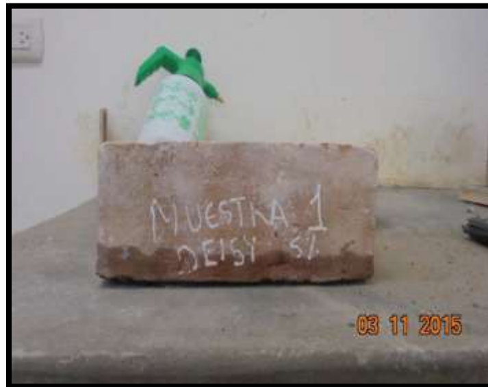
Fotografía N° 31: Ladrillo ensayado con 3 cm de altura de absorción.
