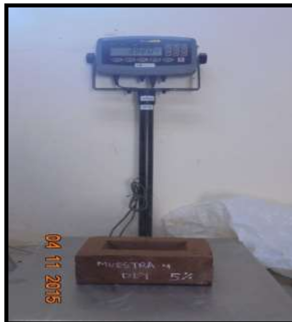
Fotografía N° 34: Pesado de los ladrillos sometidos al ensayo de absorción, por 24 horas sumergidos en agua.
