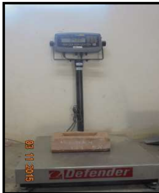
Fotografía N° 32: Pesado de los ladrillos sometidos al ensayo de succión
