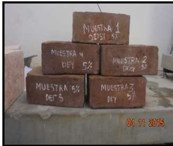
Fotografía N° 35: Ladrillos sometidos al ensayo de absorción por 24 horas.
