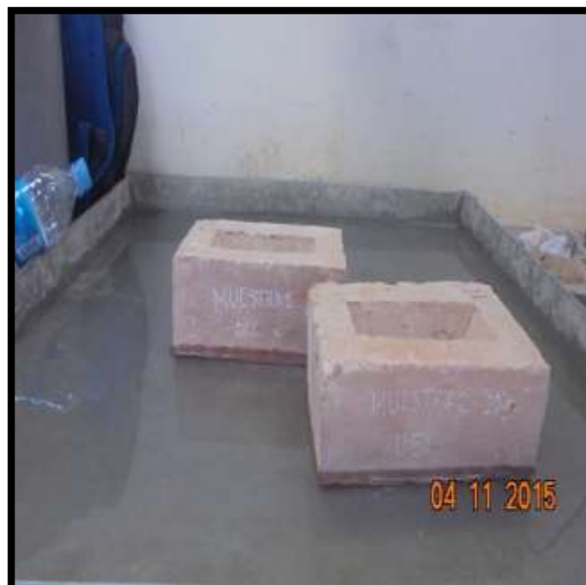
Fotografía N° 36: Ensayo de succión de los ladrillos de arcilla con 10% de vidrio triturado.
