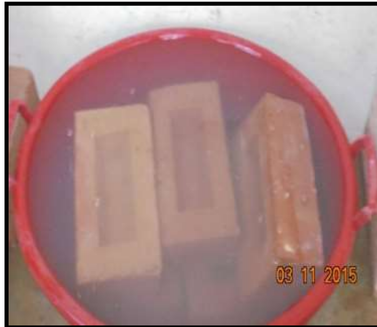
Fotografía N° 33: Ensayo de Absorción durante, 24 horas.
