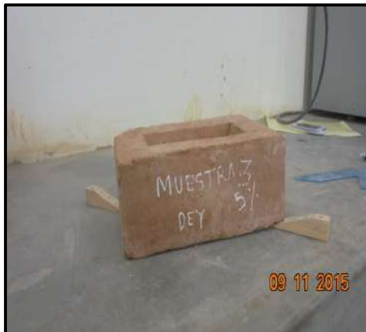
Fotografía N° 42: Ensayo de alabeo, sección convexidad.
