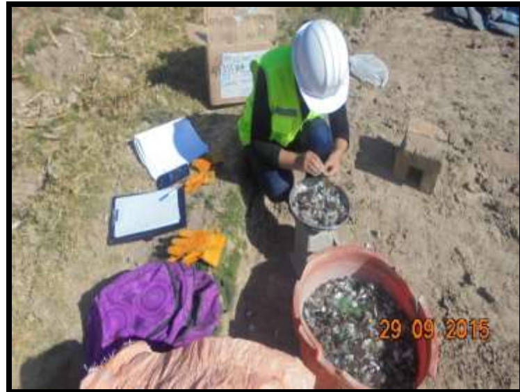
Fotografía N° 11: Selección de vidrio triturado, para la elaboración del ladrillo de arcilla.
