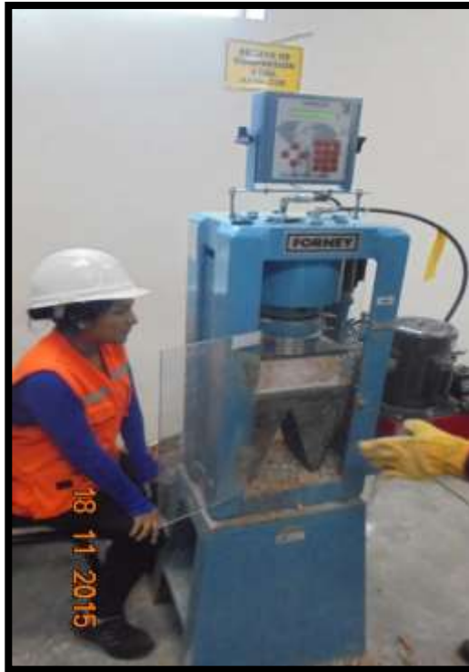
Fotografía N° 51: Toma de datos del ensayo axial a los ladrillos.
