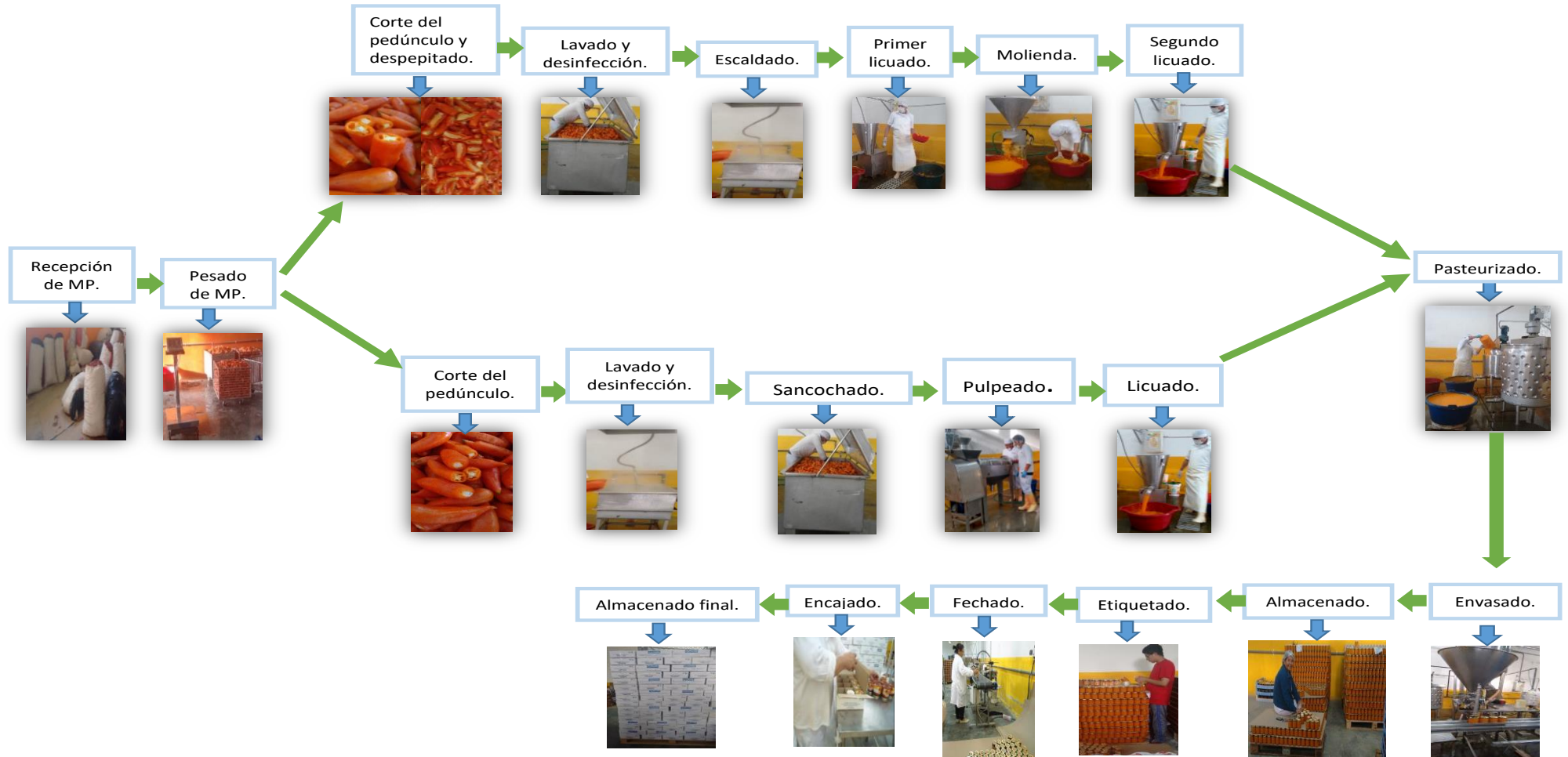
Figura n.º 30: Esquema del proceso productivo de la pasta de ají amarillo. Fuente: Elaboración propia.
