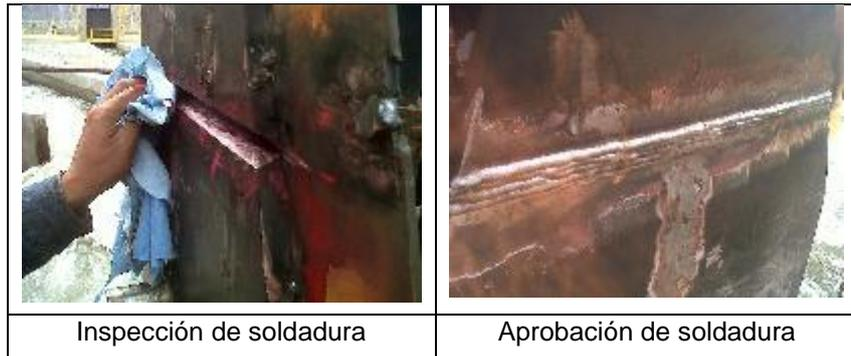
**Figura n.º 3-40. Proceso de inspección de soldadura con NDT**
