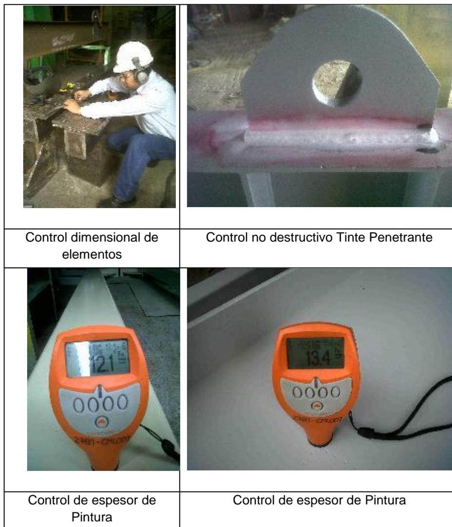
**Figura n.º 3-34. Control de calidad de estructuras de disipador**
