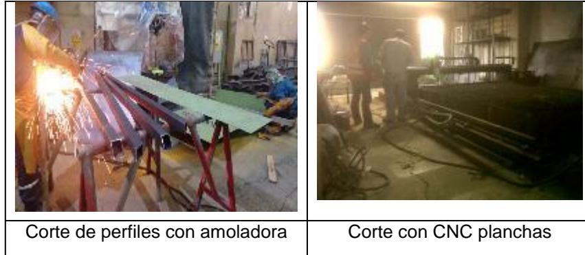
**Figura n.º 3-27. Corte de material con CNC y amoladora**
