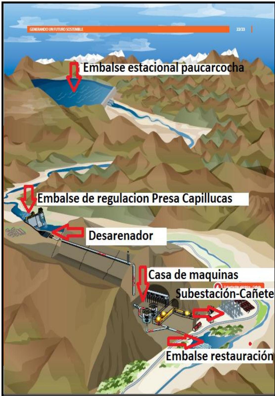
Figura n.º 3-2. Infraestructura central hidroeléctrica El Platanal - Celepsa
