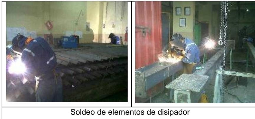
**Figura n.º 3-29. Proceso de soldadura de disipador**
