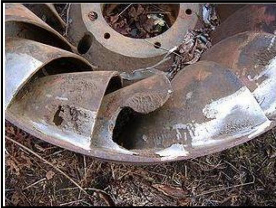
**Figura n.º 3-6. Desgaste de álabes de turbina ocasionado por erosión.**
