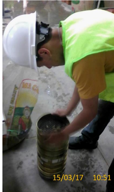
Dibujo n°. 19. Tamizado de arena
