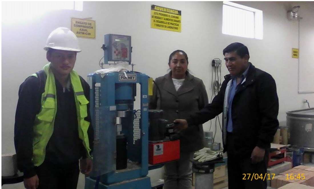
Foto n°. 1. Ensayo de resistencia a compresión
