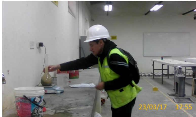
Dibujo n°. 9. Peso de la arena en el matraz
