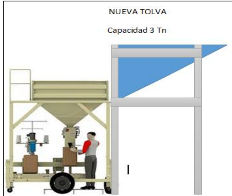
Figura 17 Nueva tolva de ensaque
