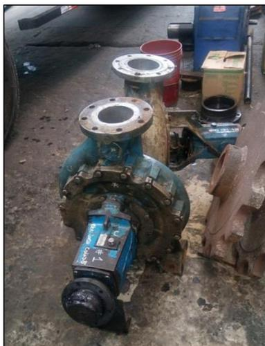
cambio de eje del impulsor, rodajes, retenes, reparación de voluta, alabes para bomba de jugo crudo
