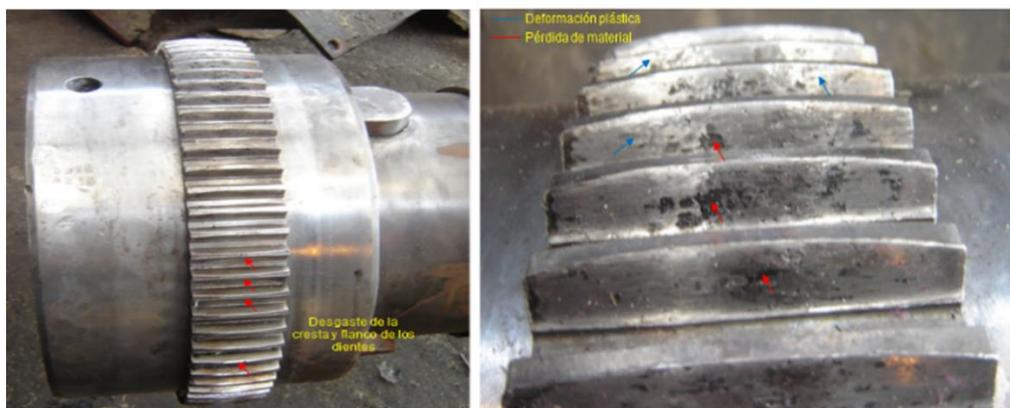
**Conductor N° 7 de Caña:** Los dientes del semi-acoplamiento del eje motriz presentan pérdida de material, desgaste y deformación plástica.
