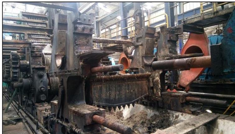
Falla en molino N° 1 - desmontaje de mazas, cuchillas centrales, bronces, acoples ACIP
