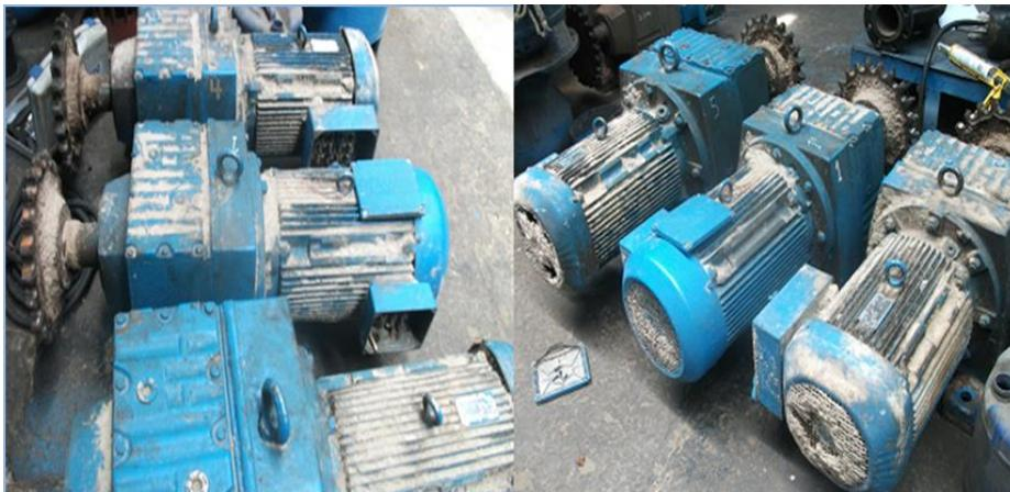
Estado de los motores de extracción para mantenimiento en Taller Electrico
