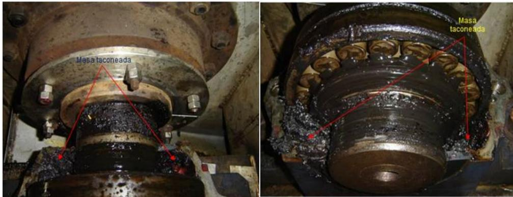
**Falla en Mezclador de Masa "A" / Centrifugas Bateria "A" / Rodamiento (lado Punta) del Eje Motriz:** Se encontró el rodamiento totalmente taconeado con masa solidificada; asimismo, huellas de Deslizamiento Circular entre las superficies exteriores de las Pistas Externas y las superficies de apoyo (alojamiento) de los rodamientos.
