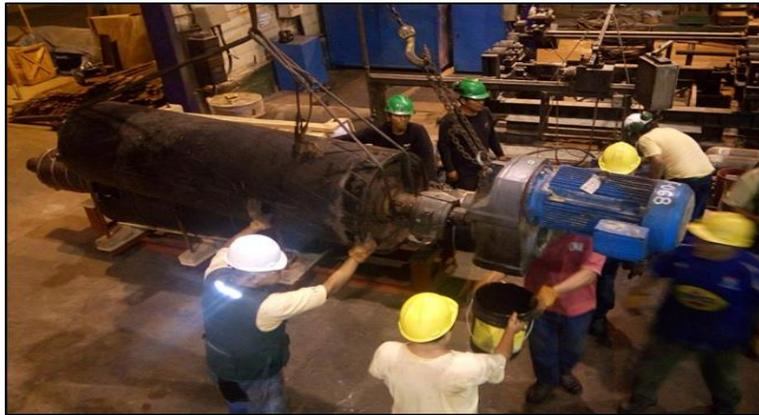
**Desmontaje de tambor motriz de conductor magnético por presentar eje y rodamientos de chumaceras fallados**
