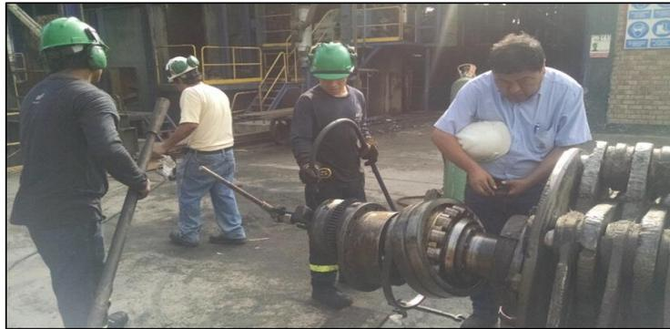
Cambio de rodaje de rodillo esférico de lado acoplamiento, el cual salió con pérdida de medida en la pista interior y presencia de humedad - COP
