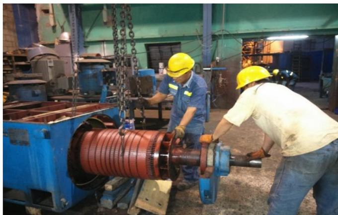
**Desmontaje del motor Cop 8- pesado, falla Electrico para inspeccion y mantenimiento.**
