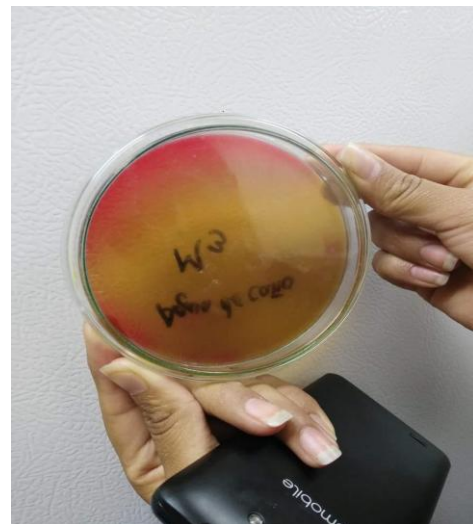
Figura 29: Resultado de coliformes termo tolerantes del agua del domicilio. Fuente: Elaboración Propia
