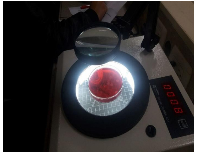
Figura 23: Conteo de coliformes totales en el agua del reservorio. Fuente: Elaboración Propia
