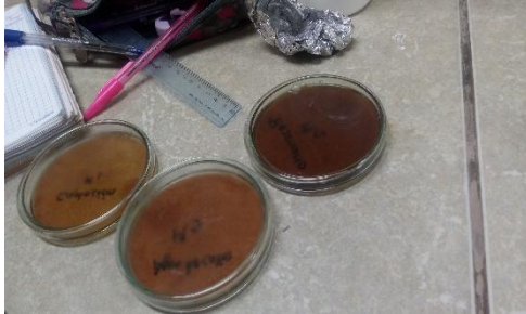
Figura 26: Muestras del agua de la captación, reservorio y domicilio, listos para ser encubados. Fuente: Elaboración Propia
