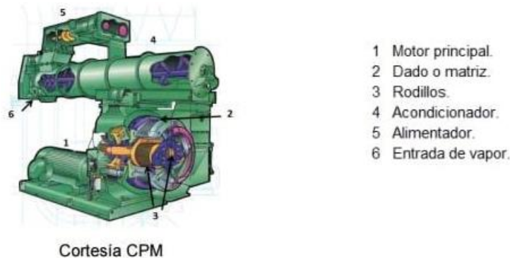
Figura n.º 5. Componentes principales de una peletizadora.
