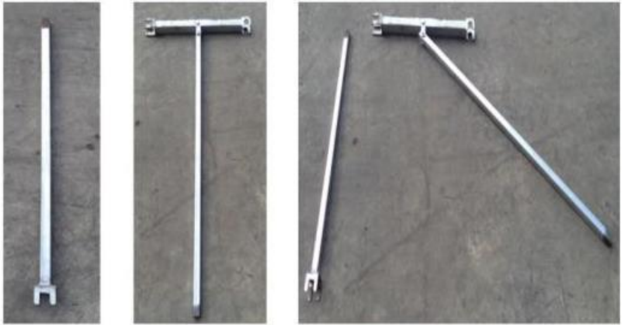
Figura 10 : Soportes articulados fabricados para la modificación de la carrocería.
