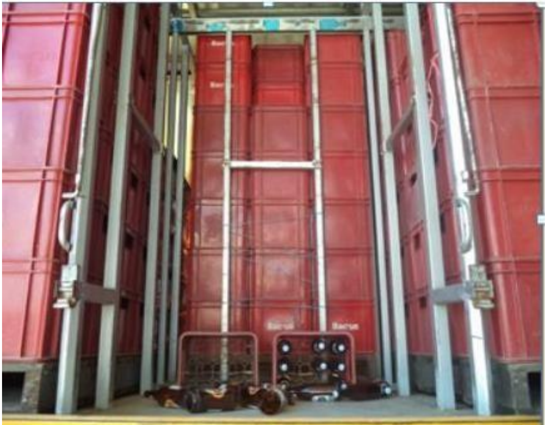
Figura 5 : Rotura de cajas por mal diseño de carrocería interna en vehículos.
