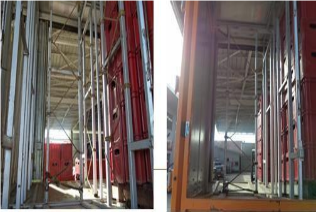
Figura 6 : Colocación de sogas en carrocería interna para evitar rotura de cajas.
