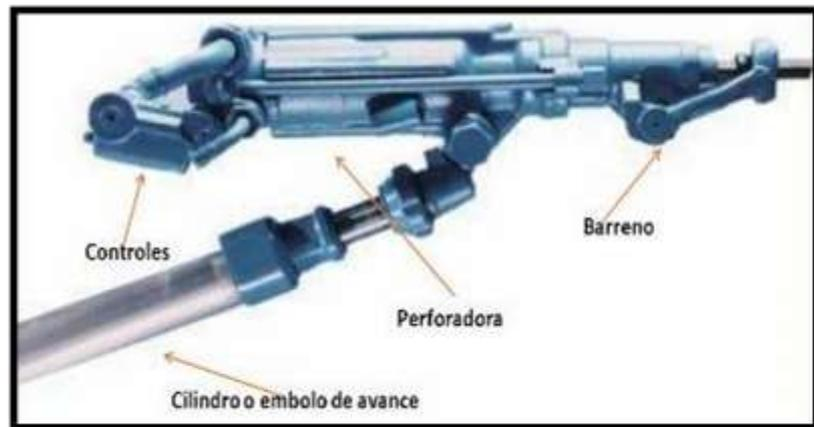
*Figura N° 4. Perforadora Jack Leg*
