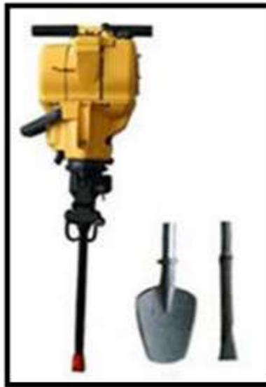
*Figura N° 5. Perforadora Jack Hammer*
