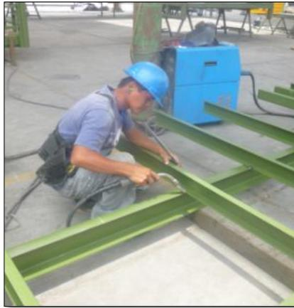
Figura 8: Soldadura de estructuras
