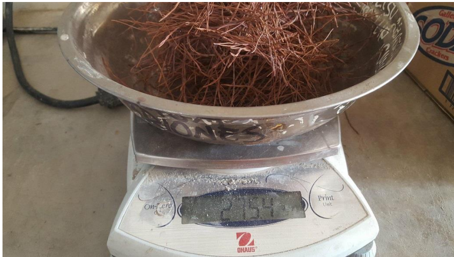
Figura 30: Fibras de filamentos de cobre reciclado.
