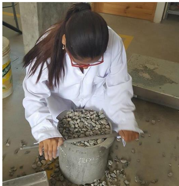
Figura 34: Enrasado de la muestra para el peso unitario del agregado grueso
