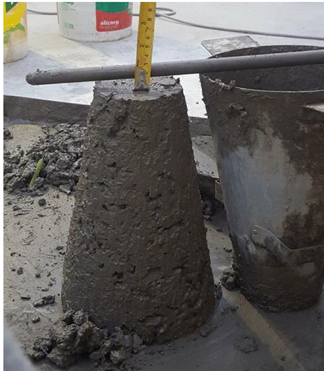
Figura 44: Medida del asentamiento del concreto reforzado a 8 kg/m 3 .
