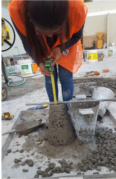
Figura 41: Medida de asentamiento del concreto
