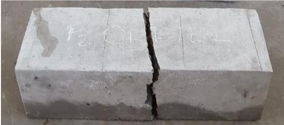
Figura 53: Rotura de espécimen sin fibras
