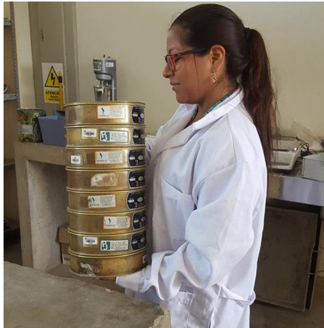
Figura 31: Agitado de la muestra, para el análisis granulométrico de los agregados.
