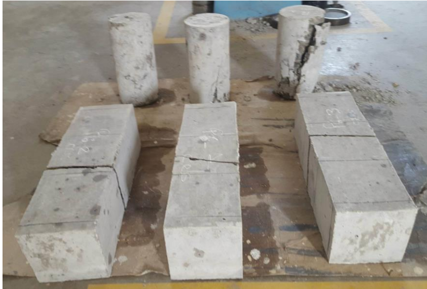
Figura 51: Rotura de la primera tanda de especímenes
