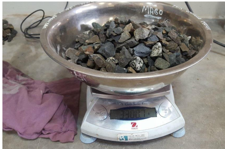
Figura 35: Muestra de agregado grueso para el contenido de humedad.
