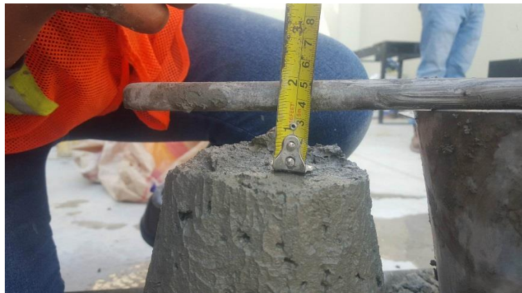
Figura 42: Medida del asentamiento del concreto patrón.
