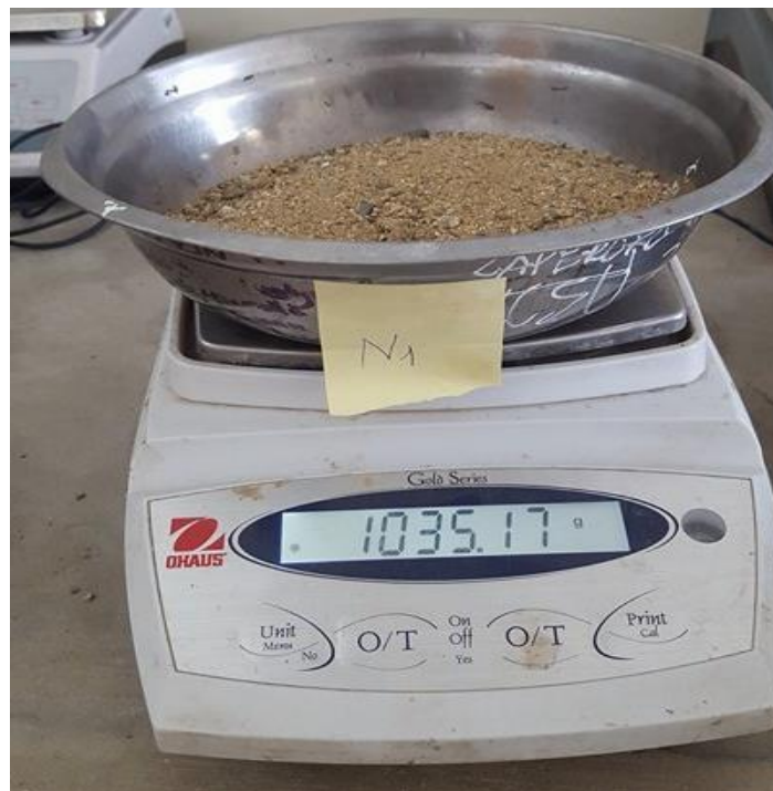
Figura 36: Muestra de agregado fino para el contenido de humedad.
