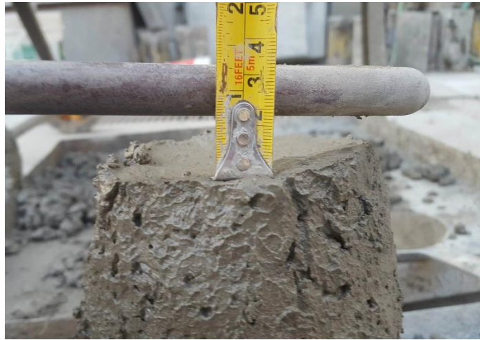
Figura 43: Medida del asentamiento del concreto reforzado a 6 kg/m 3 .
