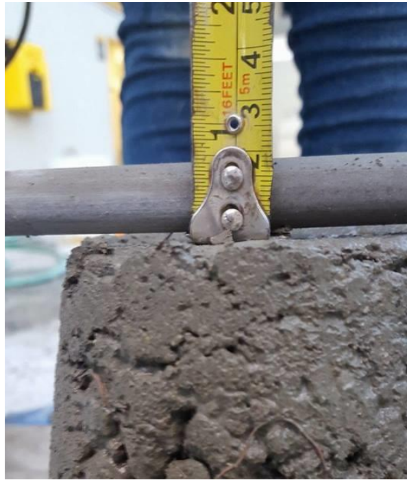
Figura 45: Medida del asentamiento del concreto reforzado a 10 kg/m 3 .
