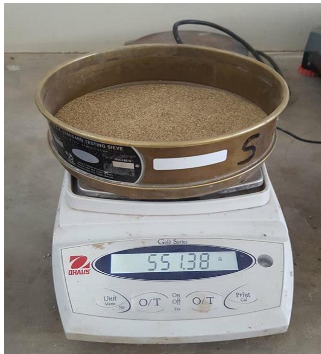
Figura 32: Peso de la muestra retenida por la malla No 50.
