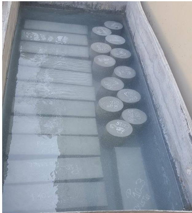
Figura 46: Curado de probetas de concreto
