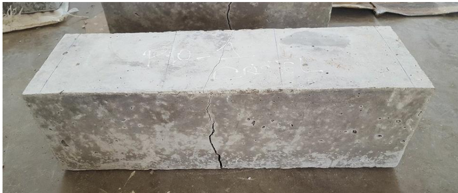
Figura 54: Rotura de espécimen con fibras
