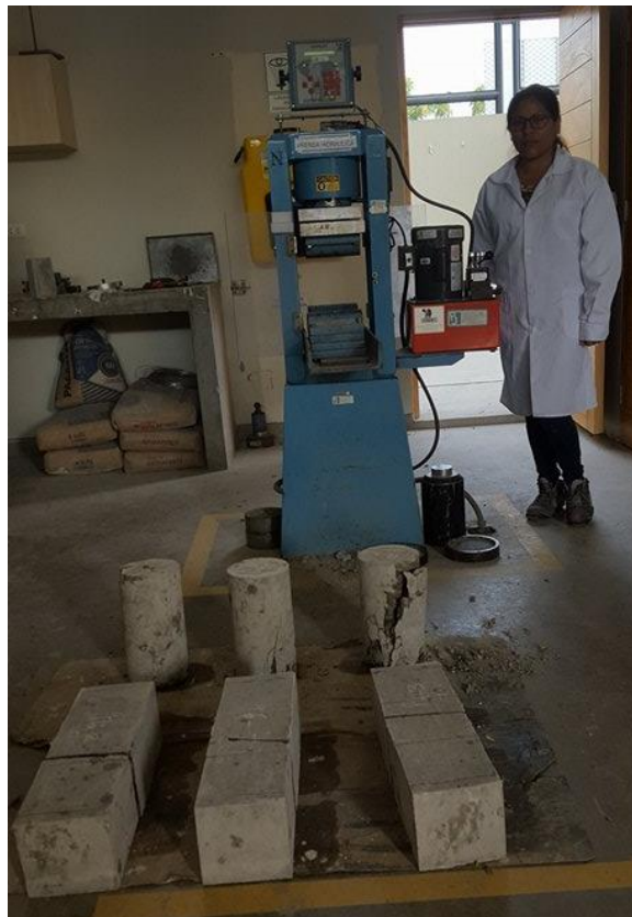
Figura 52: Rotura de especímenes por parte de la autora de la tesis.
