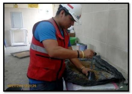
**FOTO 12:** Procedimiento para encontrar el peso específico del agregado grueso.
