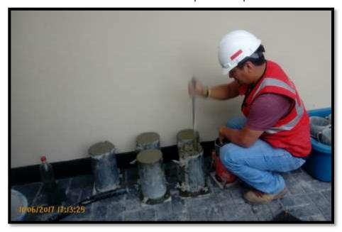
FOTO 16: Elaboración de especímenes con un 8% de aditivo del peso del cemento.
