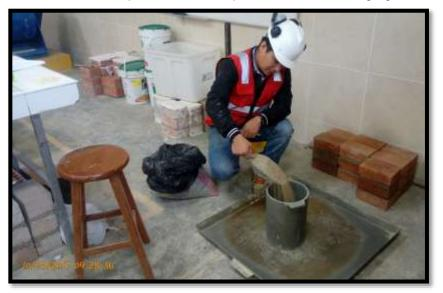
FOTO 08: Procedimiento para encontrar el peso seco suelto del agregado grueso.
