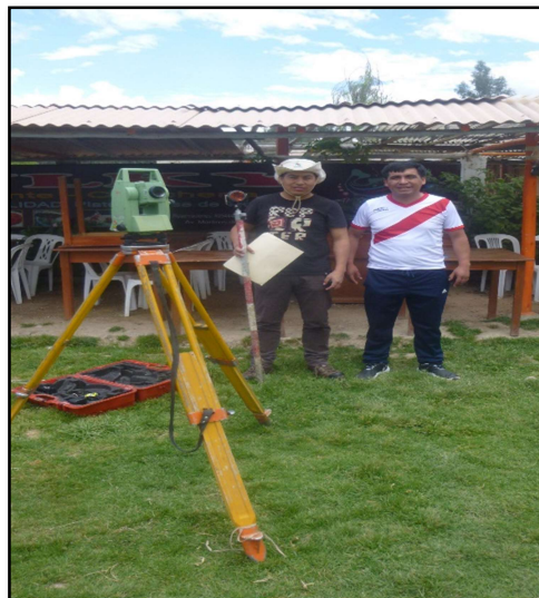
Figura 40. Equipos topográficos para encontrar la diferencia de cotas del terreno de la zona.
