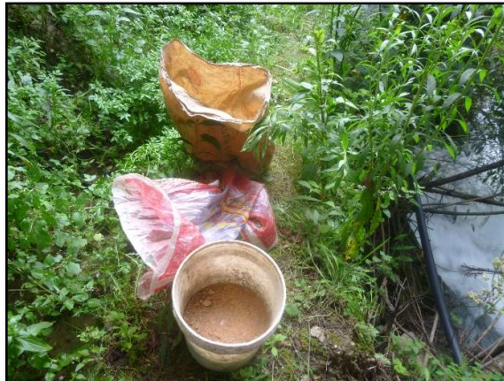
Figura 59. Materiales empleados (agregados cemento y piedra de \frac{3}{4} " utilizados para la construcción del dado de soporte
