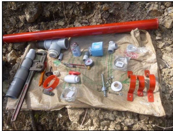
Figura 53. Diferentes componentes de la bomba de ariete ya en campo listos para ser ensamblados.
