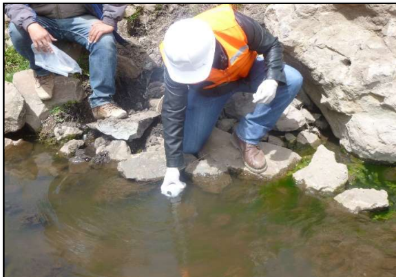
Figura 68. Toma de muestras de agua, en la zona de captación (A)
