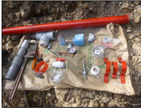
Figura 55. Diferentes componentes de la bomba de ariete ya en campo listos para ser ensamblados.
