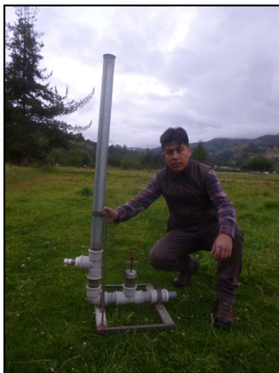
Figura 49. Vista de la bomba de ariete hidráulico.
