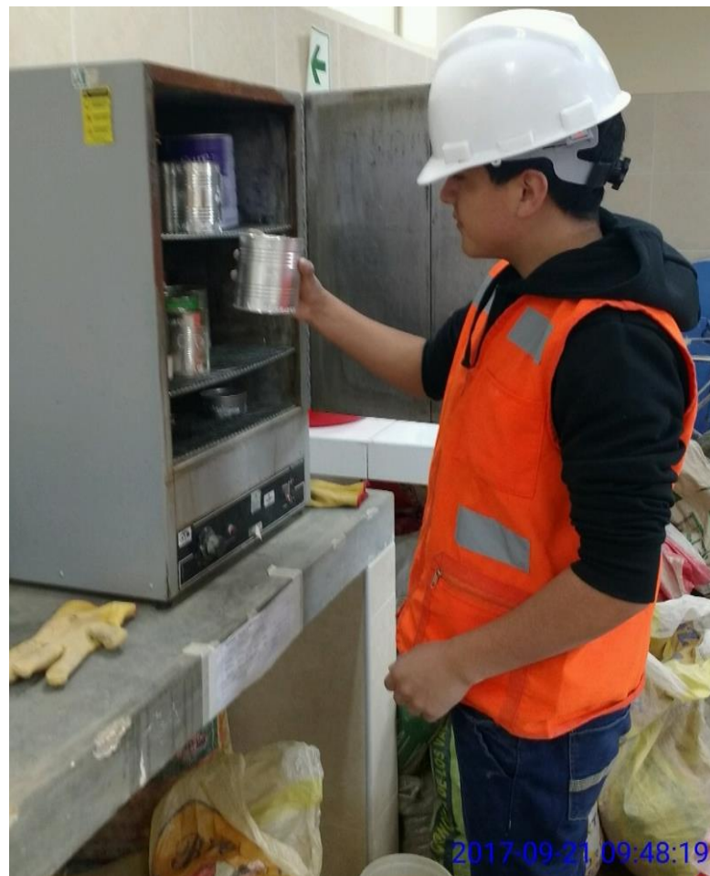
Figura 17: Ingreso de material al horno.
