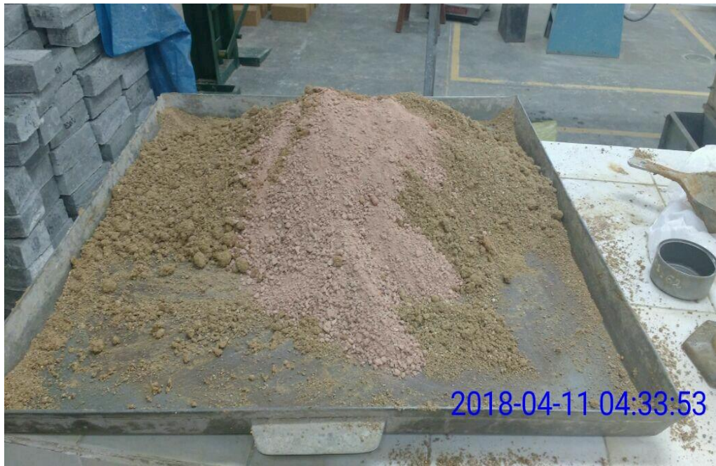
Figura 36: Preparación del material para la elaboración de adobe con reemplazo de desperdicio de ladrillo.
