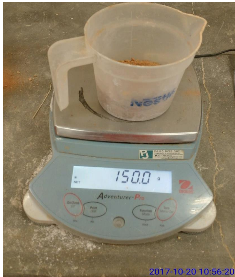
Figura 31: Obtención del peso de desperdicio de ladrillo.
