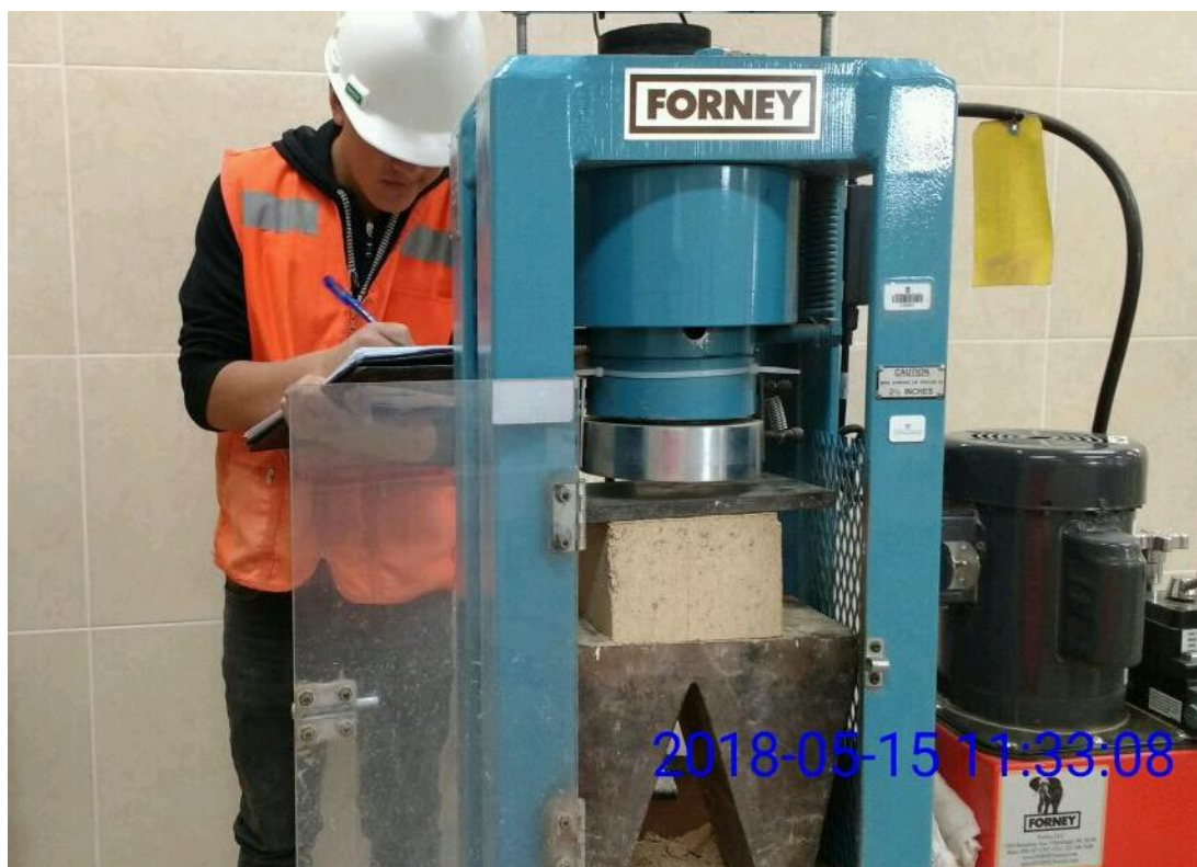
Figura 41: Ensayo a compresión de los adobes.
