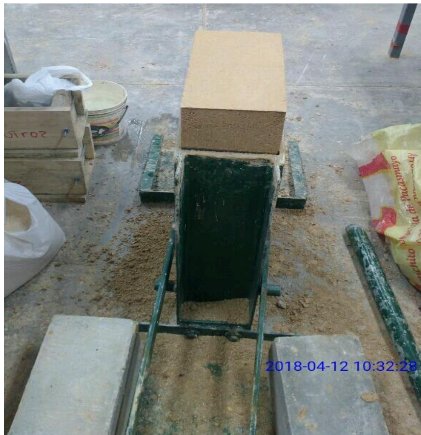
Figura 37: Elaboración de adobes para resistencia a flexión con la máquina compactadora CINVA RAM.
