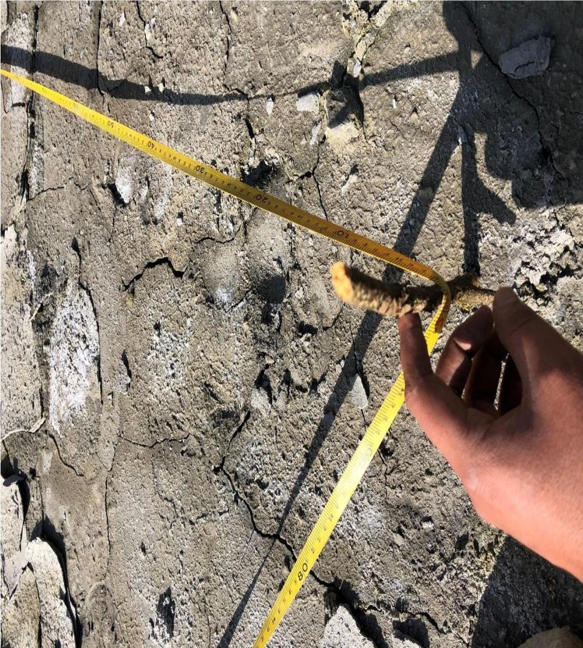
En la fotografía N° 4, se observa el procedimiento de medición para la malla de muestreo y la posterior realización de calicatas.
