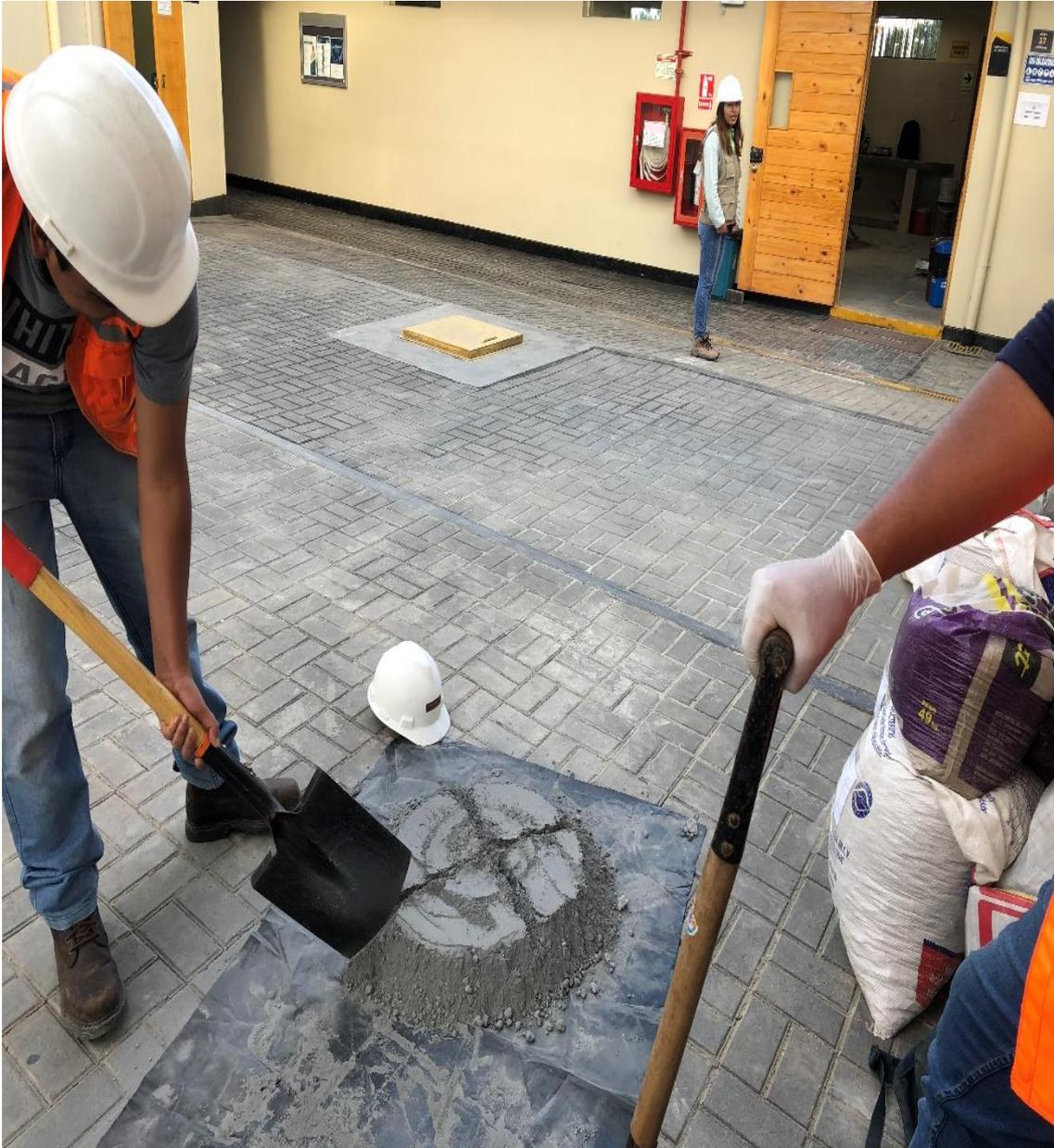
En la fotografía N° 7, se observa la realización del coneo o cuarteo, para la selección de muestra la cual será enviada a laboratorio.
