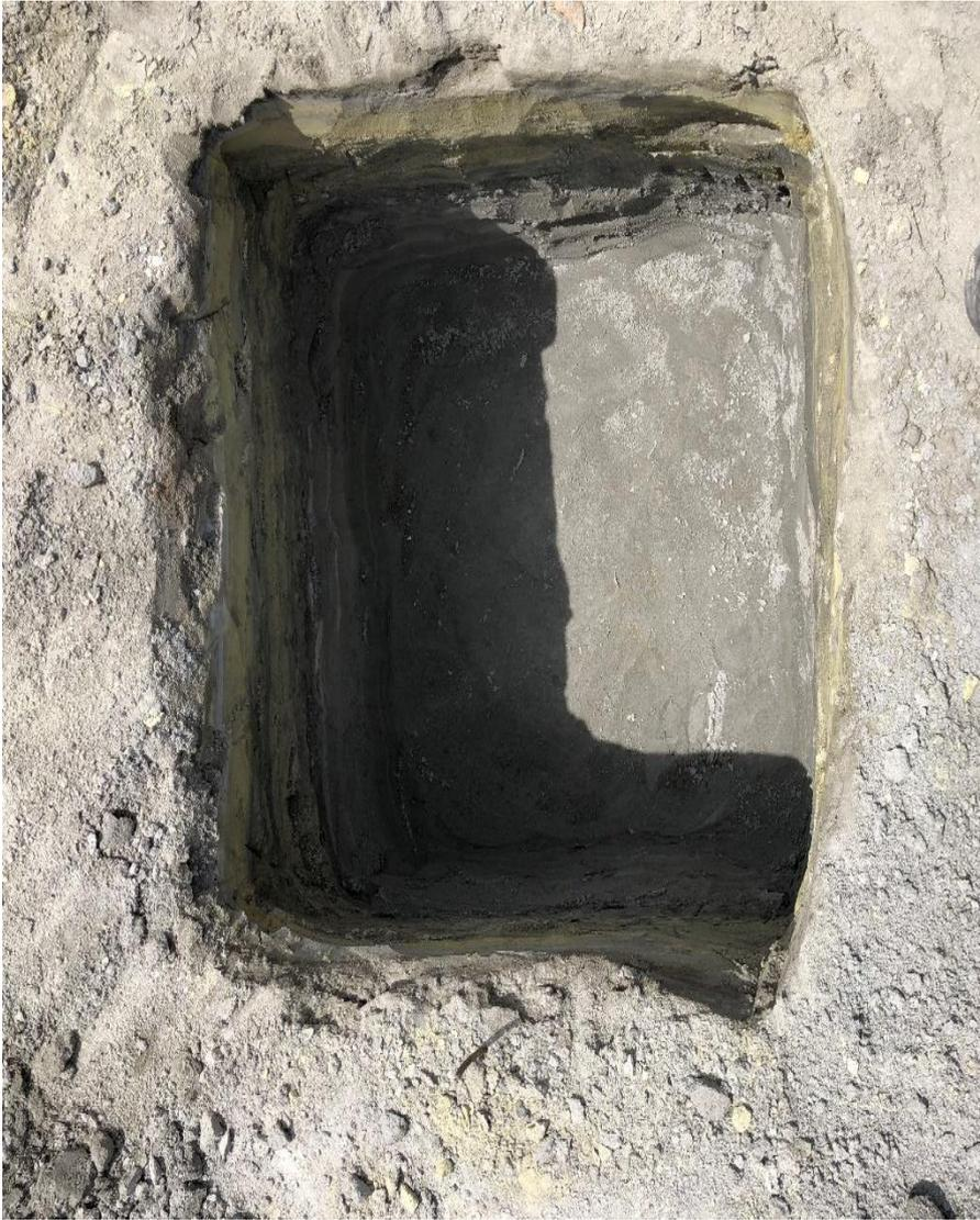
En la fotografía N° 6, se observa a la calicata terminada, lista para la extracción de la muestra.
