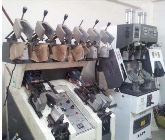
Figura 13: Maquina conformadora. Elaboración propia.
