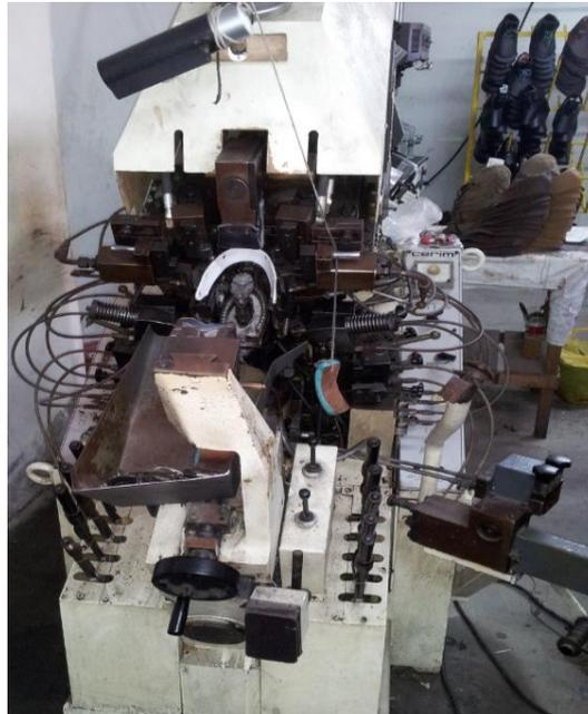
*Figura 15:* Máquina armadora de puntas. Elaboración propia.
