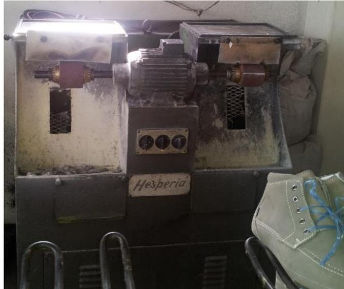
*Figura 19:* Calzadora y pulidora de calzados. Elaboración propia.
