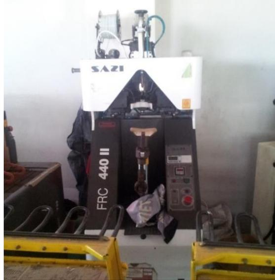
Figura 17: Armadora de talones. Elaboración propia.
