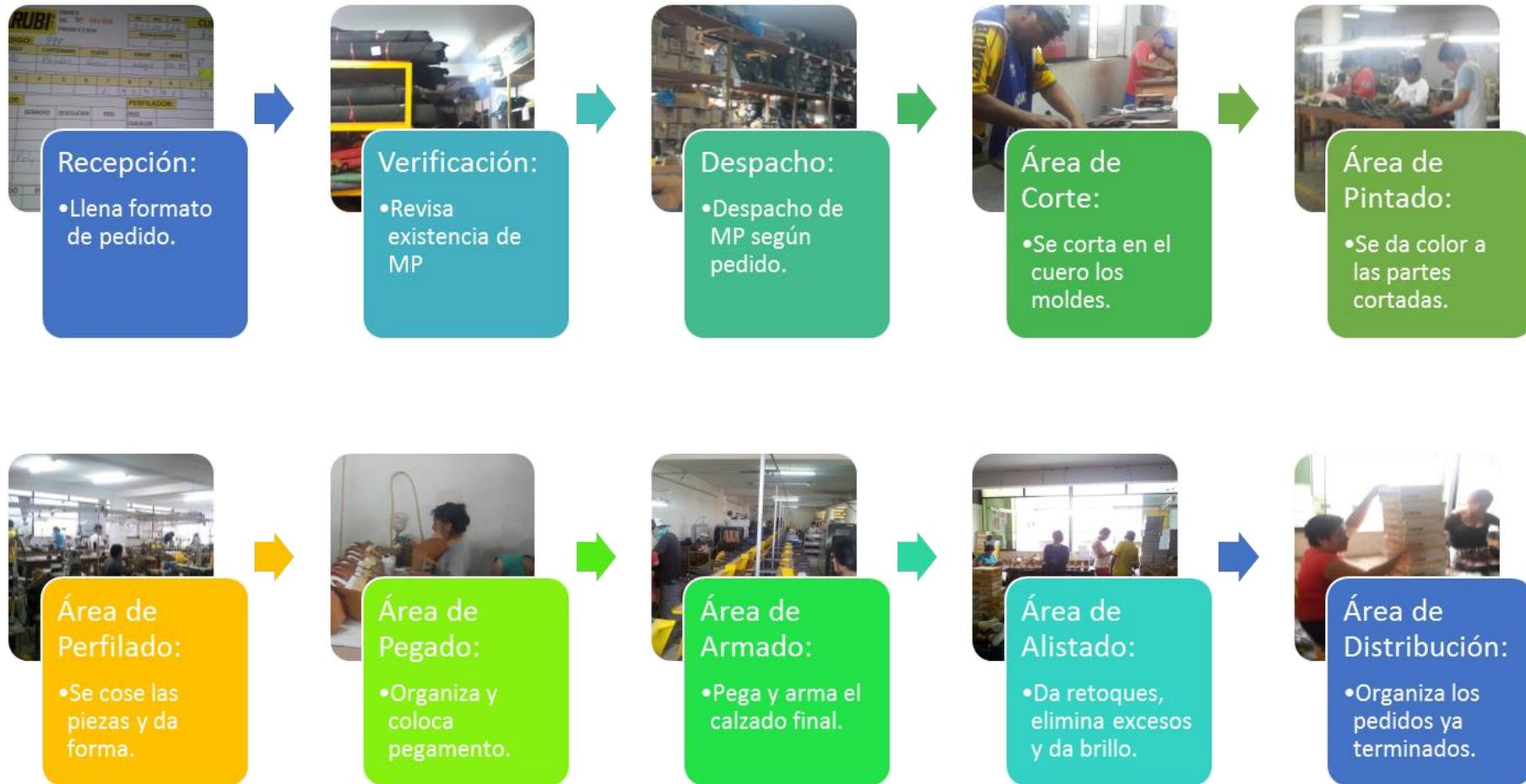
Figura 22: Diagrama pictórico de procesos de la empresa CARUBI S.A.C. Elaboración propia.
