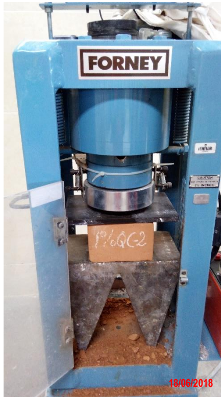
Figura 37 Inicio del ensayo de rotura a compresión de la unidad de adobe.
