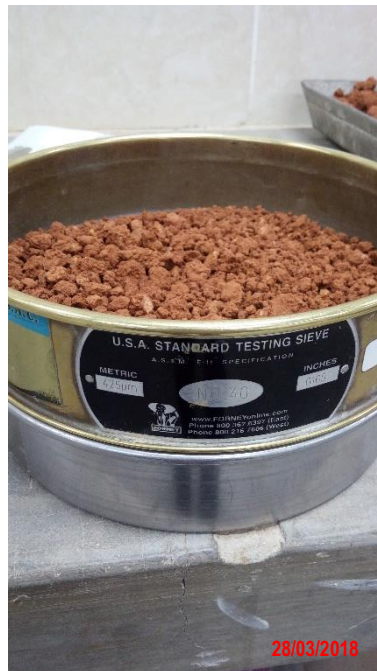
Figura 22 Tamizado del material para límites de consistencia.
