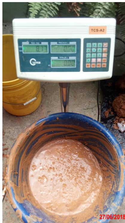
Figura 44 Peso de la “Unidad en Pie” luego del ensayo de absorción.
