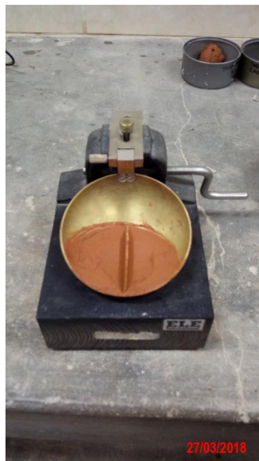
Figura 23 Determinación de número de golpes con la Copa de Casagrande.
