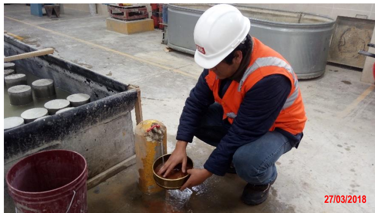
Figura 19 Lavado del Material.
