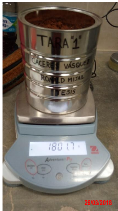
Figura 13 Una de las taras del contenido de humedad antes de colocar en el horno.
