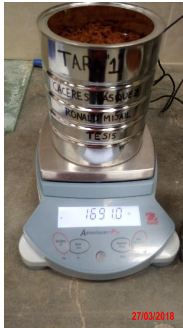
Figura 15 Tara con material pesado luego del secado al horno.
