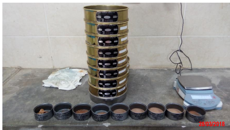
Figura 21 Tamizado del material restante secado al horno.
