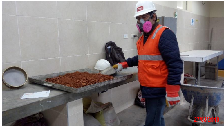
Figura 16 Inicio del cuarteo para la granulometría por lavado.
