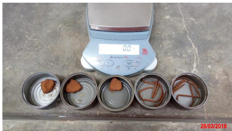
Figura 26 Pesado del material de límite de consistencia luego de su secado.
