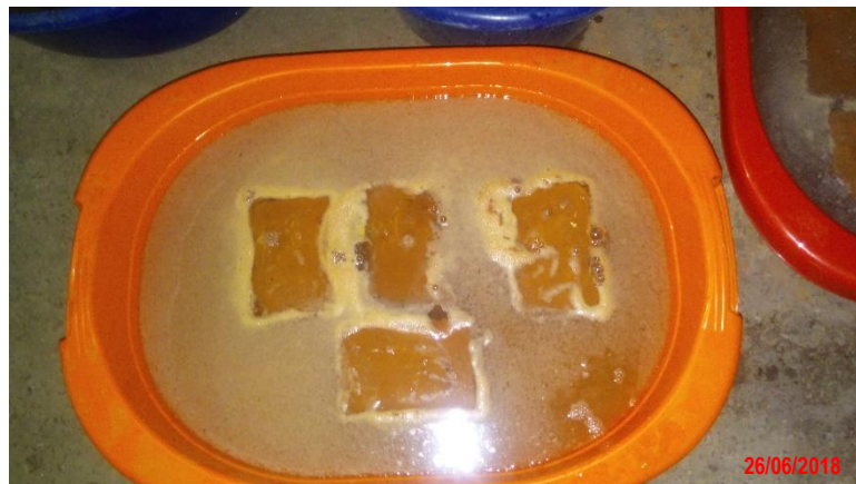
Figura 43 Sumergimiento de las unidades en agua.
