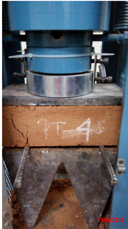
Figura 41 Adobe deteriorado luego del ensayo de rotura de flexión por tracción.
