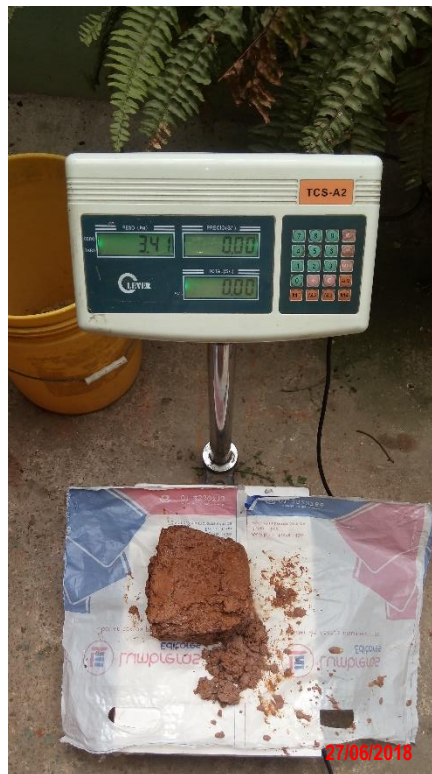
Figura 44 Peso de la “Unidad en Pie” luego del ensayo de absorción.
