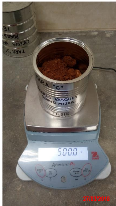
Figura 18 Peso de los 500 gr para el ensayo de granulometría por lavado.
