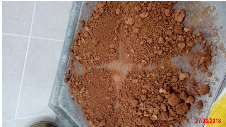
Figura 17 Cuarteo del material para la granulometría por lavado.
