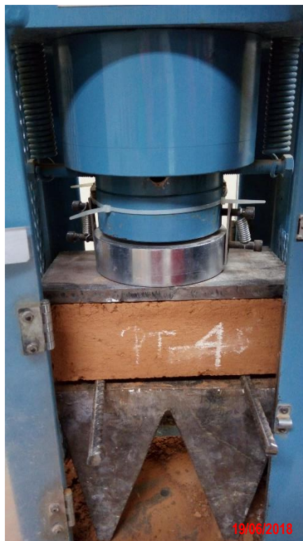
Figura 40 Inicio del ensayo de rotura de tracción por flexión de la unidad de adobe.
