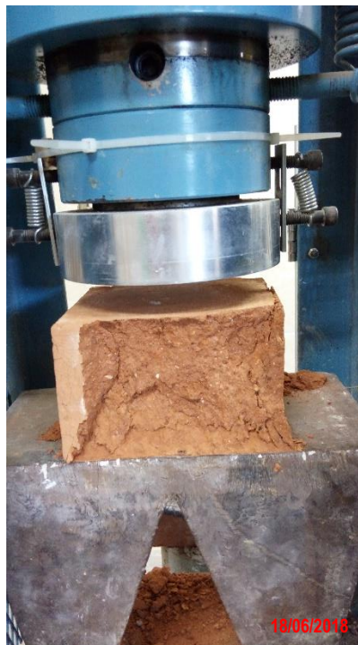
Figura 38 Adobe deteriorado por el ensayo a compresión.
