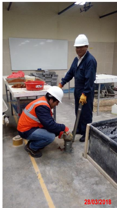
Figura 28 Elaboración del ensayo proctor modificado.
