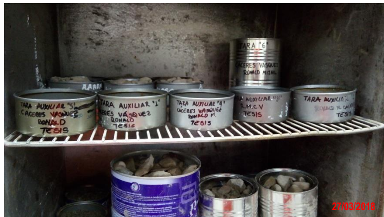
Figura 25 Material de límites de consistencia en el horno para su secado.
