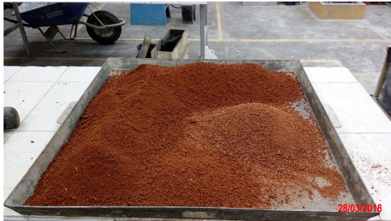
Figura 27 Material tamizado para el ensayo de proctor modificado.
