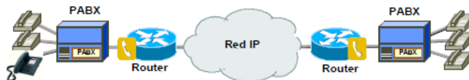
Figura 4: Esquema de funcionamiento de VoIP
