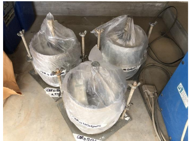
Fotografía N° 20: PROEBTAS DE ENSAYO CON CBCA EN DÍAS DE CURADO.
