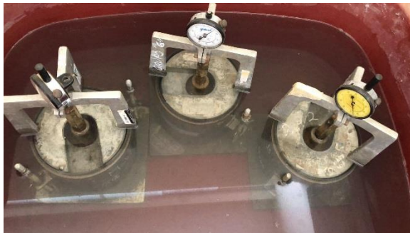
Fotografía N° 19: PROEBTAS DE CBR SUPERGIDAS EN POZA.
