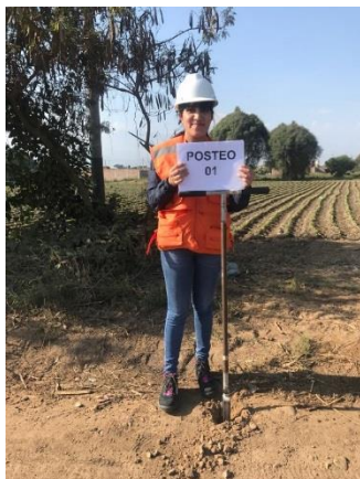
Fotografía N° 05: RELIZACIÓN DE POSTEOS Y OBTENCIÓN DE MUESTRA.
