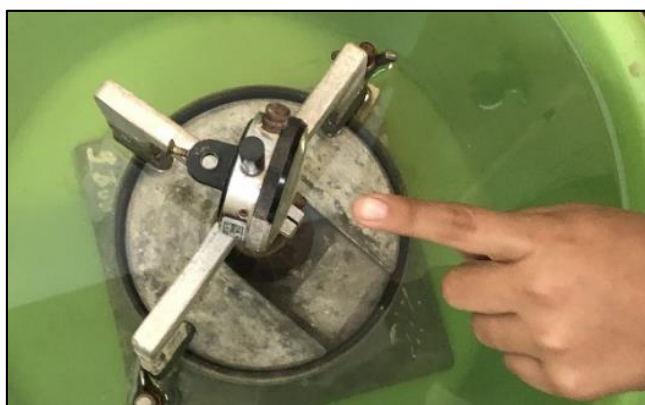
Figura N° 8: Molde de ensayo CBR sumergido y colocación de dial.
