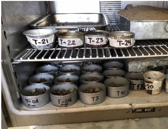
Fotografía N° 07: MUESTRA DE SUELO PARA DETERMINAR CONTENIDO DE HUMEDAD.
