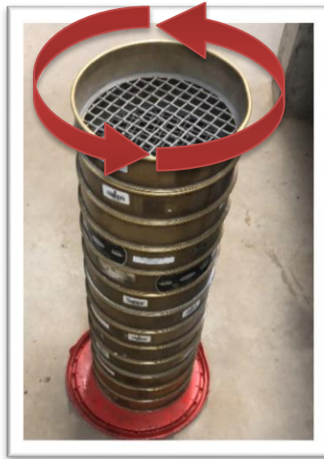
Figura N° 3: Procedimiento para agitar el juego de tamices.
