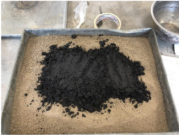
Fotografía N° 15: PREPARACIÓN DE MEZCLA SUELO MÁS CBCA.
