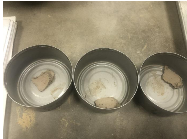
Fotografía N° 12: MUESTRAS DE ENSAYO DE LÍMITE LÍQUIDO.
