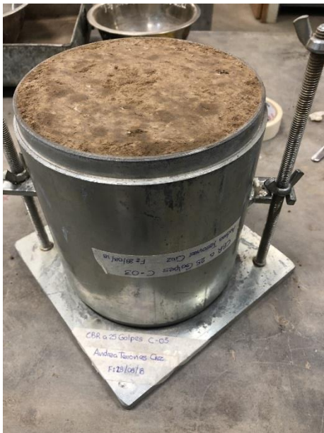
Fotografía N° 17: ELABORACIÓN DE PROBETAS PARA ENSAYO CBR.
