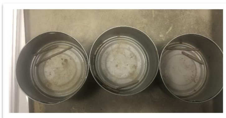
Figura N° 28: Muestras de ensayo de Límite Plástico.
