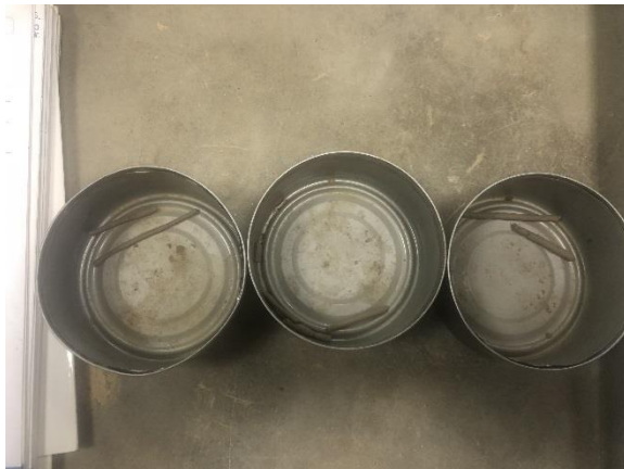
Fotografía N° 13: MUESTRAS DE ENSAYO DE LÍMITE PLÁSTICO.
