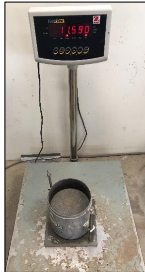
Figura N° 9: Toma de peso de la muestra sumergida incluido el molde
