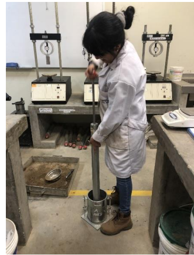
Fotografía N° 16: ELABORACIÓN DE ENSAYO PROCTOR MODIFICADO.
