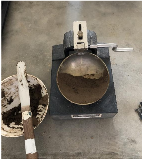
Fotografía N° 11: ELABORACIÓN DE ENSAYO DE LÍMITE LÍQUIDO.
