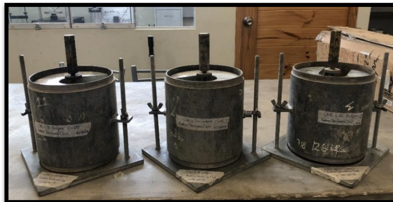
Figura N° 33: Moldes de CBR compactados a 12, 25 y 56 golpes.
