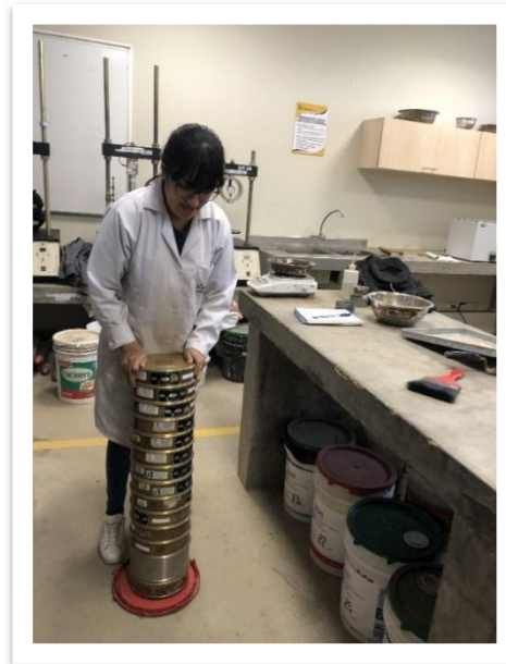
Figura N° 26: Elaboración del ensayo de granulometría por tamizado.
