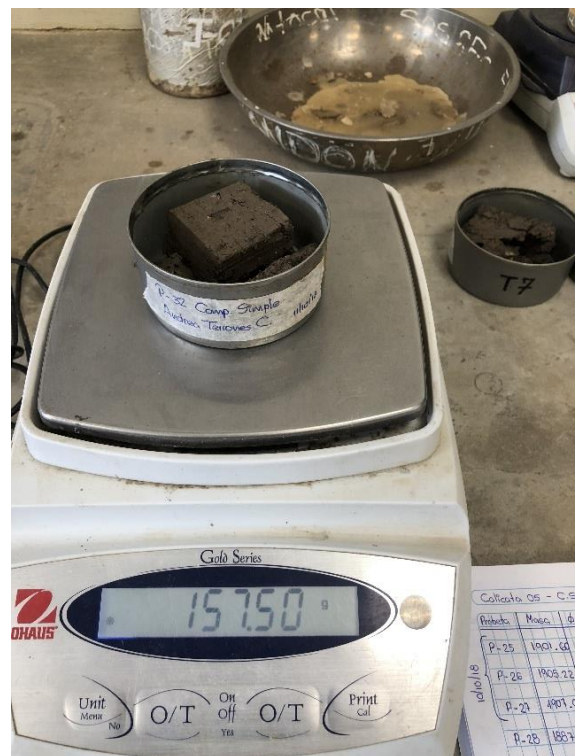
Fotografía N° 23: TOMA DE MUESTRA PARA OBTENCIÓN DE CONTENIDO DE HUMEDAD – COMPRESIÓN SIMPLE NO CONFINADA.
