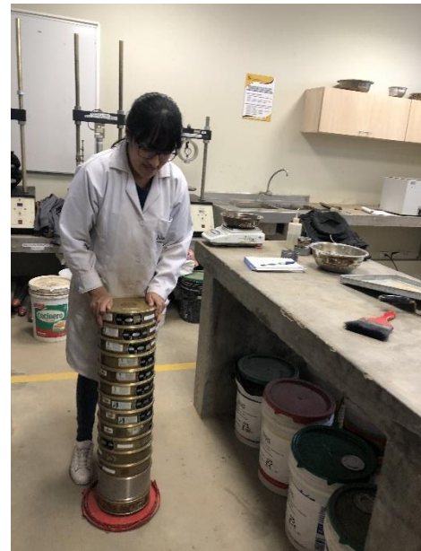
Fotografía N° 10: TAMIZADO DE MUESTRA – ENSAYO DE GRANULOMETRÍA.
