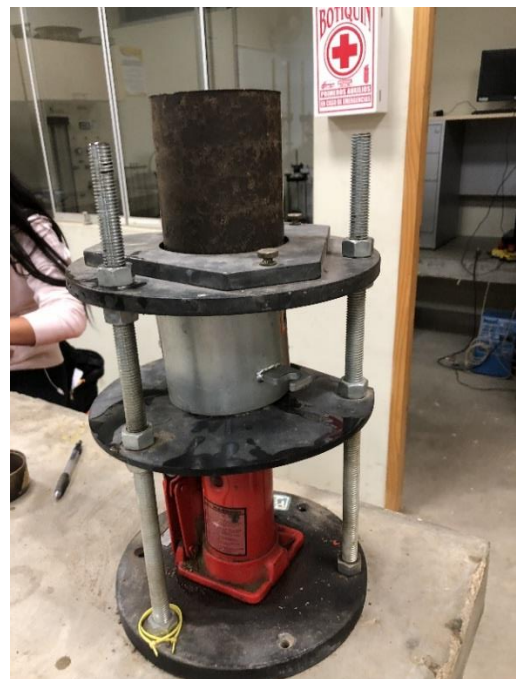
Fotografía N° 22: OBTENCIÓN DE PROBETA PARA ENSAYO DE COMPRESIÓN SIMPLE NO CONFINADA.
