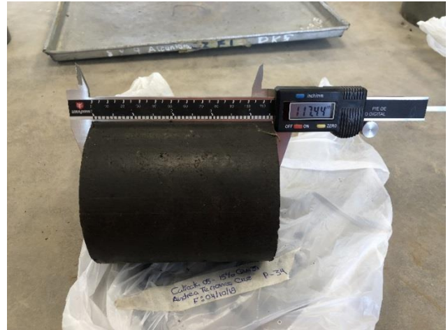
Fotografía N° 24: TOMA DE MEDIDAS A PROBETAS DE ENSAYO DE COMPRESIÓN SIMPLE NO CONFINADA.
