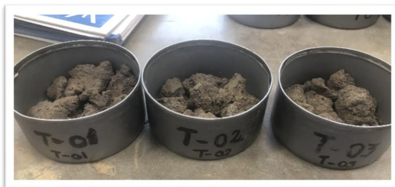
Figura N° 1: Muestras para cálculo de contenido de humedad.
