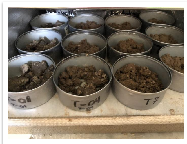
Figura N° 25: Muestras de ensayo de Contenido de Humedad.
