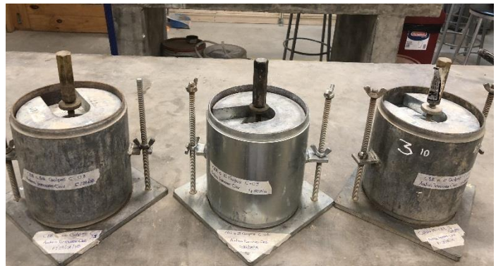
Fotografía N° 18: PROBETAS DE ENSAYO CBR.
