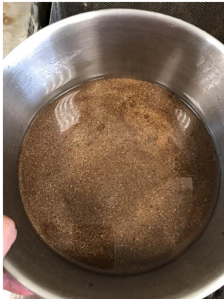
Fotografía N° 09: LAVADO DE MUESTRA PARA ENSAYO DE GRANULOMETRÍA.
