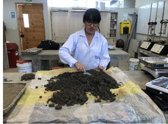
Fotografía N° 08: CUARTEO DE MUESTRA PARA ENSAYO DE GRANULOMETRÍA.
