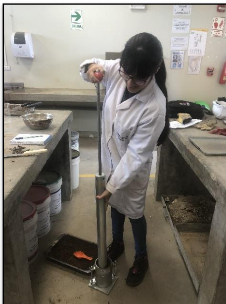
Figura N° 31: Elaboración de ensayo de Proctor Modificado
