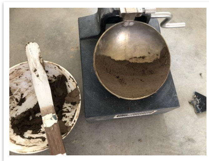
Figura N° 27: Elaboración de ensayo de Límite Líquido.
