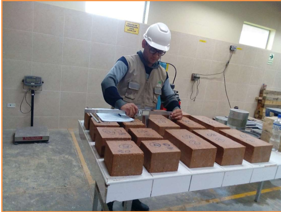
Fotografía 38: Medición de los adobes.
