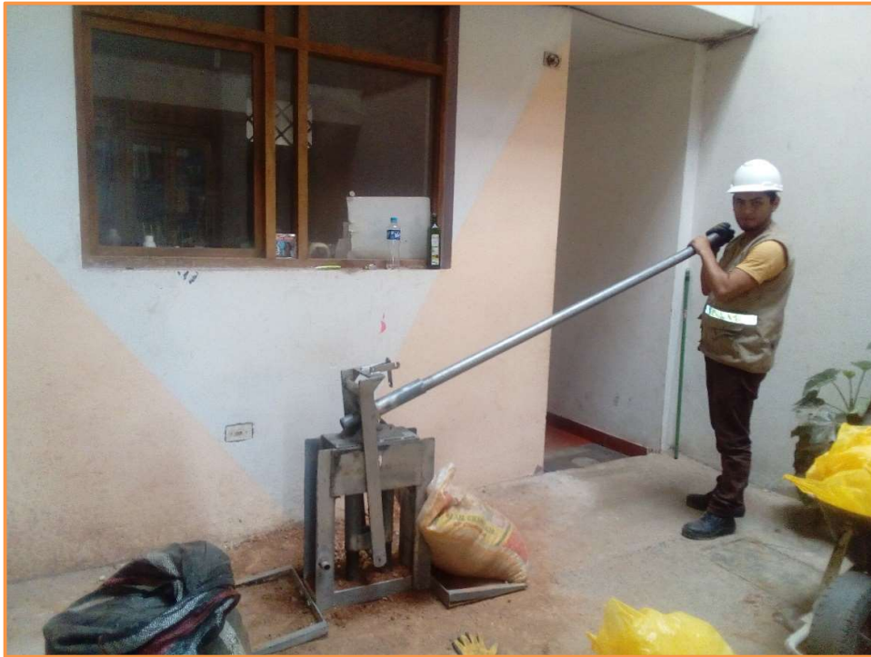
Fotografía 34: Elaboración de adobes.
