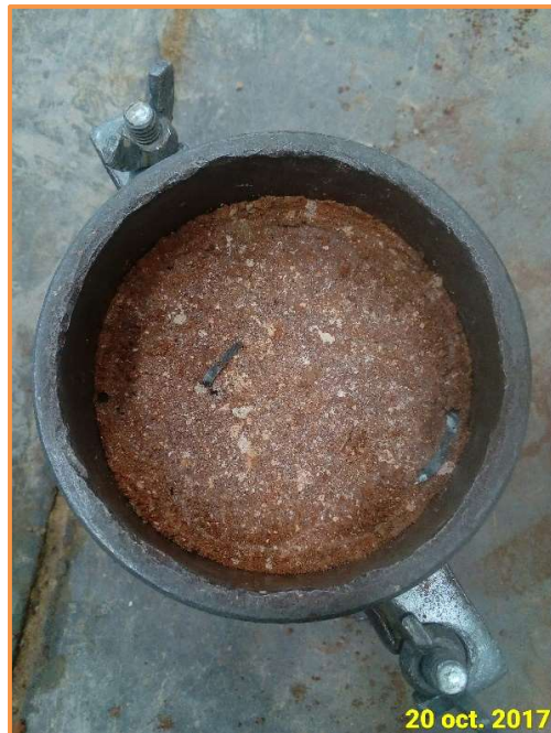
Fotografía N°17: Muestra con adición de viruta metálica obtenida del ensayo proctor modificado.
