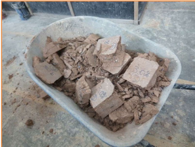
Fotografía 43: Adobe ensayados a compresión y flexión.
