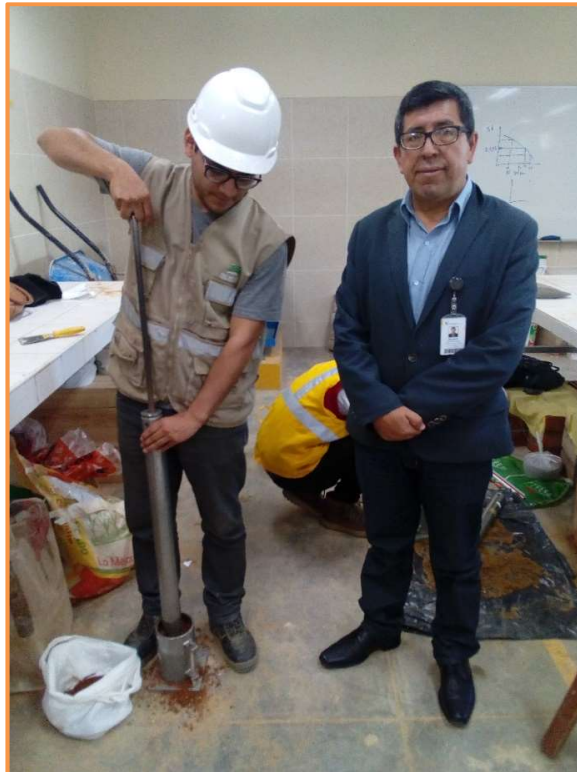
Fotografía 31: Realización del ensayo proctor modificado, con supervisión del asesor.
