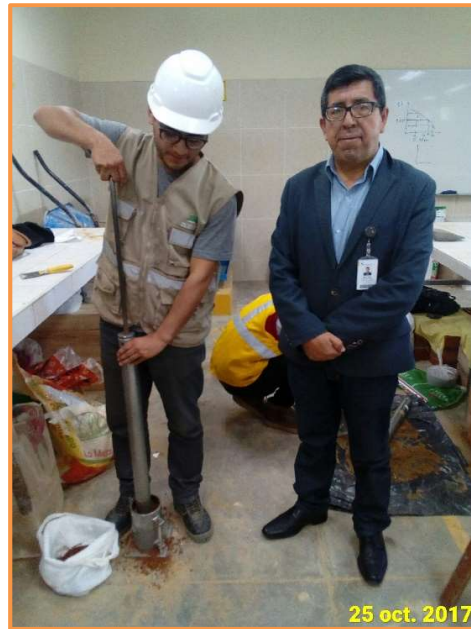
Fotografía N°17: Muestra con adición de viruta metálica obtenida del ensayo proctor modificado.
