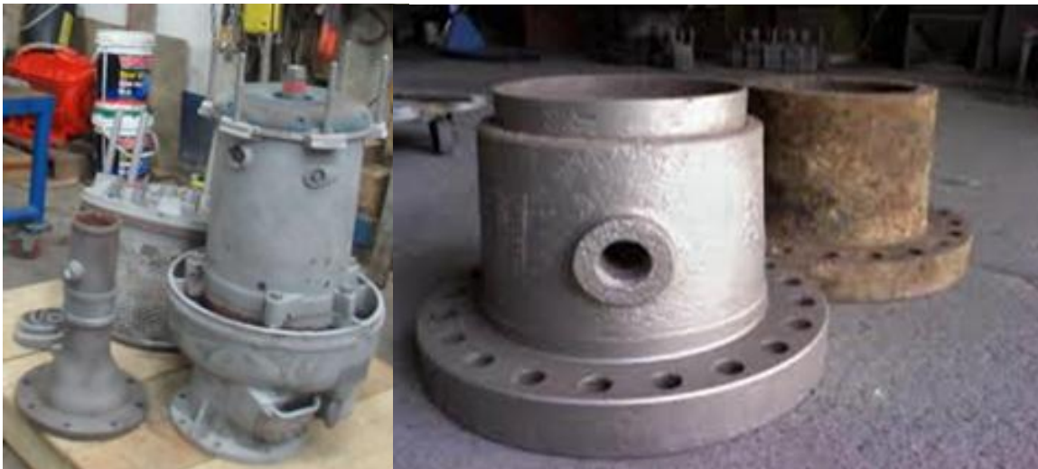
Figura n.º 3.14. pieza arenada y sin arenar
