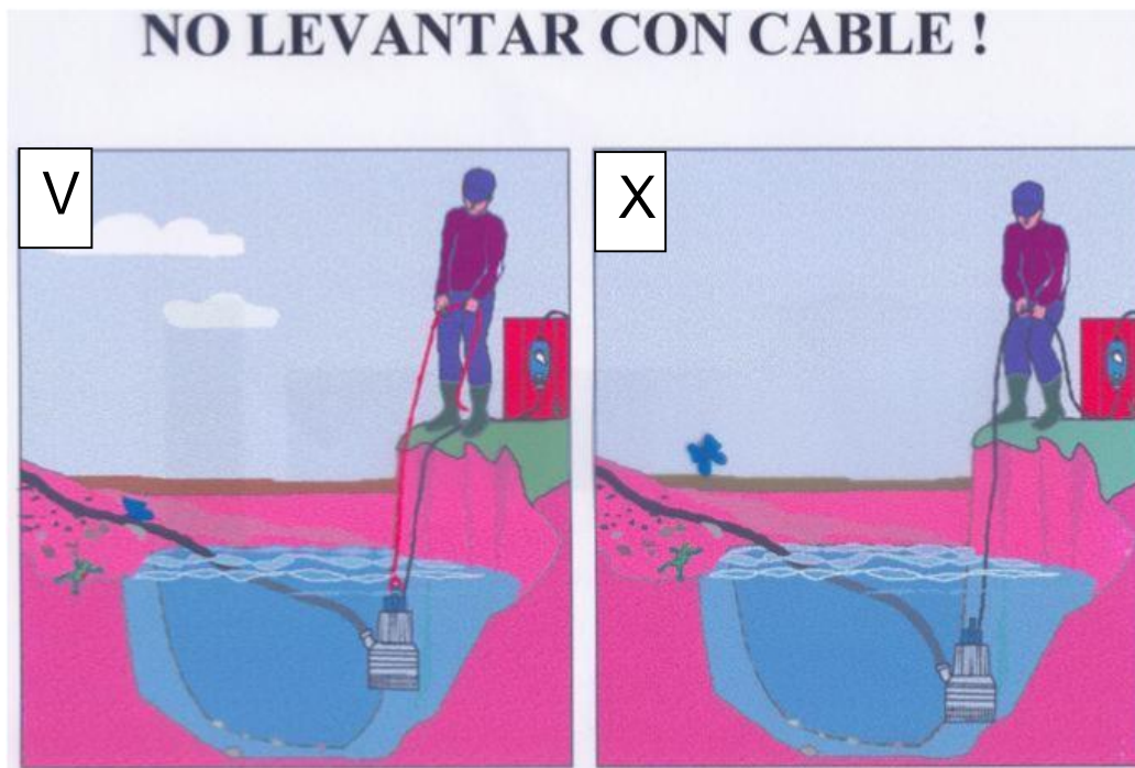
Figura n.º 2.9 como manipular las bombas
