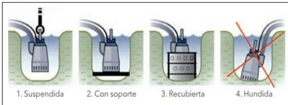
Figura n.º 2.8 operación correcta
