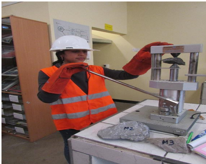
Figura 9: ensayo de la carga puntual de la muestra 2
