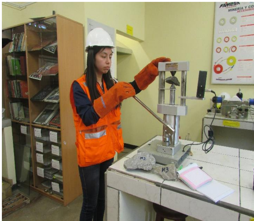
Figura 8: ensayo de la carga puntual de la muestra 1
