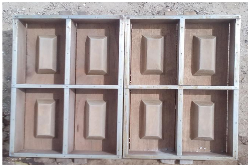
Figura N° 5. Gabera utilizada para la fabricación de los ladrillos.
