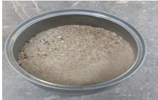
Figura N° 30. Material (arcilla) para realizar ensayo de granulometría.
