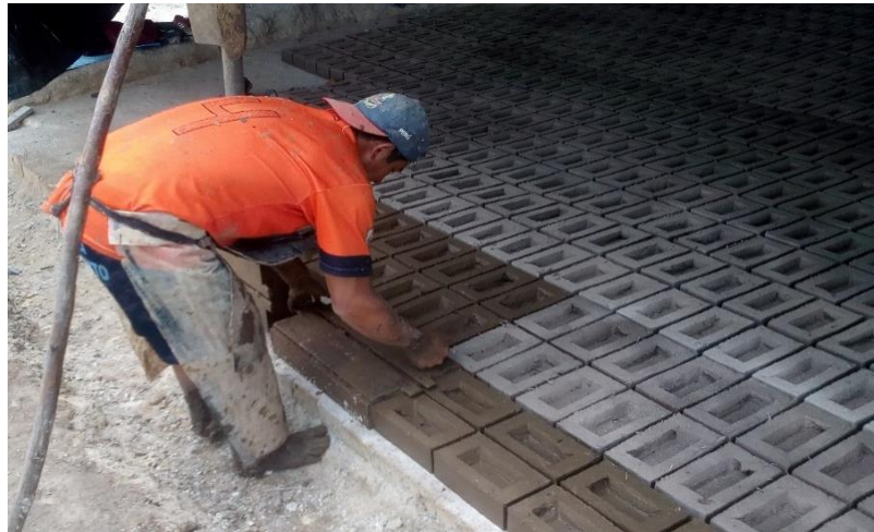
Figura N° 16. Vaciado y puesto al secado de ladrillos.
