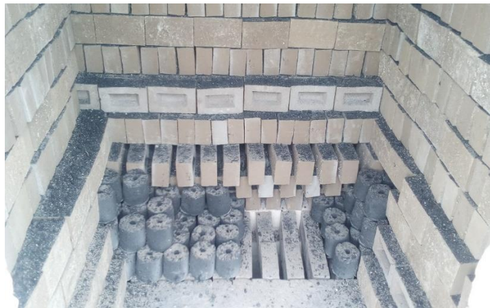
Figura N° 9. Cargado del horno con ladrillo para el quemado.
