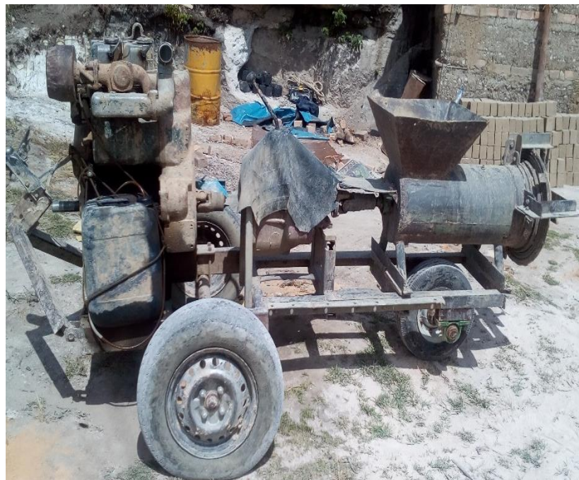
Figura N° 6. Maquina moledora del crudo.
