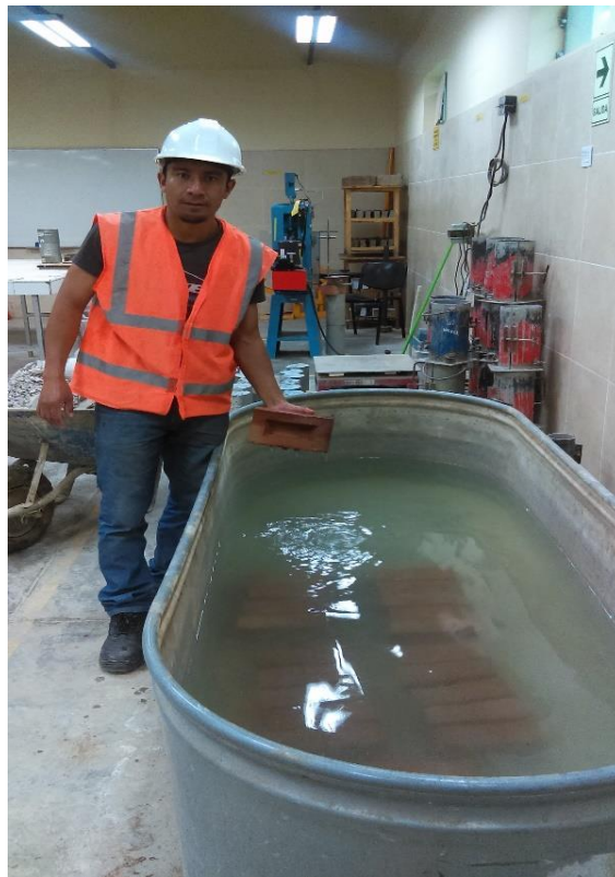
Figura N° 41. Ladrillos sumergidos en agua para ensayo de absorción.
