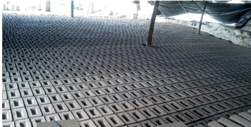
Figura N° 8. Secado de los ladrillos.
