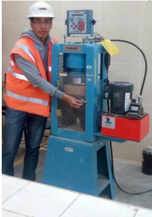
Figura N° 42. Realizando ensayo de resistencia a la compresión.
