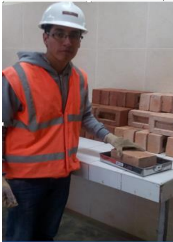
Figura N° 40. Realizando ensayo de succión.
