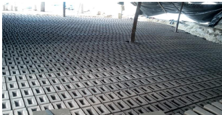
Figura N° 33. Secado de los ladrillos.
