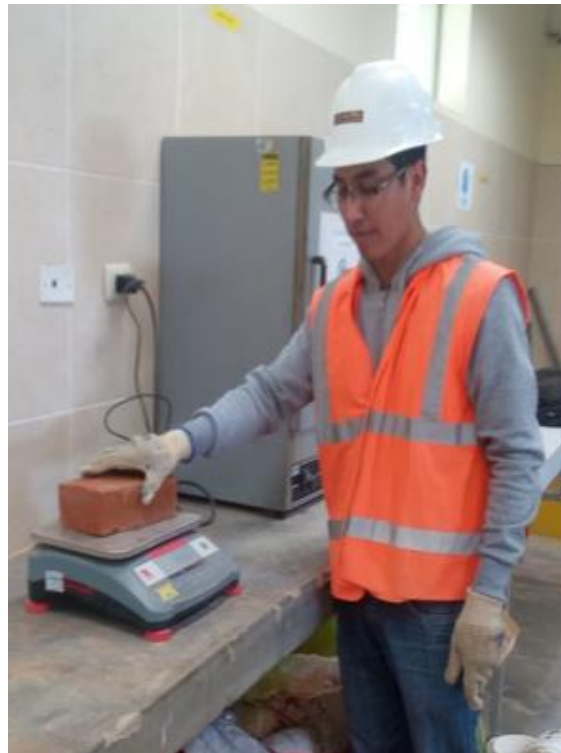
Figura N° 39. Pesando los ladrillos para ensayo de absorción.
