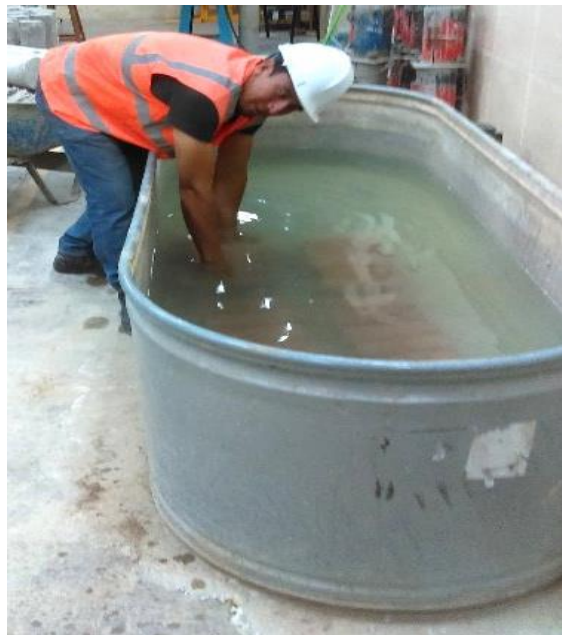
Figura N° 20. Ladrillos sumergidos en agua por 24 horas.
