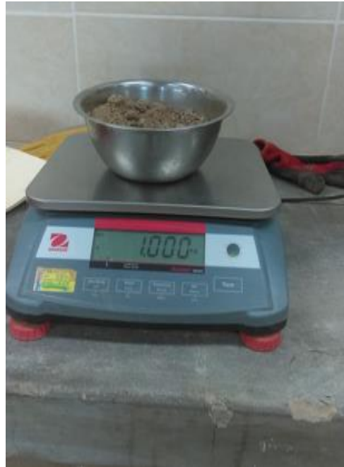
Figura N° 27. Pesando la muestra (arcilla), para ensayo de contenido de humedad.
