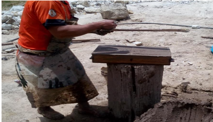
Figura N° 15. Moldeado de los ladrillos.
