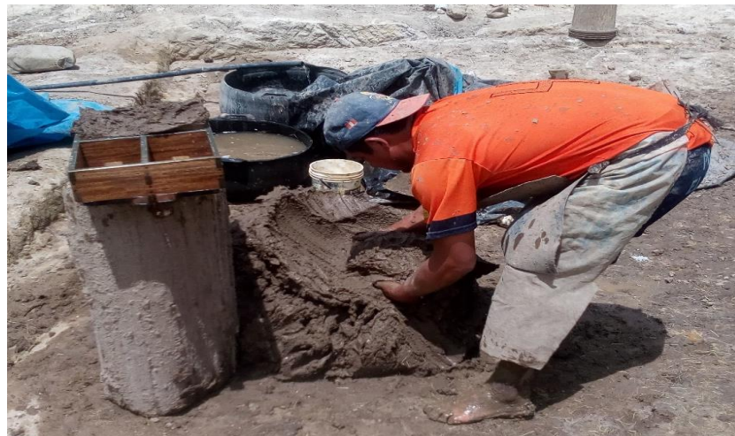
Figura N° 7. Moldeado de los ladrillos.
