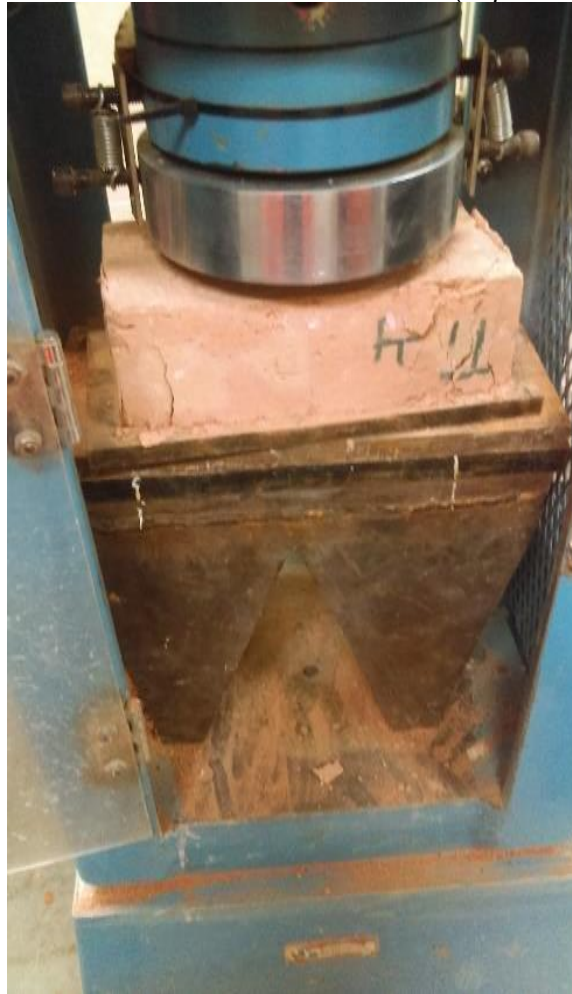
Figura N° 22. Ruptura de ladrillos de arcilla.
