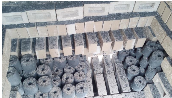
Figura N° 34. Ubicaciones los ladrillos en el horno.
