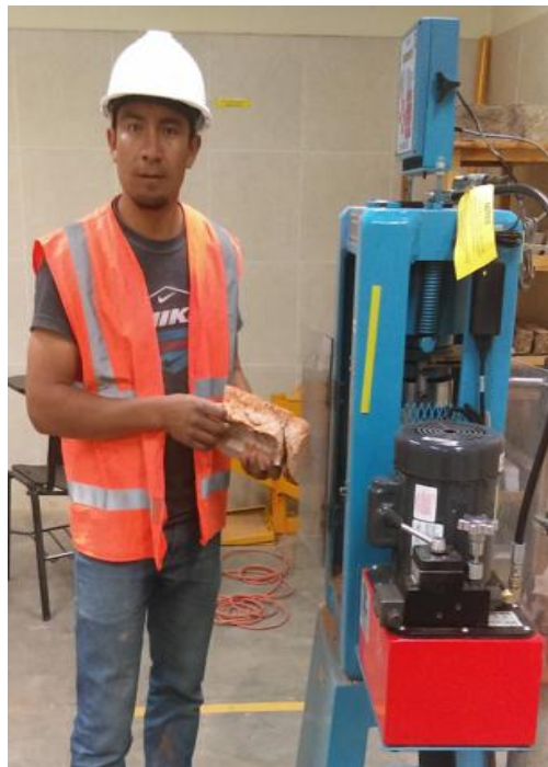
Figura N° 43. Ladrillos sometidos a compresión.
