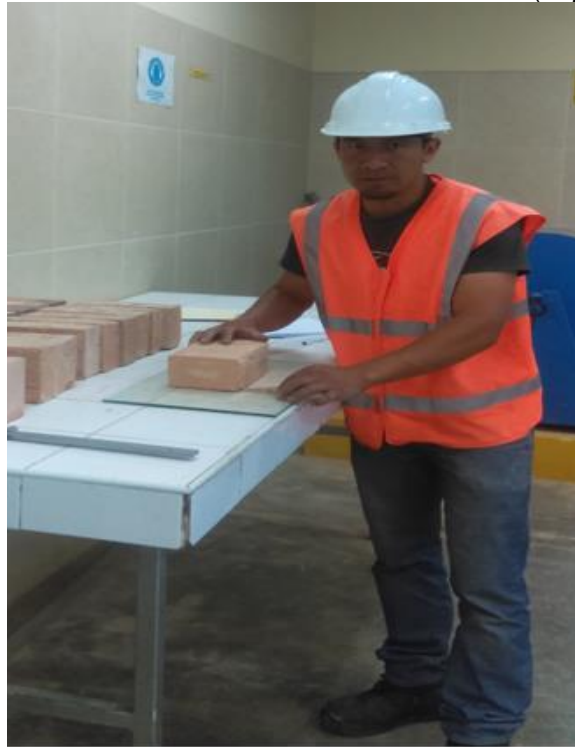
Figura N° 38. Realizando ensayo de alabeo.
