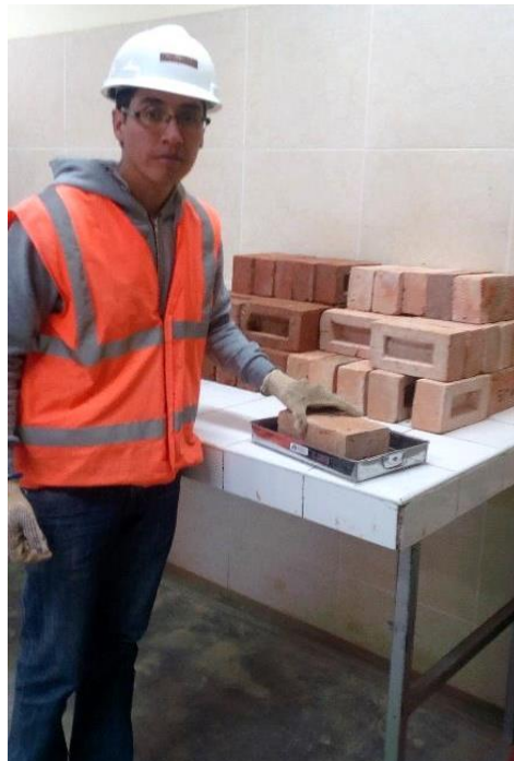
Figura N° 21. Ensayo de succión de los ladrillos.
