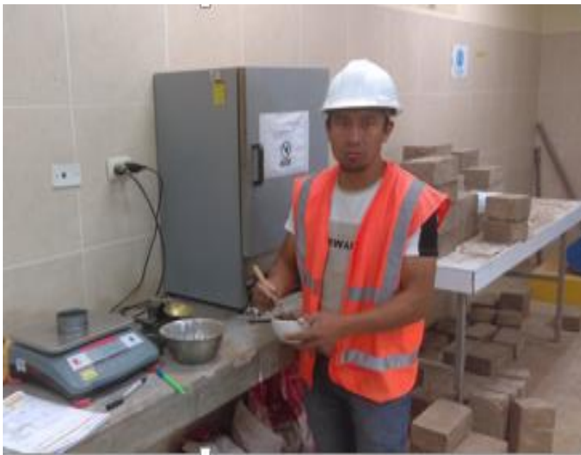
Figura N° 28. Realizando ensayo de límite líquido.
