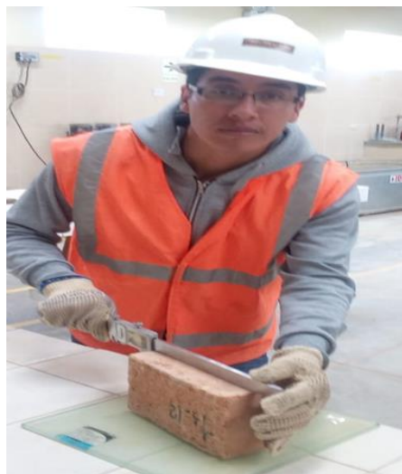
Figura N° 37. Realizando ensayo de variación dimensional.
