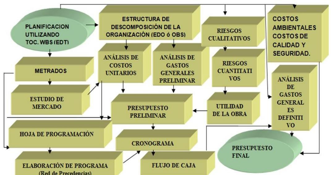
Figura N° 4 Modelo Dinámico para generar presupuesto y el programa de obra
