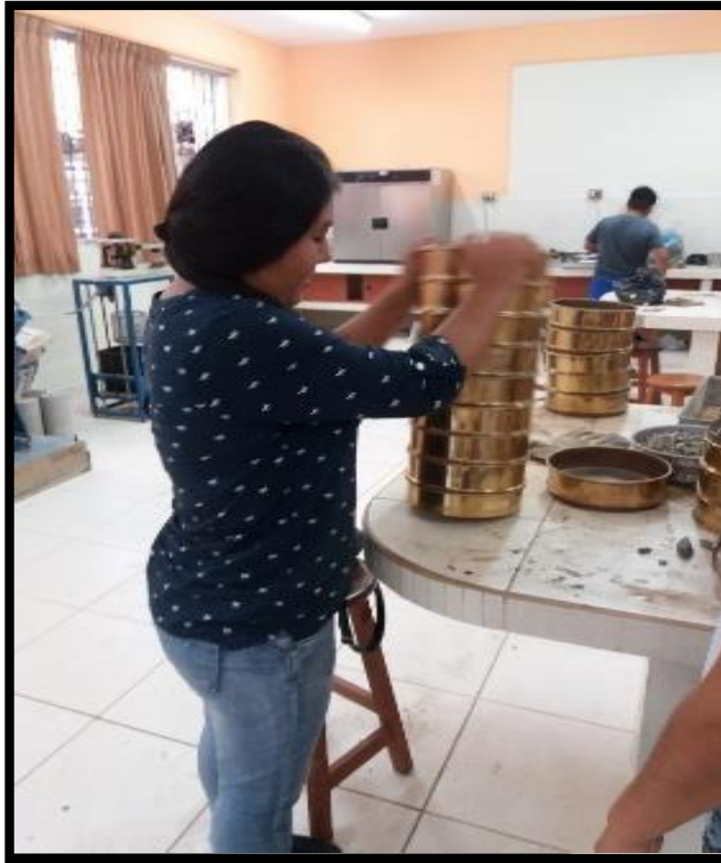
Figura Nª 05 Ilustración del tamizado de los agregados
