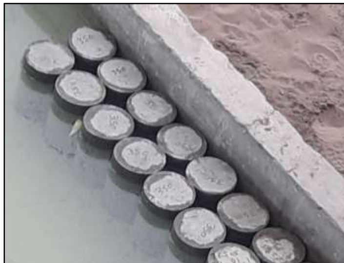
Figura Nº 8. Probetas de concreto ensayadas a los 28 días
