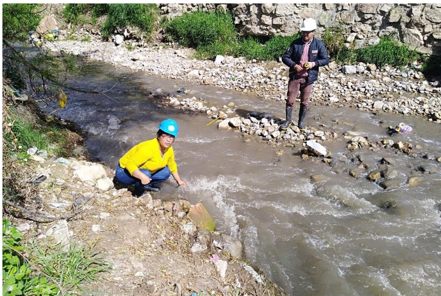
Figura XXV. Medida del ancho del cauce del río Saucicucho antes del contacto con el efluente. Fotografía tomada en el 2018.
