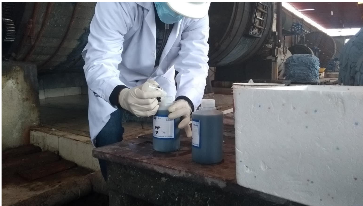
Figura 20. Toma de muestra de caja de registro y adición de preservante
