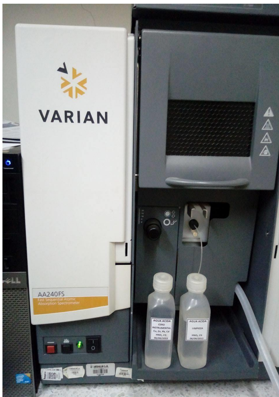
Figura 23. Espectrofotómetro de Absorción Atómica utilizado para los análisis de Concentración de Cromo.
