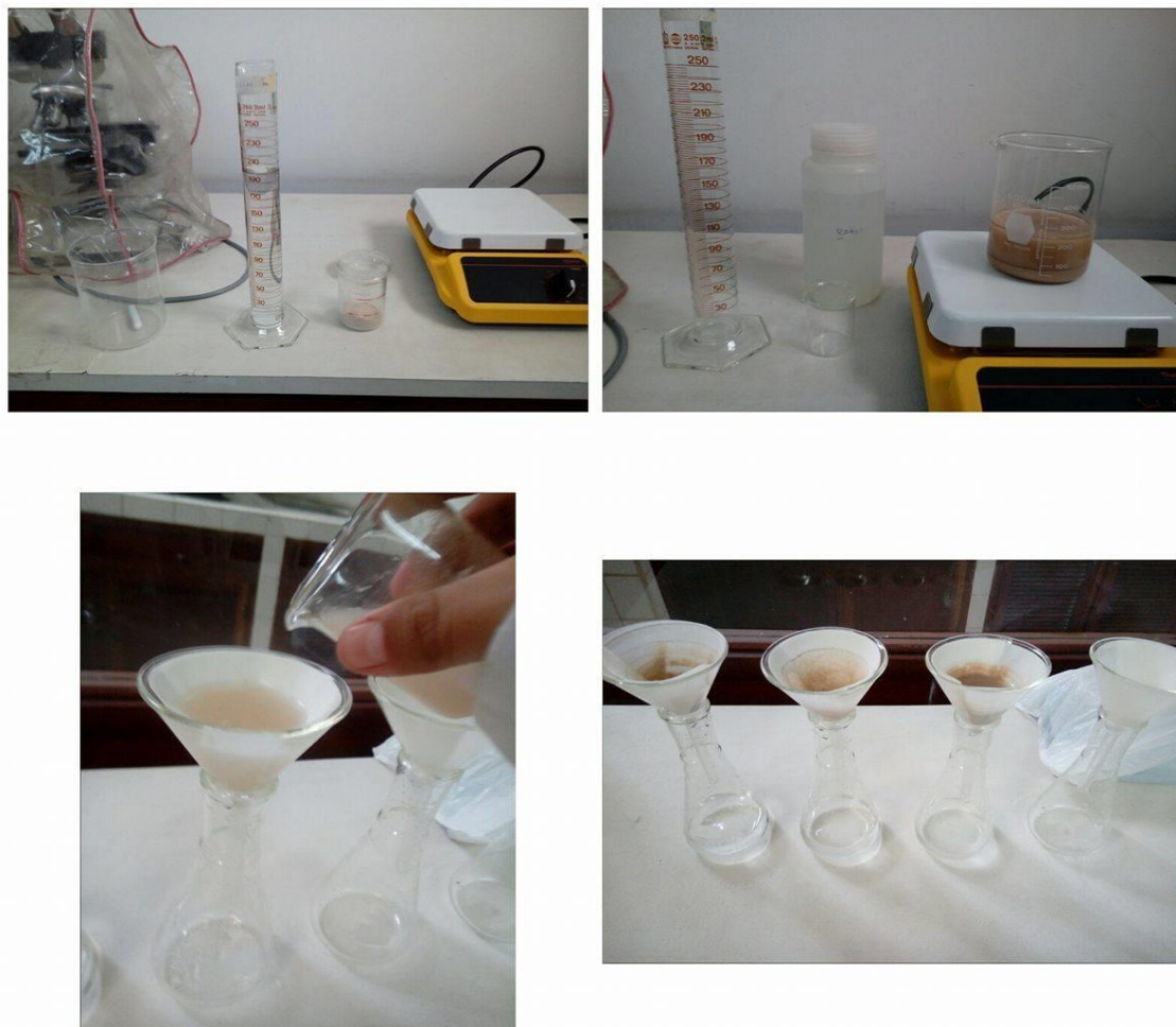
Figura 18. Experimentación con Zeolita Natural para la adsorción de Cromo Total
