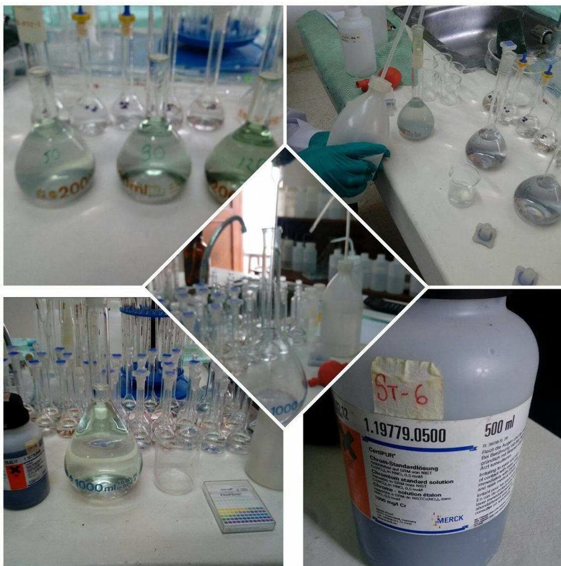
Figura 16. Preparación de muestra patrón de Cromo Total en diferentes concentraciones.
