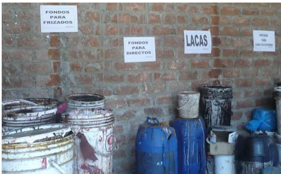
Figura 30. Químicos sin etiquetado
