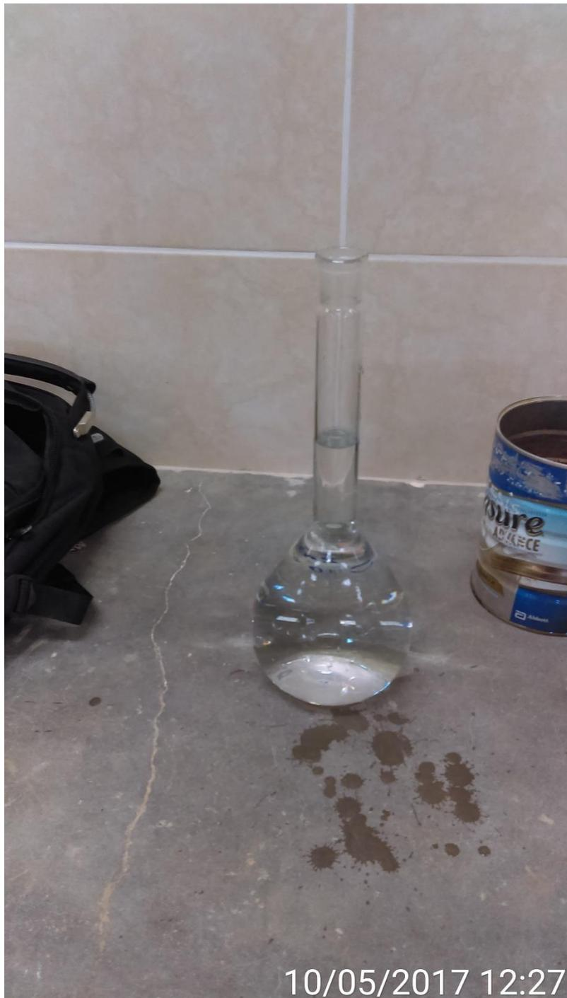
Fotografía 18. Peso de Fiola Con Agua para ensayo de Peso Específico del Agregado Fino.
