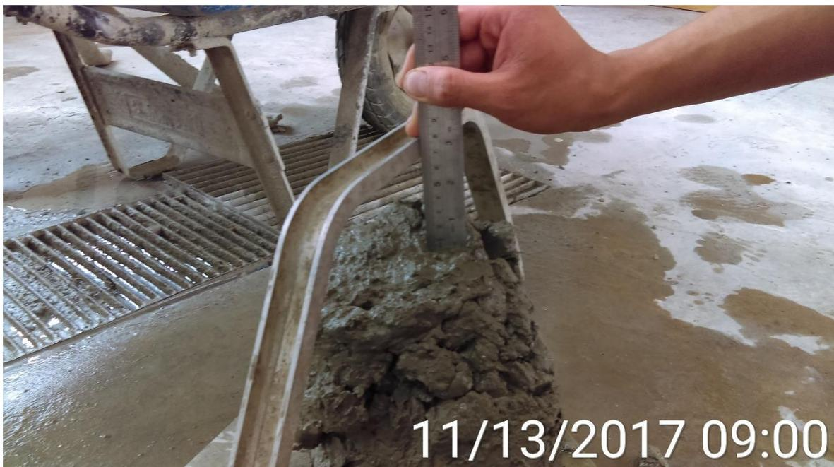
Fotografía 29. Perfilado de Probetas.
