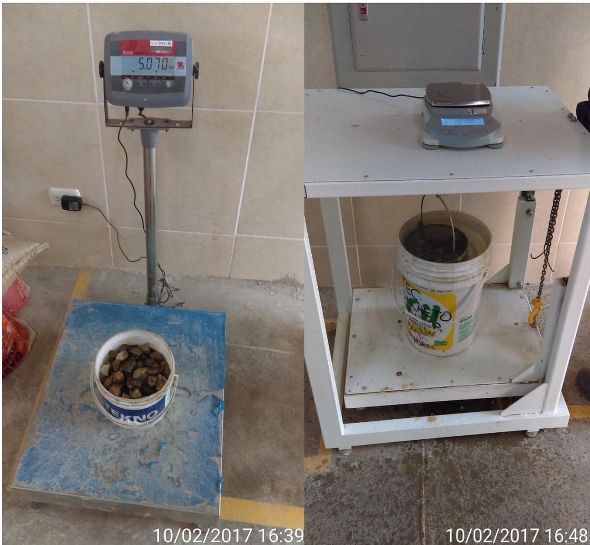
Fotografía 11. Ensayos para determinar el Peso Unitario Suelto del Agregado Grueso.
