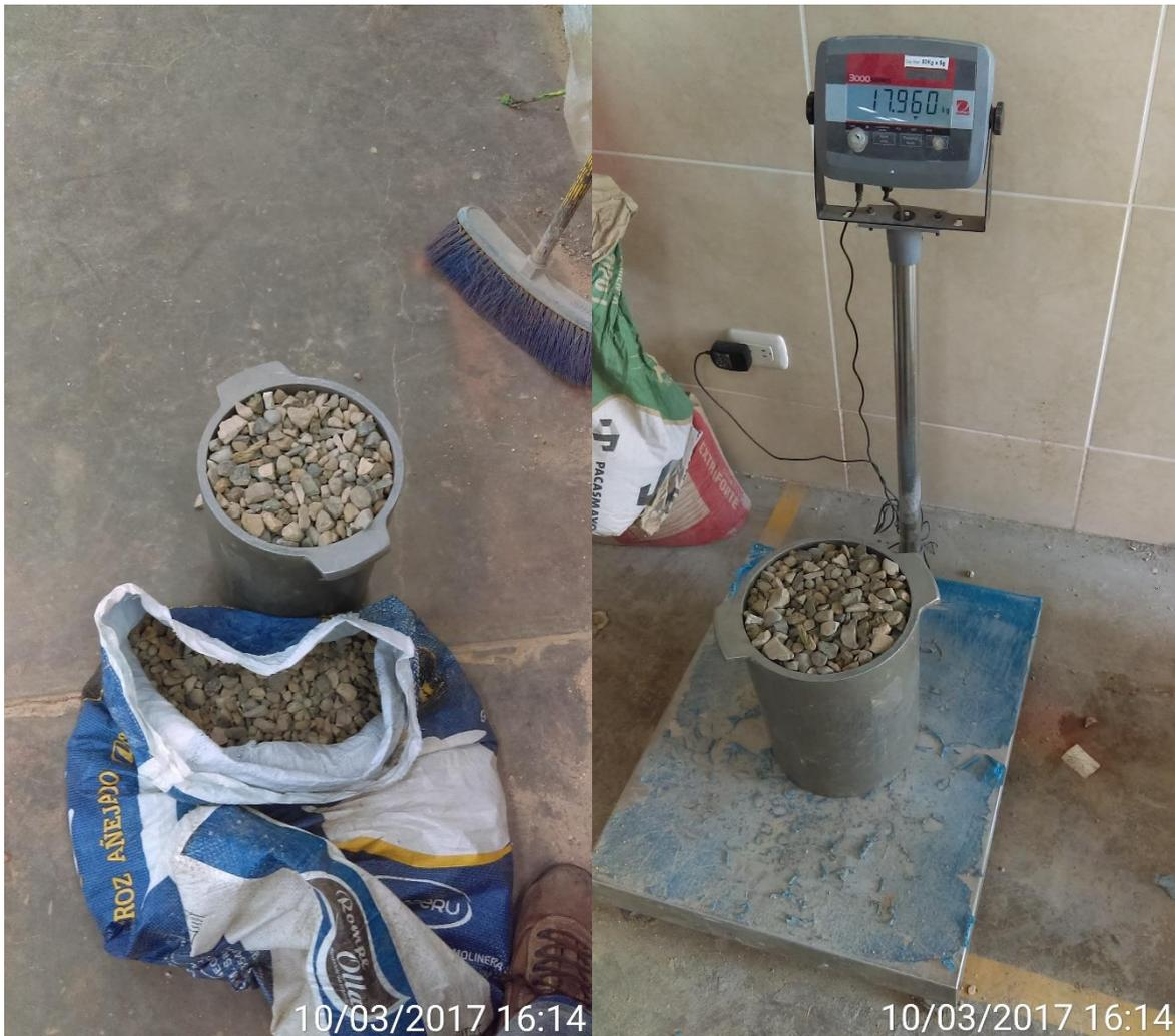
Fotografía 12. Ensayos para Peso Unitario Compactado del Agregado Grueso.
