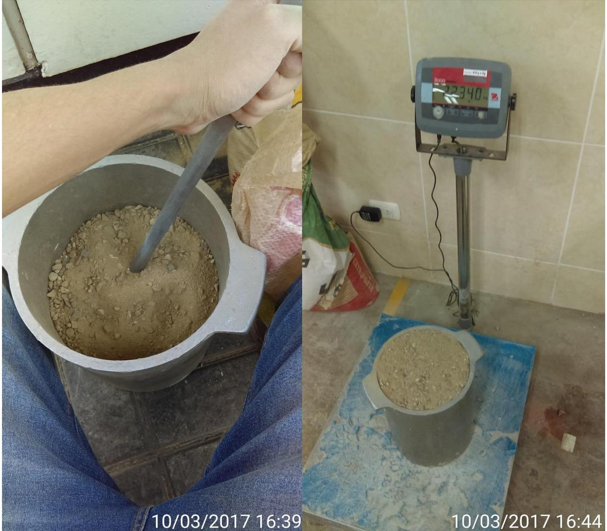
Fotografía 15. Secado del Material para Ensayo de Peso Específico del Agregado Fino.
