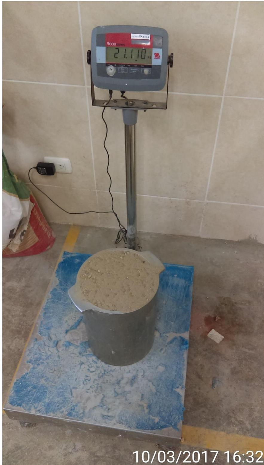
Fotografía 14. Ensayos para Peso Unitario Compactado del Agregado Fino.
