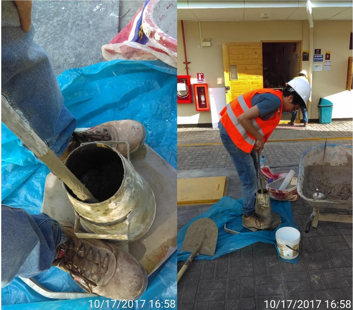
Fotografía 24. Elaboración de Probetas de Concreto.
