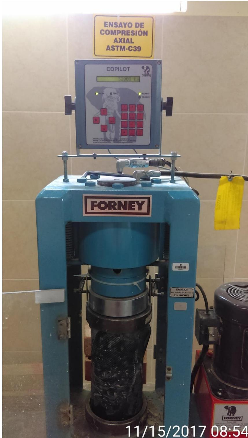
Fotografía 32. Probeta de Concreto sin recubrimiento, sometida al ensayo de compresión axial.
