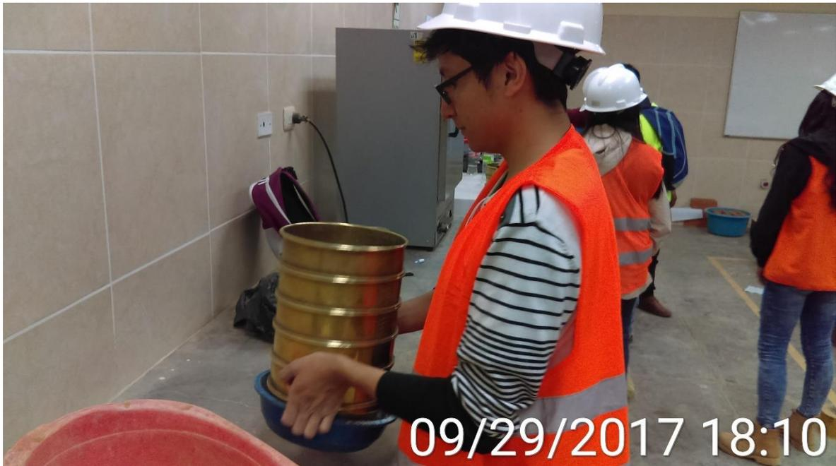
Fotografía 8. Granulometría del Agregado Fino.
