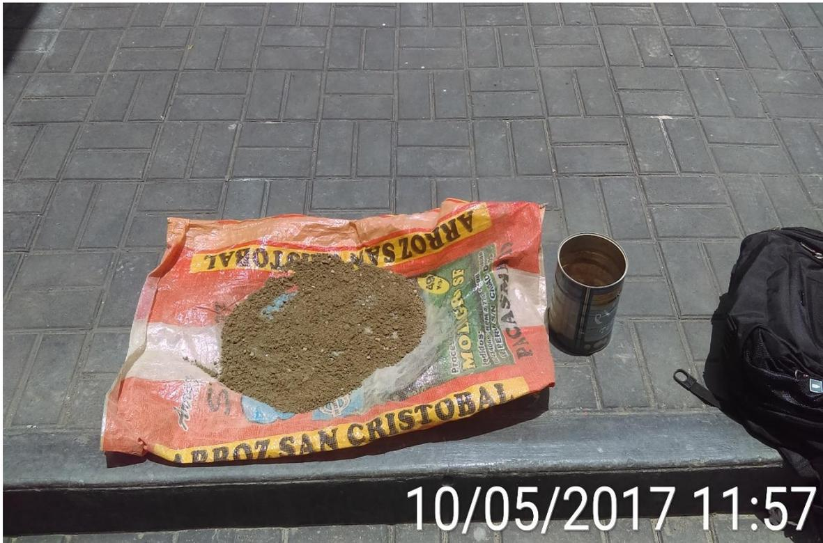
Fotografía 16. Ensayo con el Molde Cónico para ver si existe humedad en el Material.
