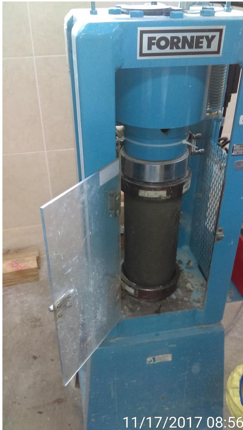
Fotografía 36. Toma de Datos durante la ruptura de Probetas.
