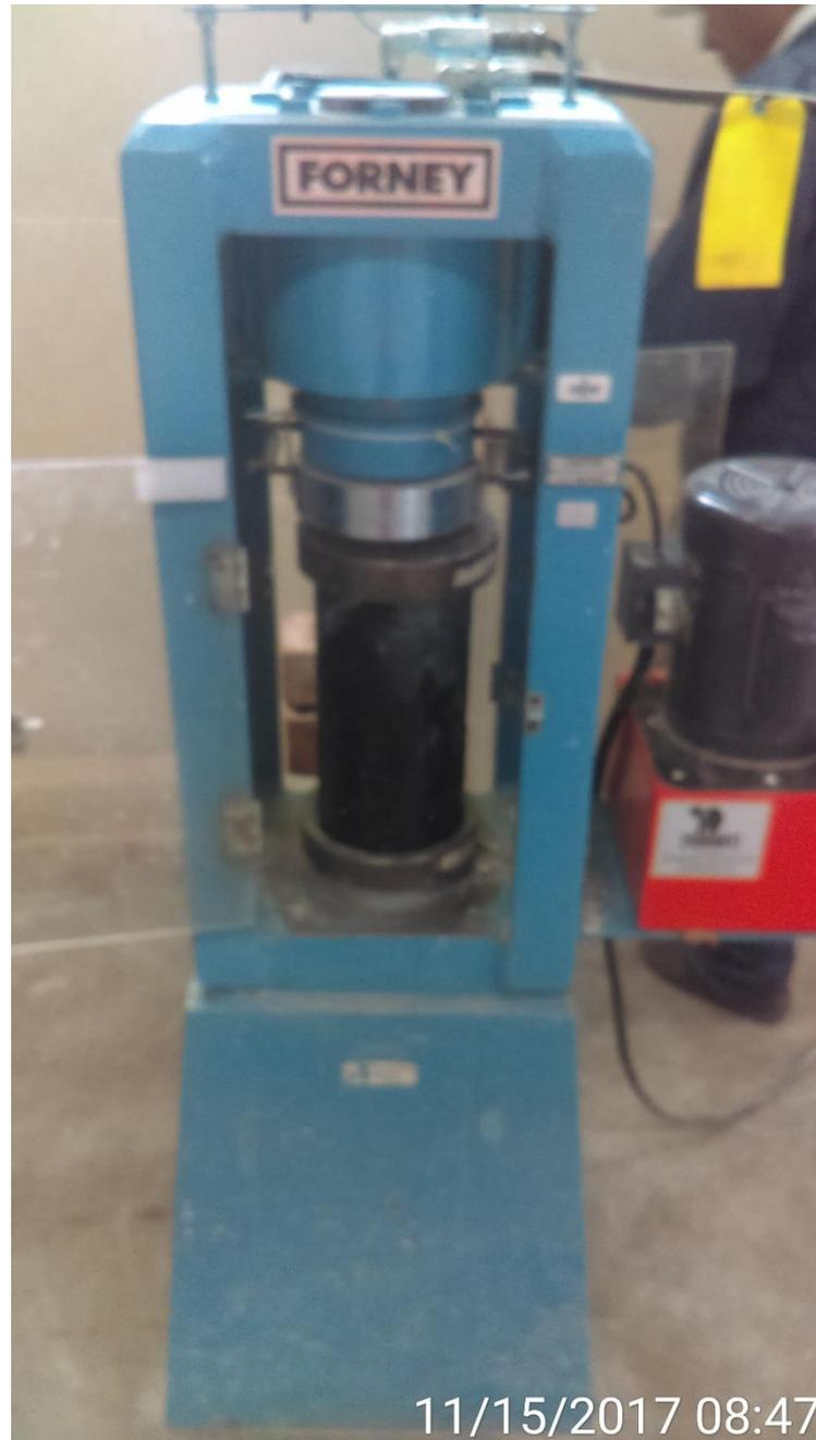
Fotografía 31. Probeta de Concreto con recubrimiento de fibra de carbono, durante el ensayo.
