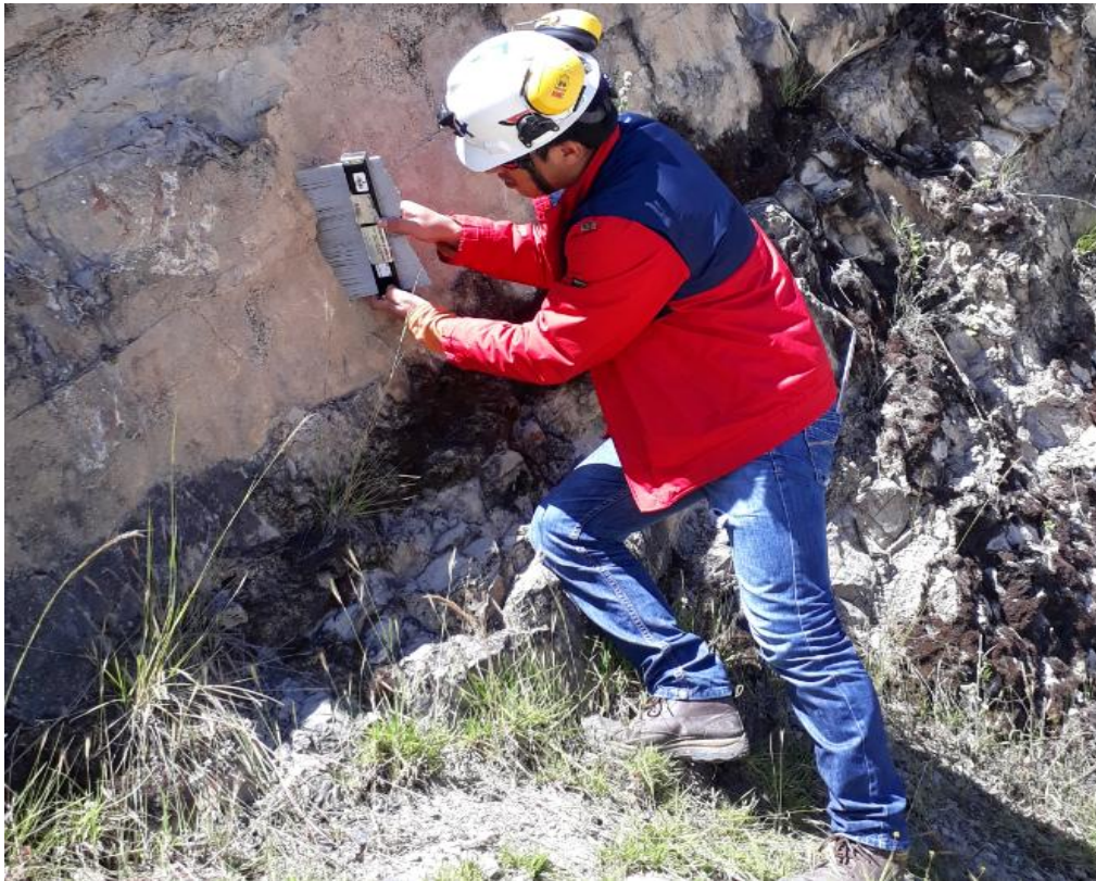
Foto 10. Muestra de rugosidad con el peine de BARTON sobre la discontinuidad del macizo rocoso.
