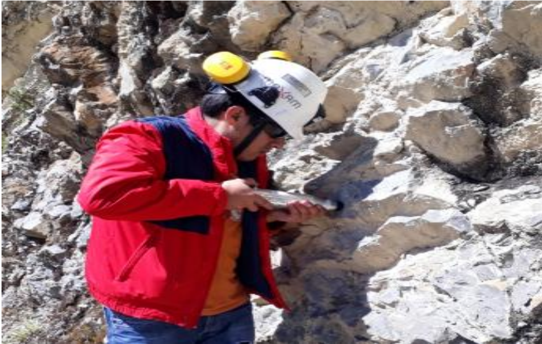
Foto 8. Muestra del Nreb con el martillo SCHMIDT en sentido horizontal.
