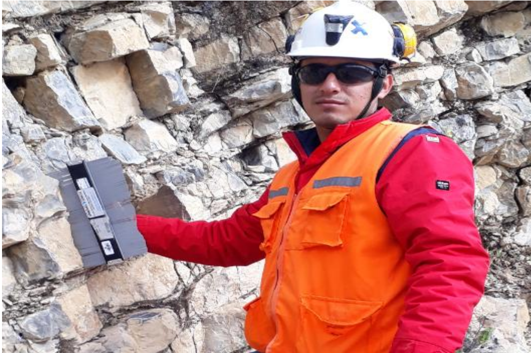
Foto 11. Medición de rugosidad con el peine de BARTON
