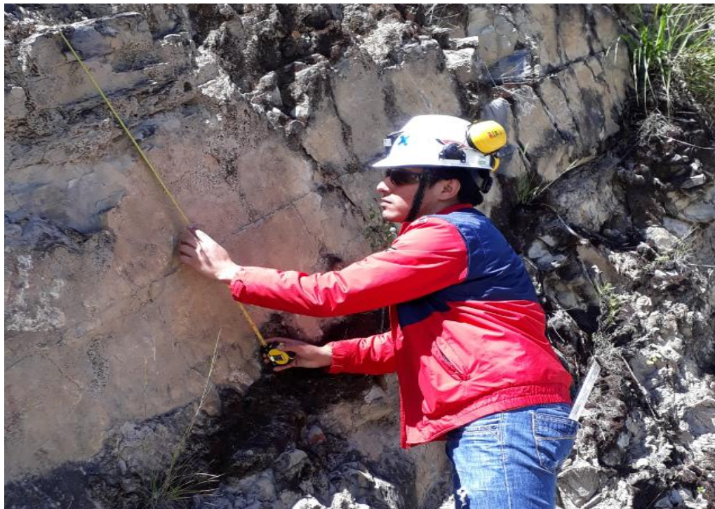
Foto 6. Toma de discontinuidades por metro lineal
