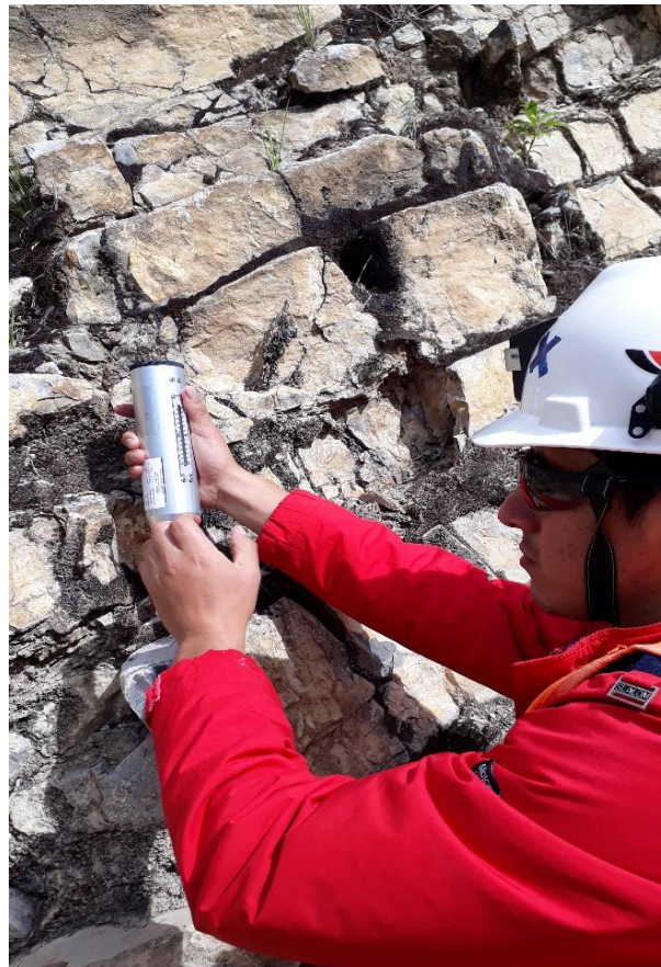
Foto 7. Muestra del Nreb con el martillo SCHMIDT en sentido perpendicular.
