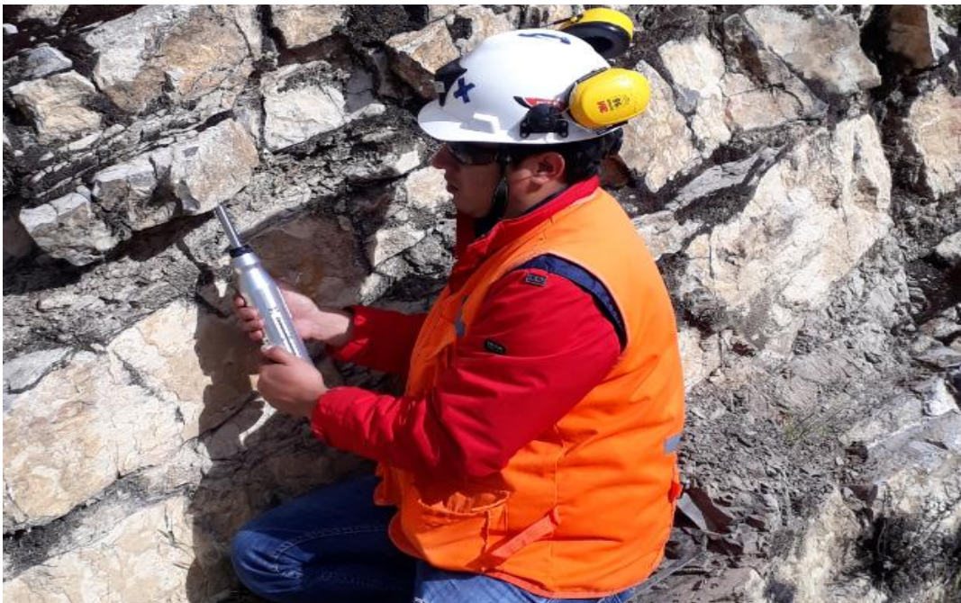
Foto 9. Muestra del Nreb con el martillo SCHMIDT en sentido vertical.
