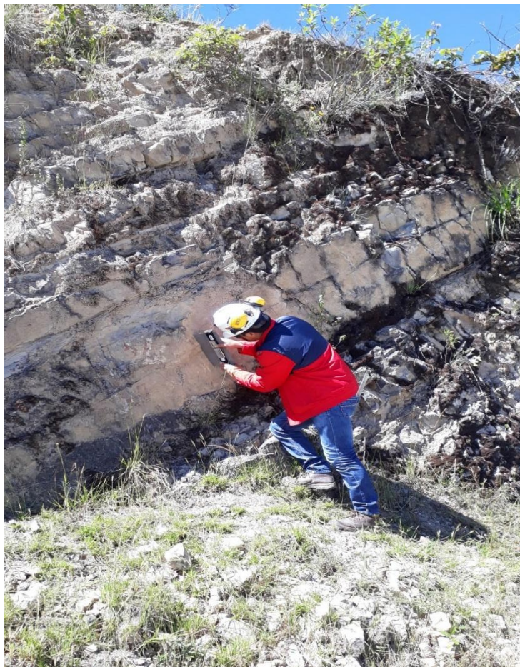
Foto 12. Muestra de PRug con el peine de BARTON en el punto de muestreo N°10.
