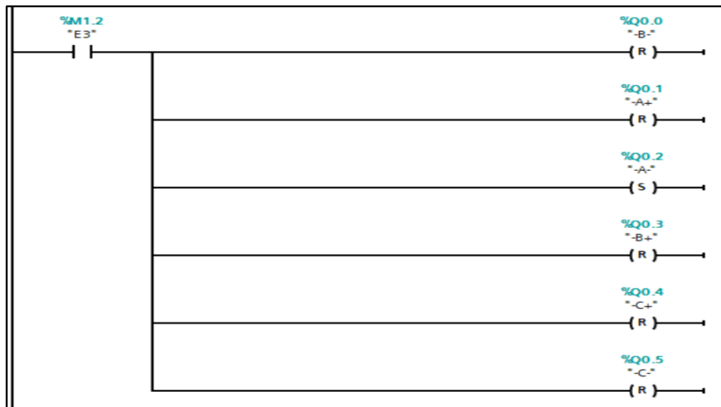
Figura 24: Etapa tres - salidas del PLC
