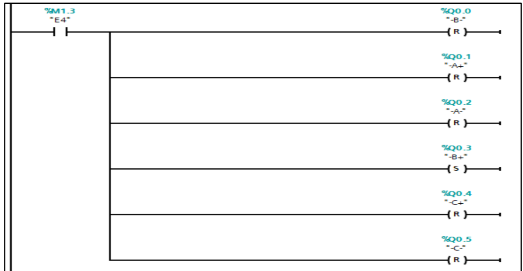
Figura 25: Etapa cuatro - salidas del PLC
