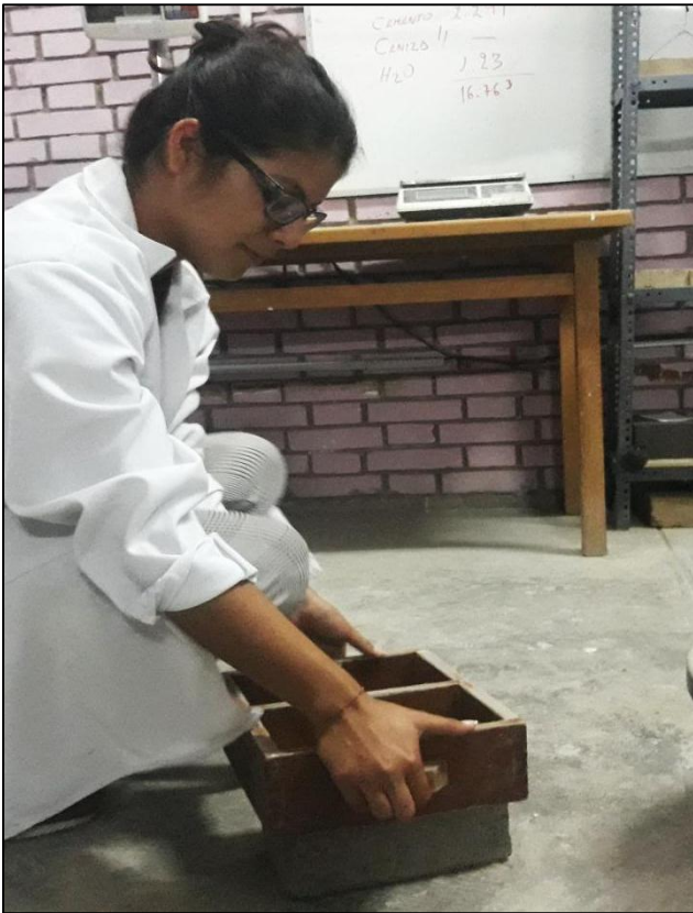
Figura 48. Desmolde de adobe. Taller de Ingeniería materiales - UNT
