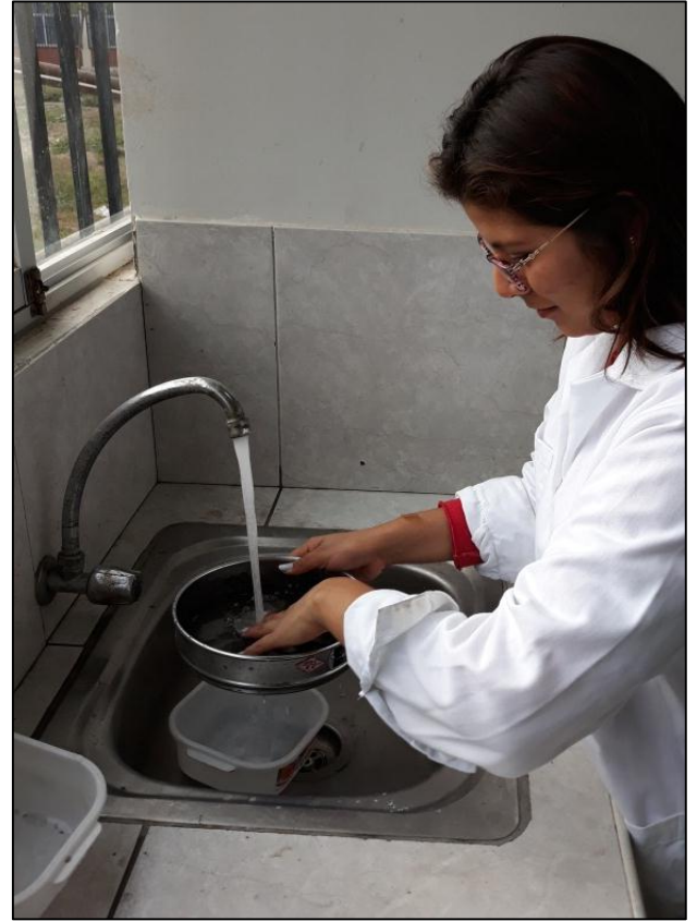
Figura 36. Lavado de ceniza de la caña de azúcar. Laboratorio de concreto reciclado - UNT
