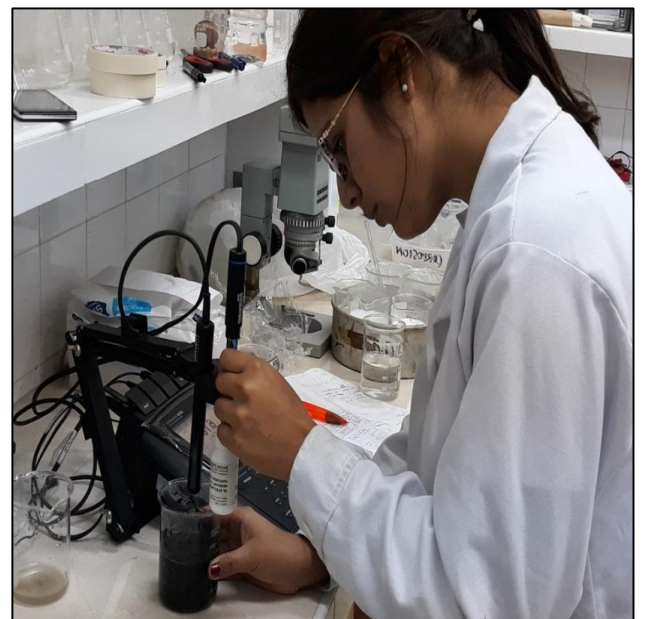
Figura 45. Ensayo de Conductividad de la ceniza. Laboratorio de química - UNT
