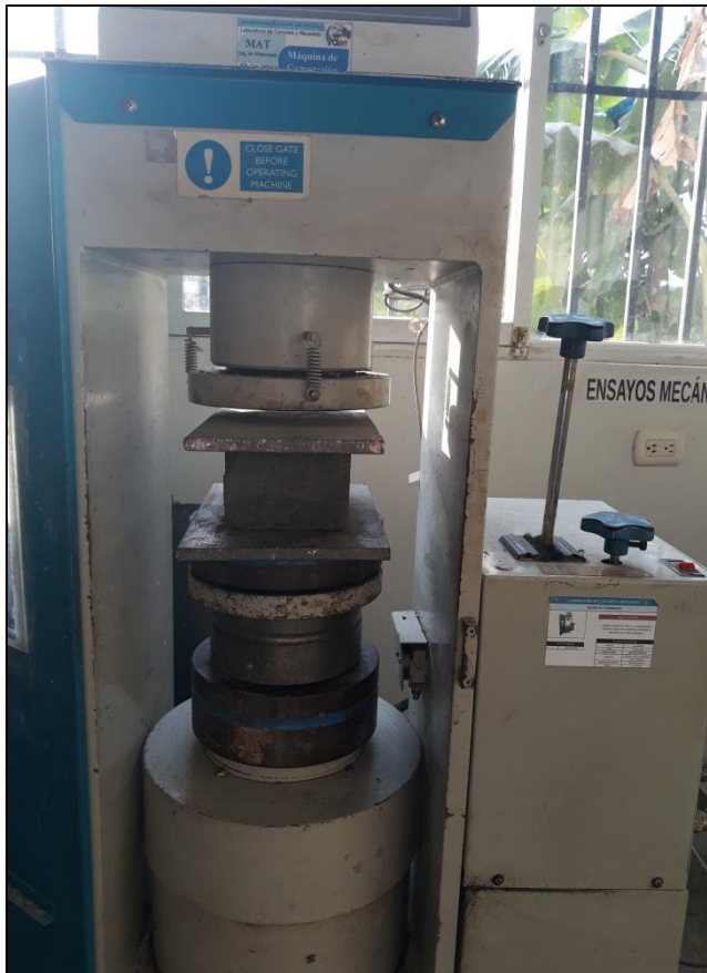
Figura 49. Máquina para resistencia a compresión. Laboratorio de concreto reciclado - UNT
