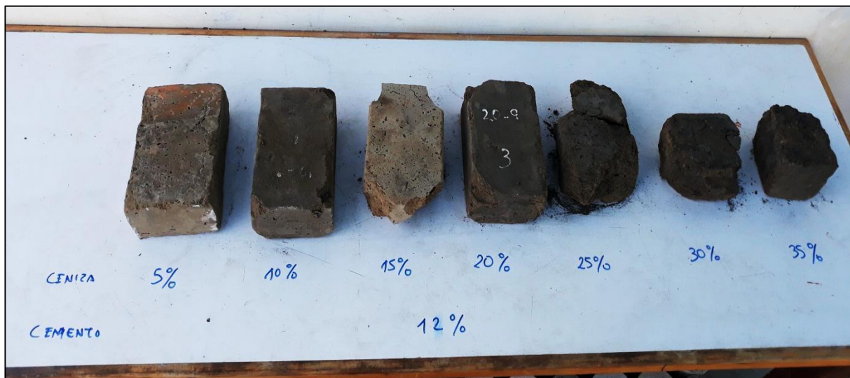
Figura 44. Adobes suelo, ceniza (5-35%) y cemento al 12% después del ensayo a compresión. Taller de Ingeniera materiales - UNT
