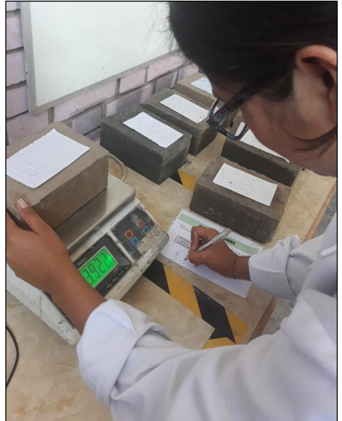
Figura 46. Peso de los adobes para determinar el tiempo de secado. Taller de Ingeniería materiales - UNT
