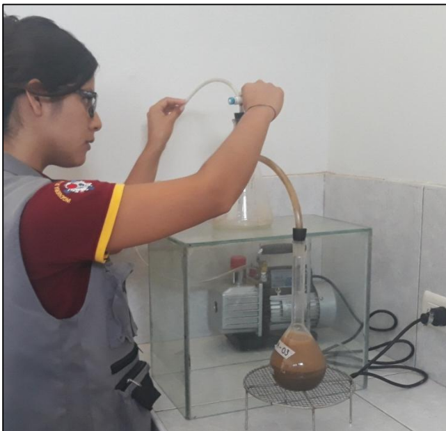
Figura 44. Tesista sacando los vacíos de la fiola con la muestra. Laboratorio de concreto reciclado - UNT
