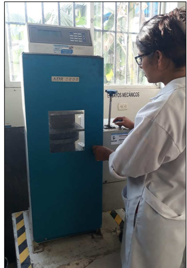
Figura 43. Ensayo de compresión de adobes. Laboratorio de concreto reciclado - UNT
