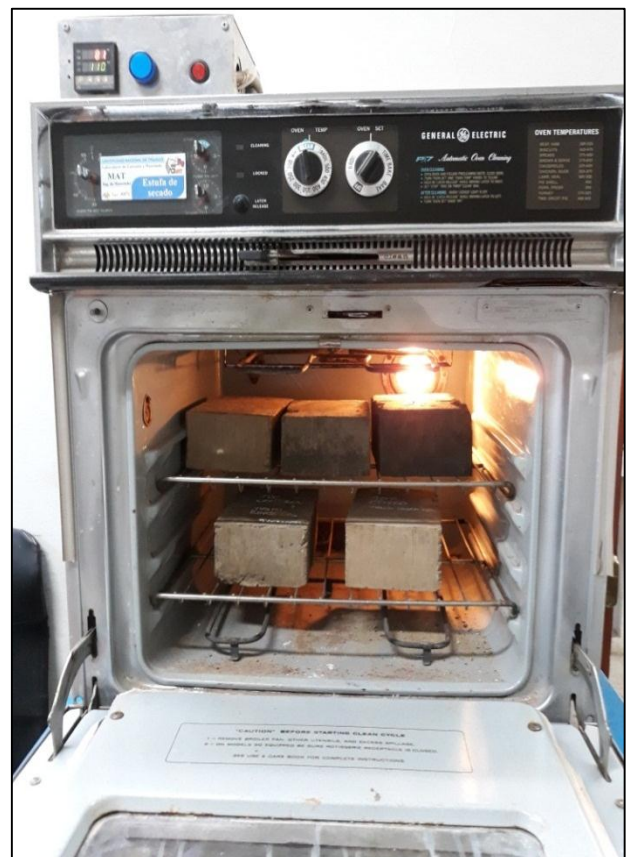
Figura 47. Secado al horno de adobes después del ensayo de durabilidad. Laboratorio de concreto reciclado - UNT
