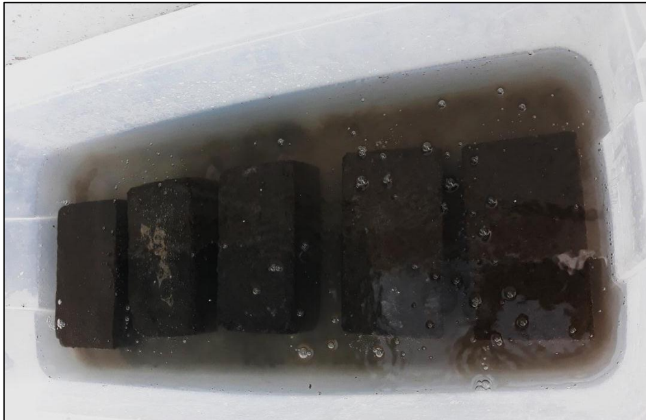
Figura 45. Ensayo de durabilidad en los adobes con distintos porcentajes de ceniza Taller de Ingeniería materiales - UNT
