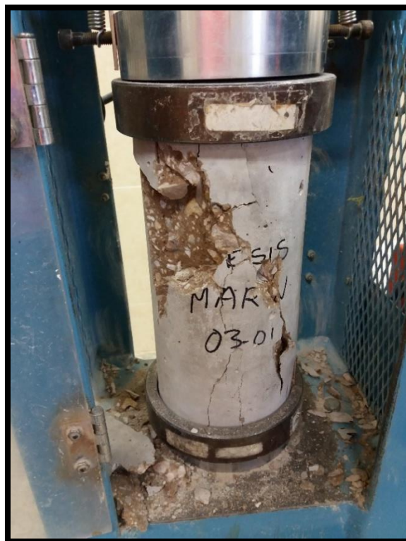
Figura 39 Rotura de probetas.
