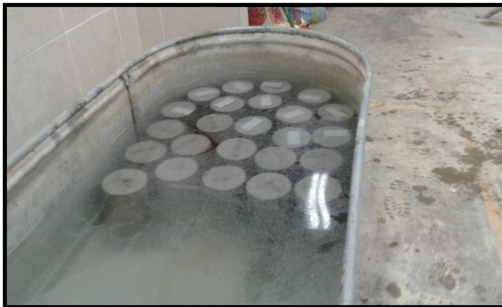
Figura 35 Curado de probetas en laboratorio.
