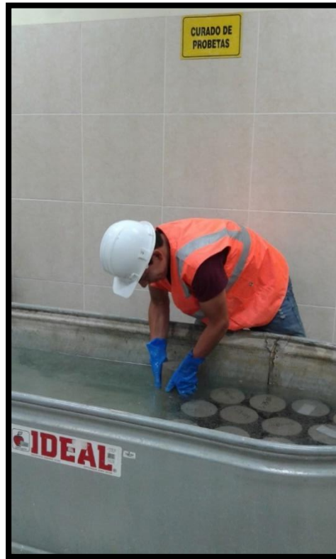
Figura 34 Curado de probetas en laboratorio.
