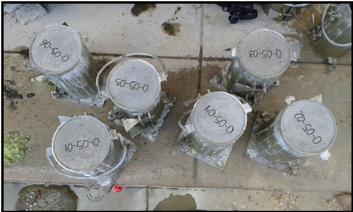
Figura 31 Probetas para curarlas en laboratorio.
