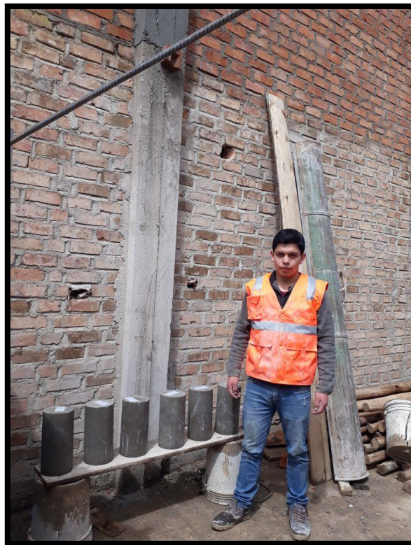
Figura 29 Acondicionamiento de probetas en obra.
