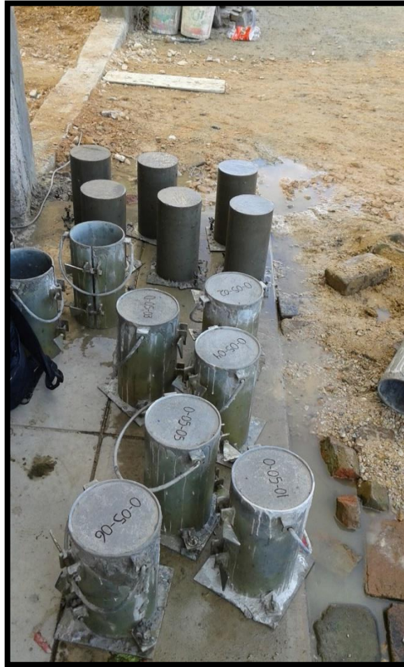
Figura 26 Desencofrado de probetas a las 24 horas.
