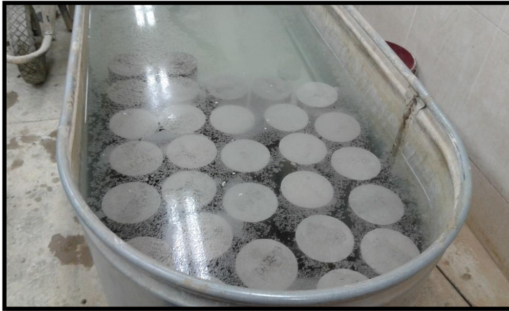
Figura 32 Curado de probetas en el concreto.
