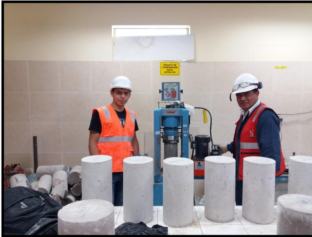
Figura 38 Rotura de probetas.
