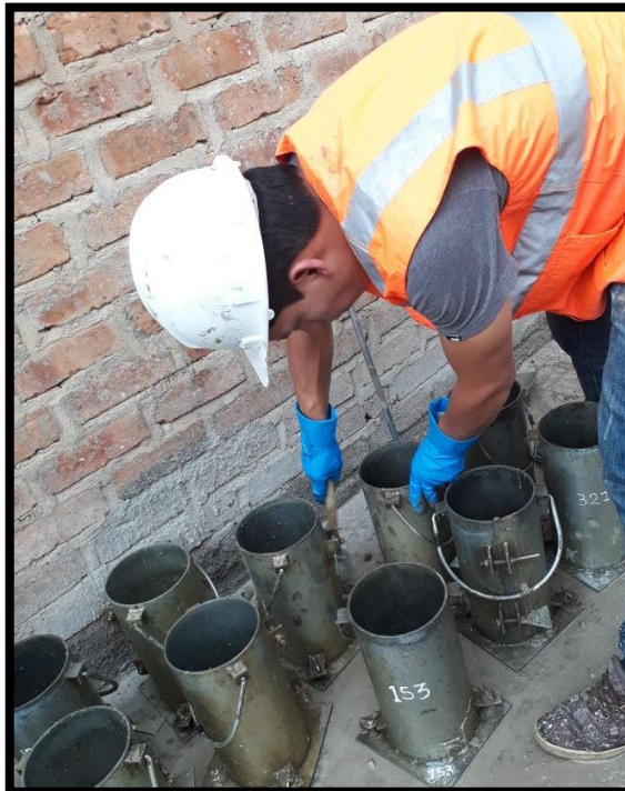
Figura 15 Acondicionamiento de moldes.
