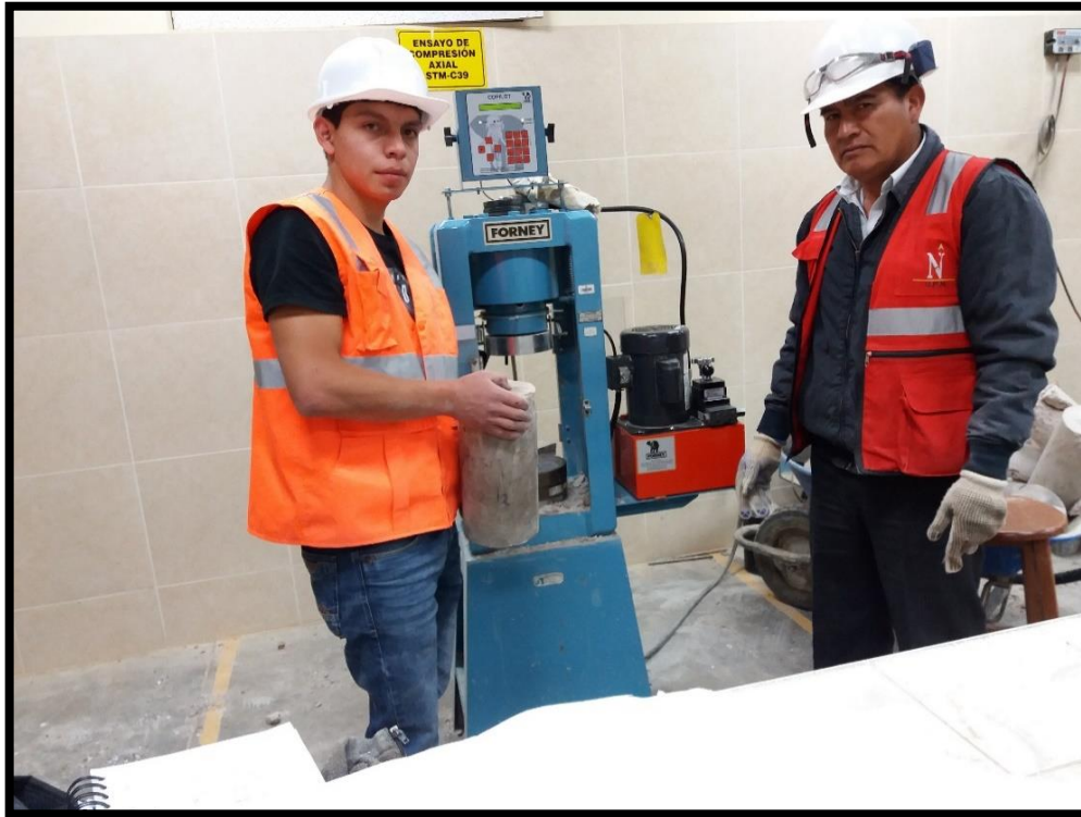
Figura 36 Rotura de probetas.
