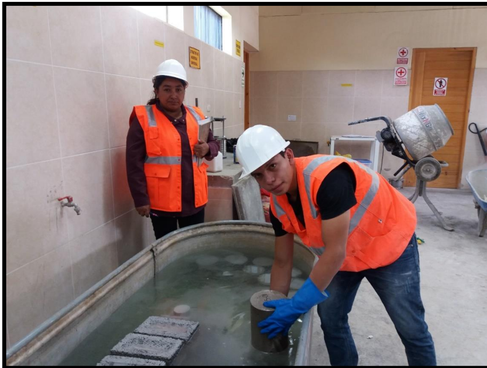
Figura 33 Curado de probetas en el concreto.
