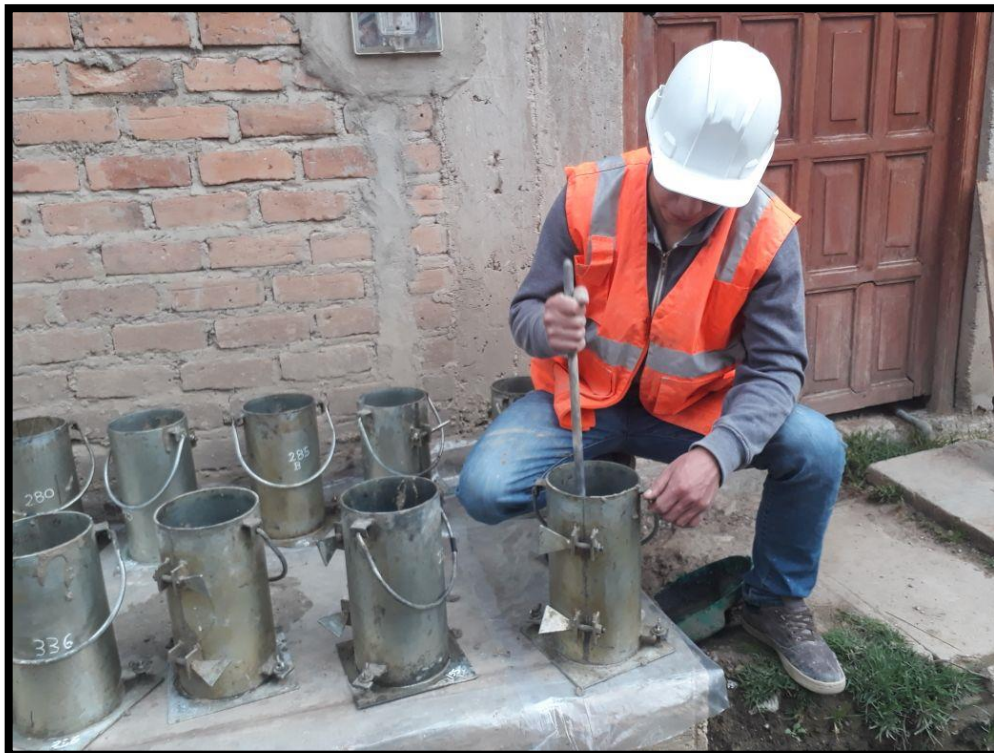
Figura 17 Chuseado de concreto.
