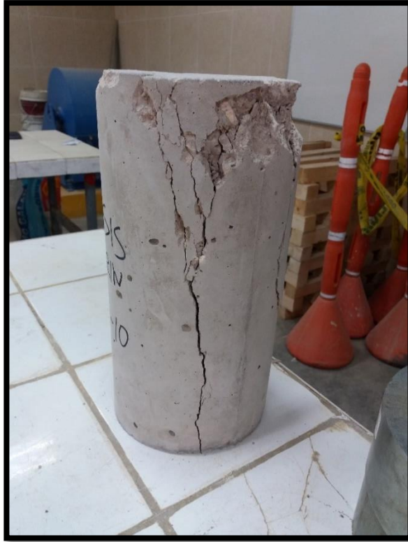
Figura 40 Rotura de probetas.
