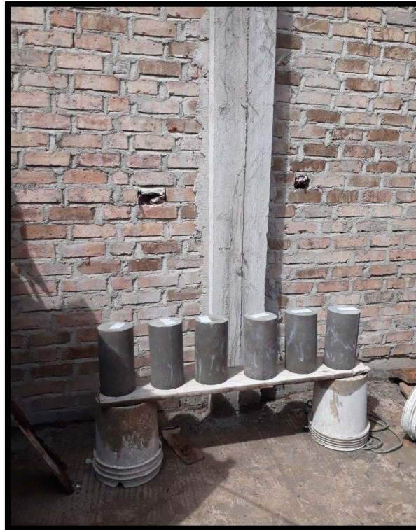
Figura 28 Probetas curadas en obra.
