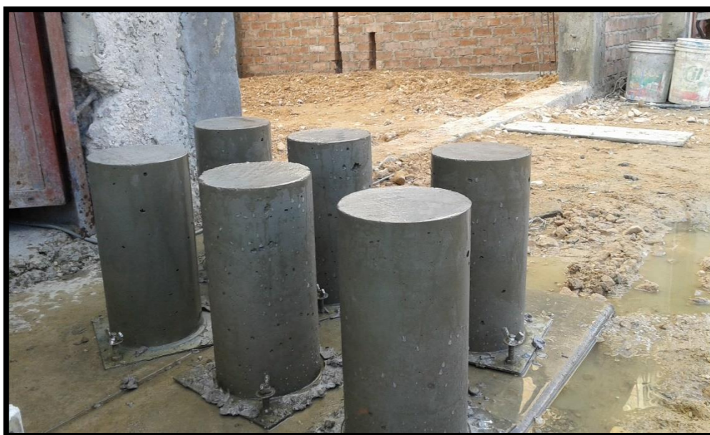
Figura 27 Probetas curadas en obra.
