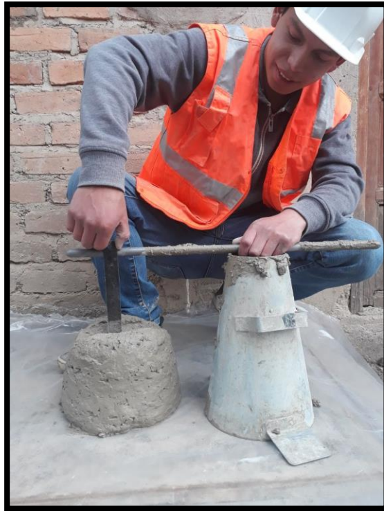
Figura 14 Medición del asentamiento.
