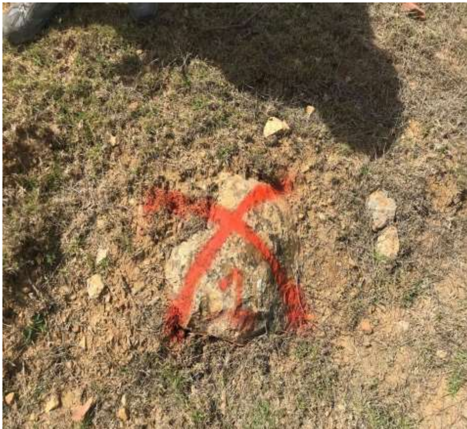
Figura 18 el BM1 Georreferenciación
