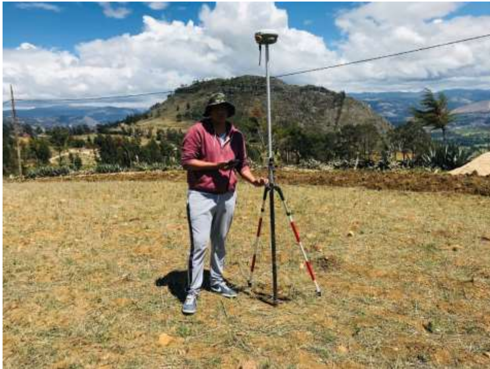
Figura 19 Obtención de los puntos de control con GPS Diferencial con base R6
