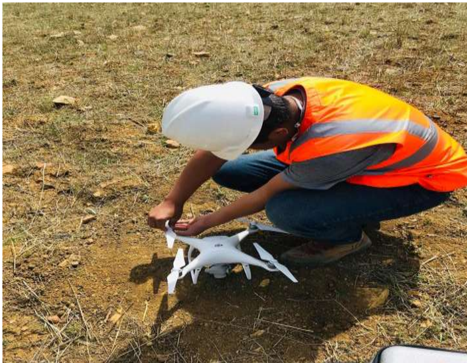
Figura 20 Armandó el RPA PHANTOM 4 PRO
