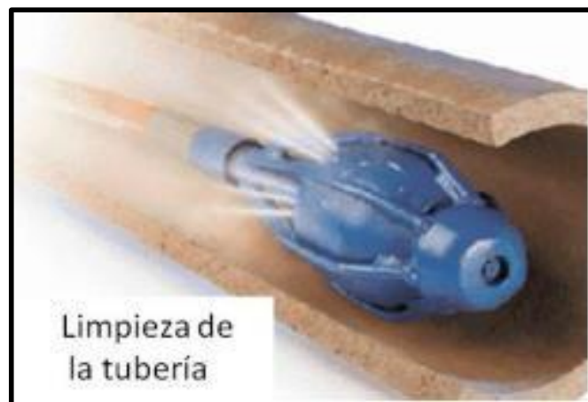
Figura 13. Limpieza de la tubería con un chorro a alta presión Fuente: Fernández, 2014
