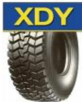
Empleada para aquellos ejes de tracción, en camiones de carga que transitan en carreteras mixtas.
