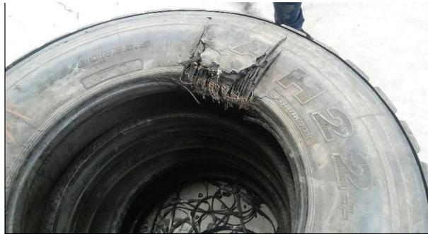
Figura 15: Fallos de calidad – Rotura de casco.
