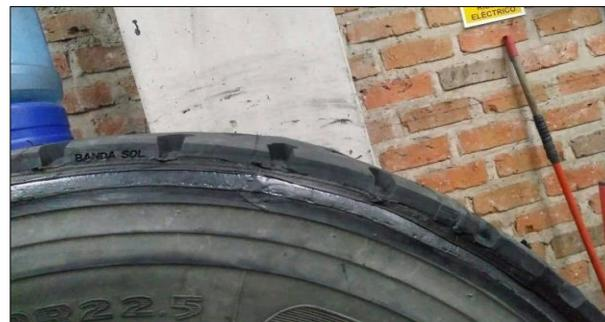
Figura 16: Fallos de calidad- Levantamiento de banda.
