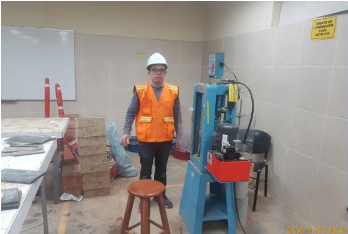
Figura 21. Ensayo de flexión de los bloques de tierra comprimida
