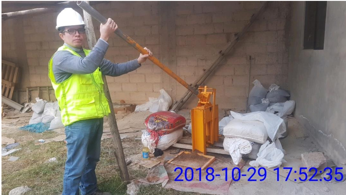
Figura 18. Instantes en donde se compacta el bloque de tierra comprimida
