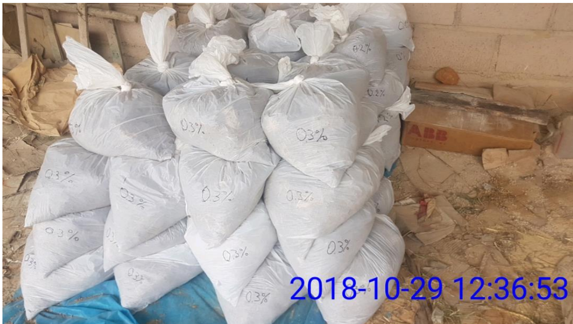
Figura 16. Material mezclado con sus diversos porcentajes de fibra de seudotallo de plátano
