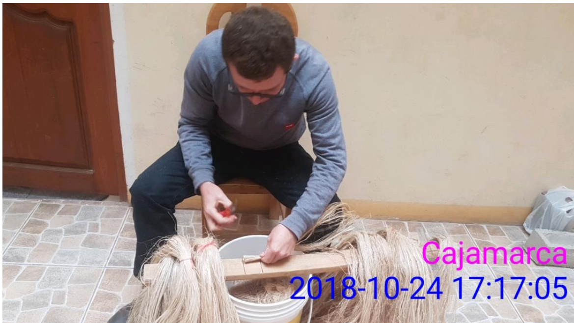
Figura 10. Preparación de la fibra a una longitud de 6cm
