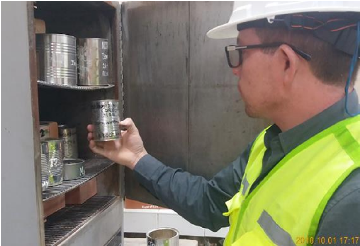
Figura 12. Colocando las muestras al horno
