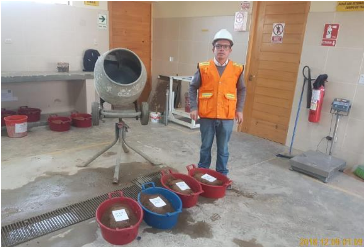
Figura 23. Bloques dejándolos reposar 20 minutos luego de retirar el agua
