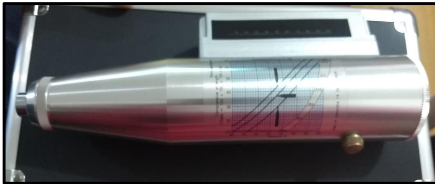
Figura 9: Esclerómetro de Schmidt con el cual se realizó el ensayo. Fuente: Elaboración propia
