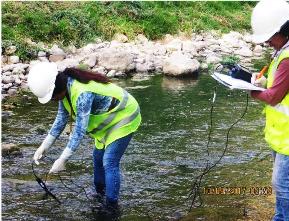
Fotografía 4. Manipulación del equipo multiparámetro
