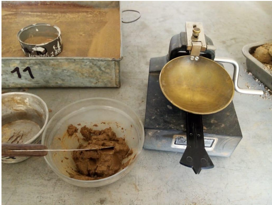
Figura 43. Mezcla del material con agua para determinar el límite líquido.
