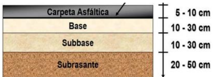
Fig. 2. Capas de pavimentos flexibles.
