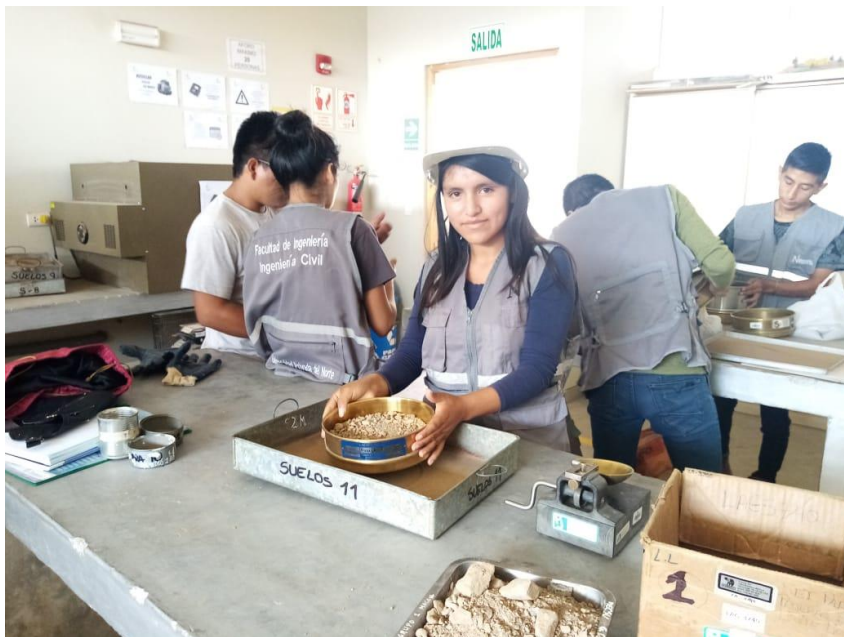
Figura 42. Tamizado por la malla N° 40 para realizar el ensayo de Límite Plástico.
