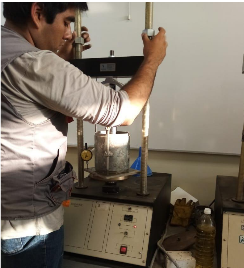
Figura 64. Personal de laboratorio realizando el ensayo de penetración.
