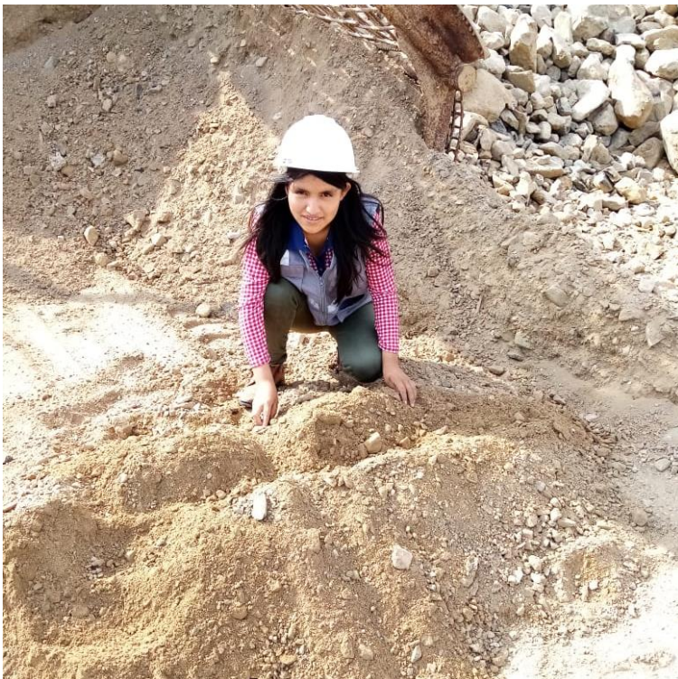
Figura 36. Extracción de la muestra por cuarteo de la cantera Bauner S.A.
