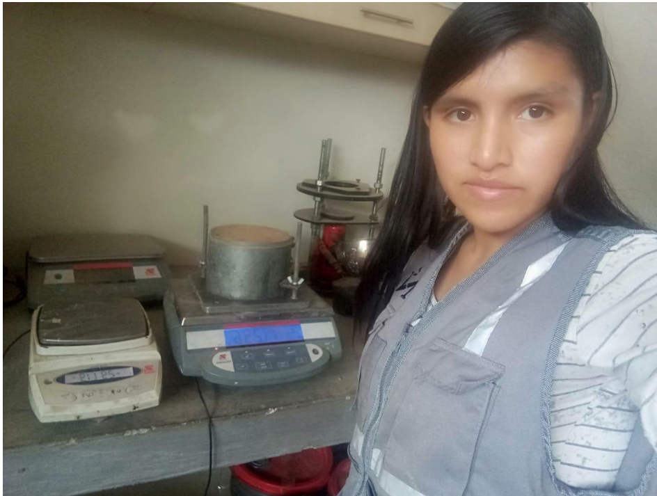
Figura 49. Proctor Modificado con la adición del 2% de cemento.
