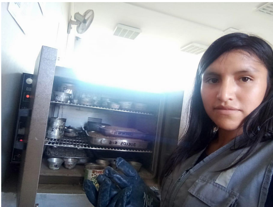
Figura 40. Secado en el horno del agregado fino retenido en la malla N° 200.
