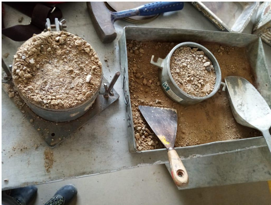
Figura 54. Desmolde para la toma de muestras para la humedad óptima y Densidad Seca Máxima.
