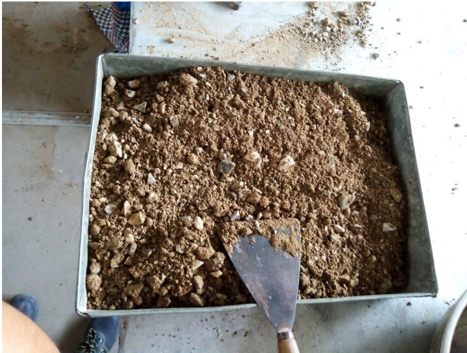
Figura 47. Preparación de los 6000 gr de muestra para cada ensayo.
