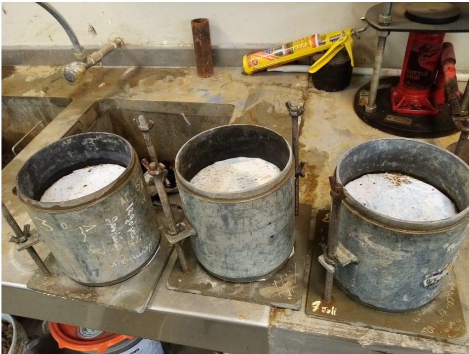
Figura 62. Moldes en reposo fuera del agua para luego realizar el ensayo de penetración.
