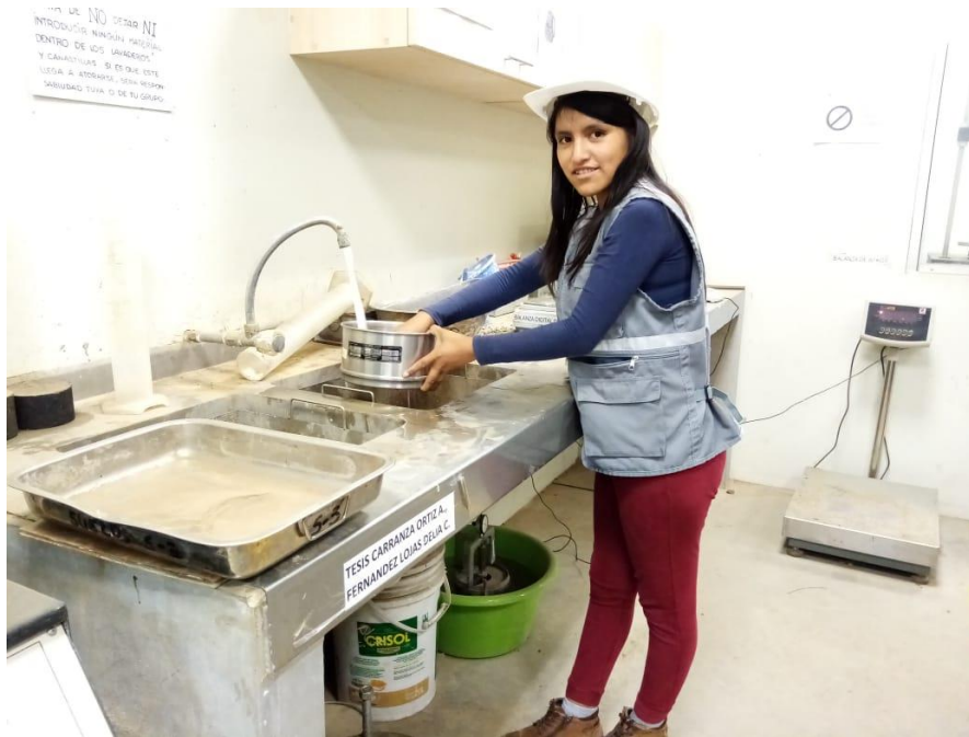
Figura 39. Lavado del agregado fino en la malla N° 200.
