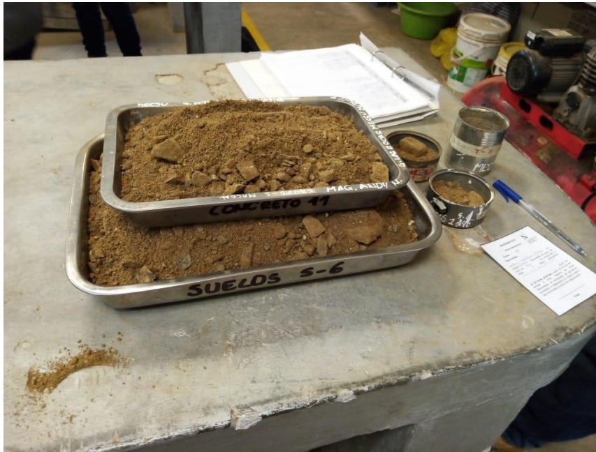
Figura 37. Depósito del material en recipientes metálicos para determinar el porcentaje de humedad y los posteriores ensayos.
