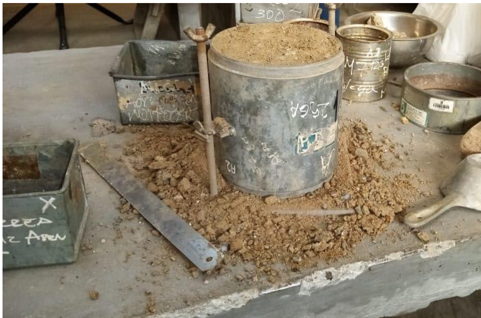
Figura 58. Enrazado de la muestra de CBR después de ser compactado.
