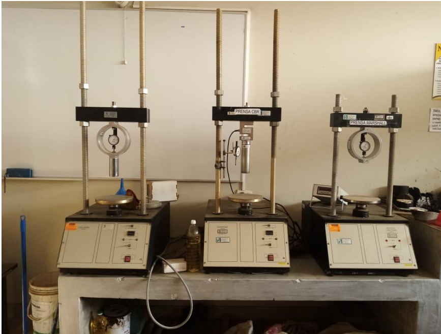
Figura 63. Equipo para realizar el ensayo de CBR.
