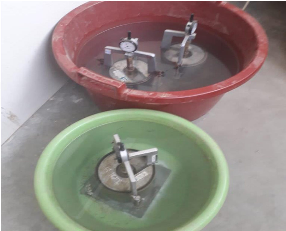
Figura 61. Sumersión de los moldes de CBR con la adición cal.
