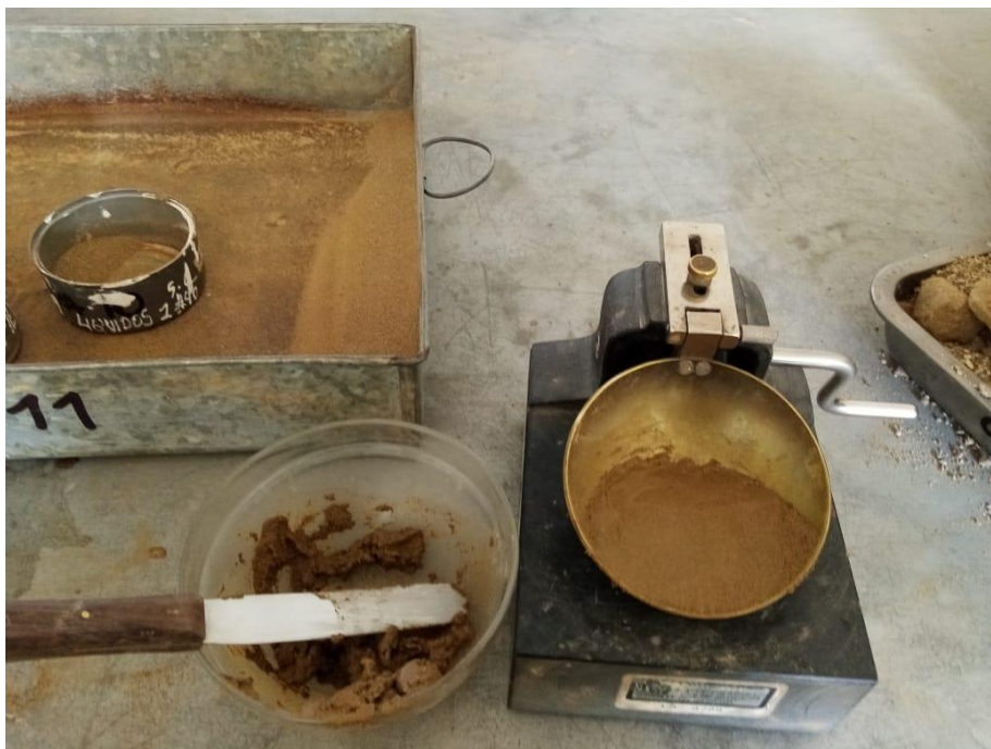
Figura 44. Colocación de la muestra en la copa de Casa Grande
