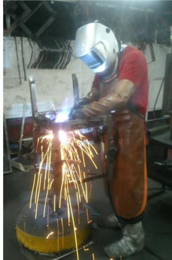
Figura 14: Soldadura de estructura completa en machina 2.
