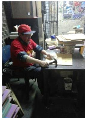
*Figura 12:* Uso de martillos y tachuelas en la operación de enchapado.
