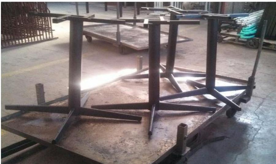
*Figura 11:* Dispositivo con un primer nivel para el traslado de mesas intermedias.
