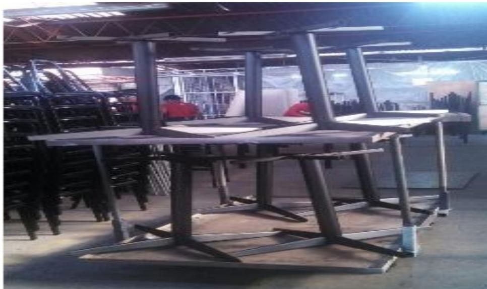
*Figura 22:* Dispositivo con dos niveles para traslado de mesas.
