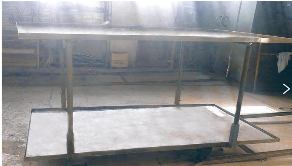
*Figura 20:* Dispositivo con dos niveles para traslado de producto intermedio.
