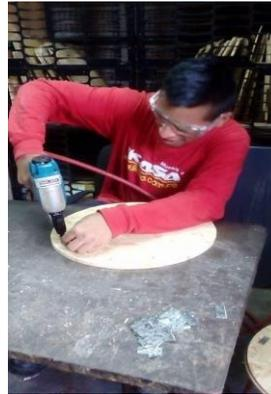
*Figura 23:* Uso de clavilladora y clavillos para la mejora en la operación de enchapado.
