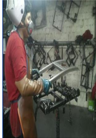
*Figura 4:* Armado de piezas para sillas en la machina 1.
