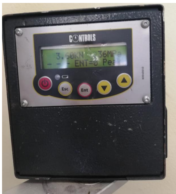
Figura 24 Resultado de la resistencia de la muestra Caja Piso Fuente: Elaboración propia
