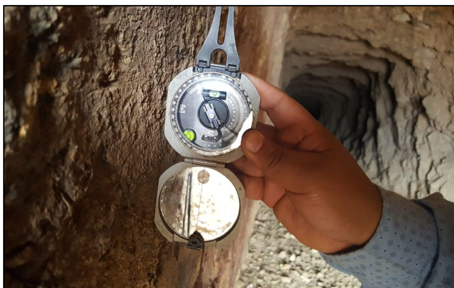
Figura 5. Lectura de la inclinación de la Caja techo.
