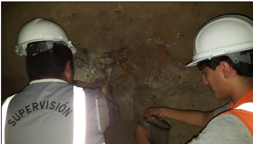
Figura 8. Toma de muestra de mineral en intermedio del desarrollo. Fuente: Elaboración propia.
