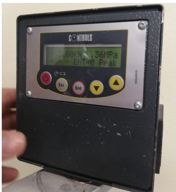
Figura 25 Resultado de la resistencia de la muestra de mineral Fuente: Elaboración propia
