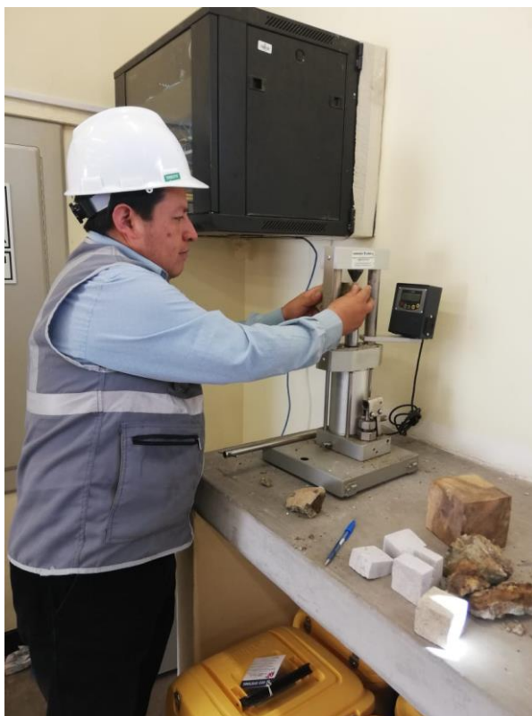
Figura 20 Ensayo de la muestra Caja Techo Fuente: Elaboración propia
