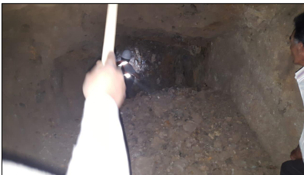
Figura 9. Toma de muestra de mineral en el final del desarrollo Fuente: Elaboración propia
