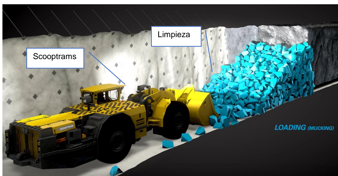
Figura 47: Transporte y limpieza del material obtenido por el proceso de voladura, Fuente: (ATLAS COPCO, 2016)
