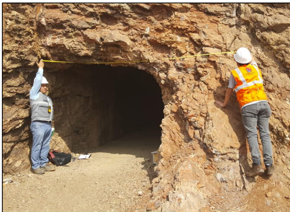
Figura 3. Medida de la potencia de la veta.
