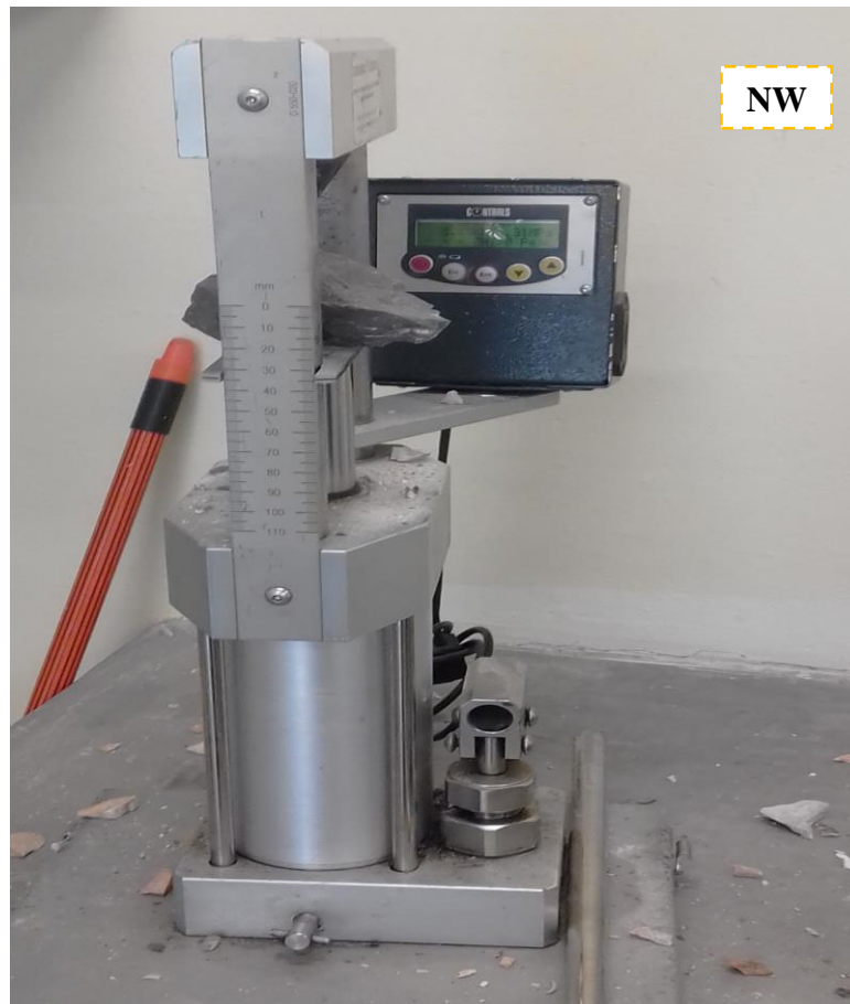
Figura 8. Medición del ensayo de carga puntual de la roca de la estación 2
