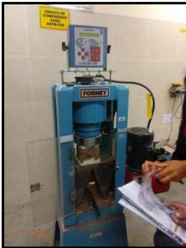
Figura 27: Ensayo en la máquina de compresión axial ASTM-C39.
