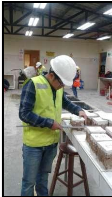
Figura 26: Medición de cubos.
