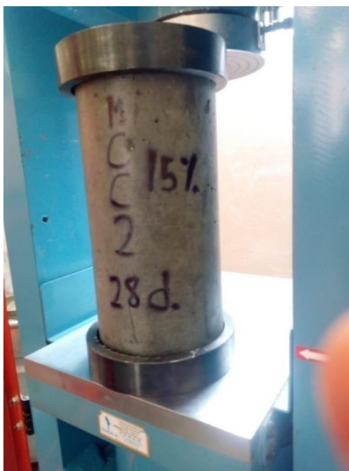
Figura 60. Ensayo de Resistencia a la Compresión (28 días)
