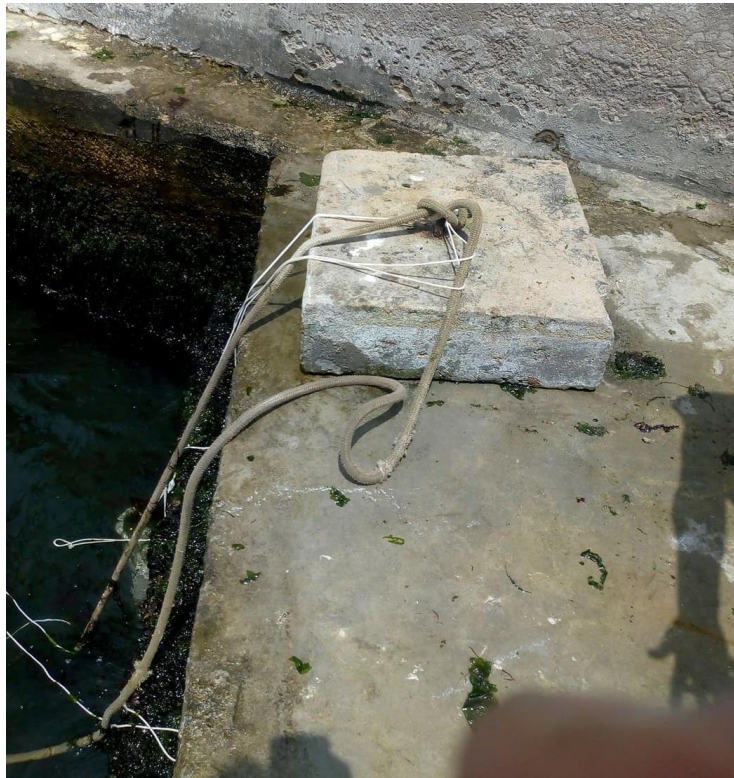
Figura 112. Dado de Concreto que sujeta las Muestras
