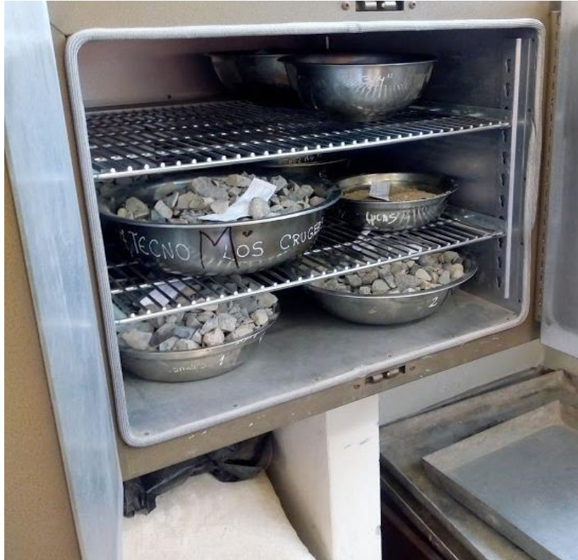
Figura 13. Muestras de los Agregados en el horno para contenido de humedad.
