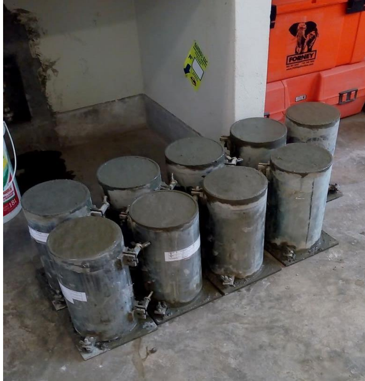
Figura 41. Probetas Cilíndricas de Concreto
