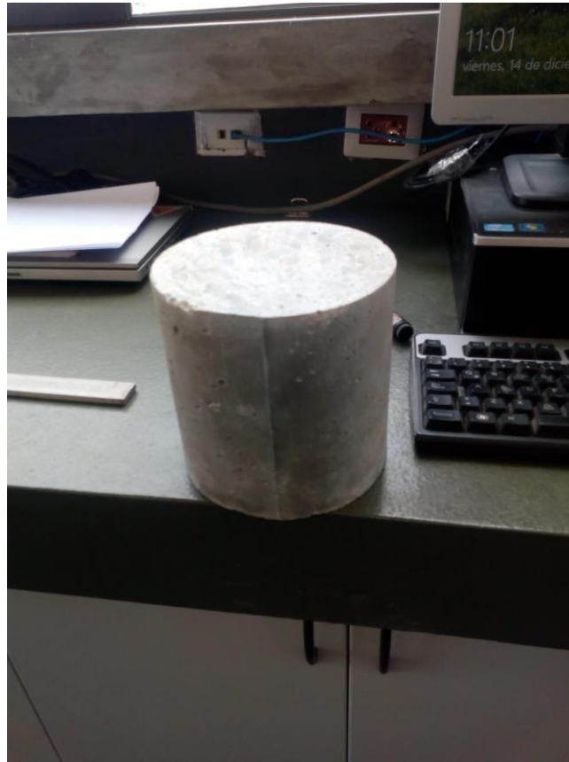
Figura 122. Probeta para el ensayo de permeabilidad
