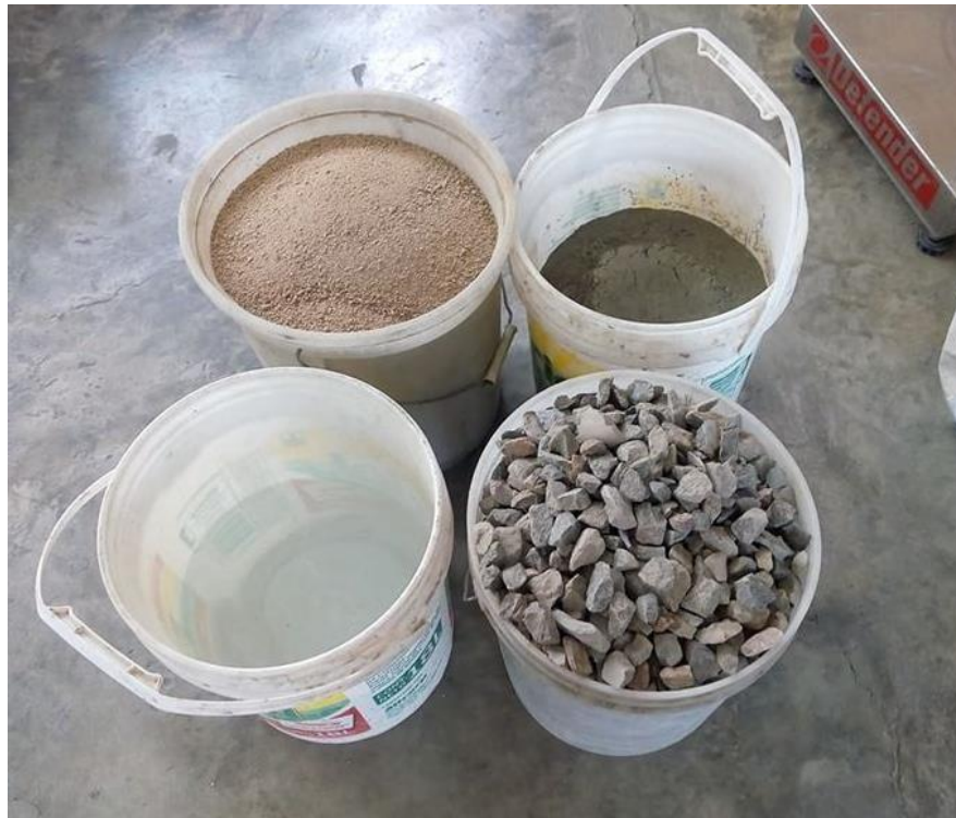
Figura 48. Dosificación de agregados, Cemento y Agua
