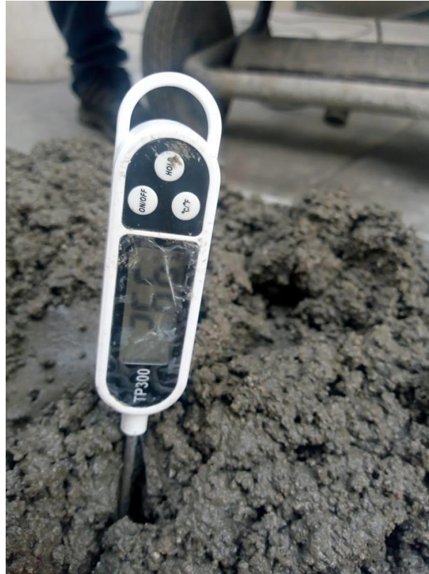
Figura 49. Temperatura del Concreto aditivo + C.V. 15%
