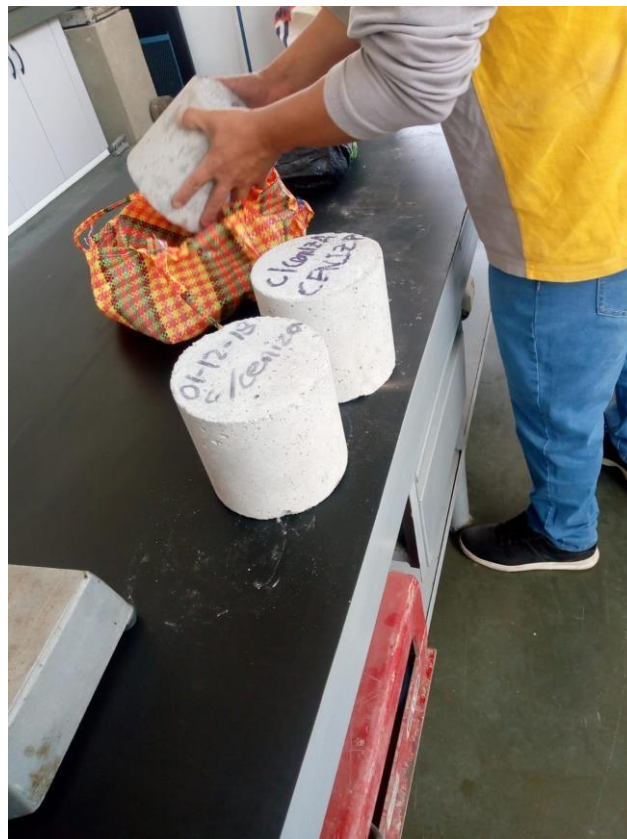
Figura 123. Probetas para colocación para inicio del ensayo de permeabilidad
