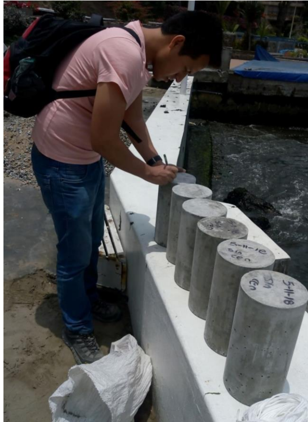
Figura 55. Probetas Expuestas al contacto con el Agua del Mar – Muelle el Dorado
