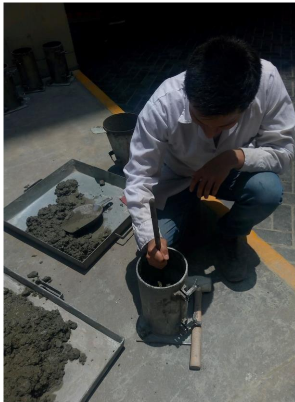
Figura 40. Compactación del Concreto
