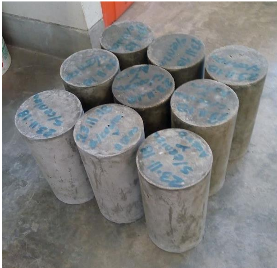
Figura 54. Desencofrado de Probetas Cilíndricas.
