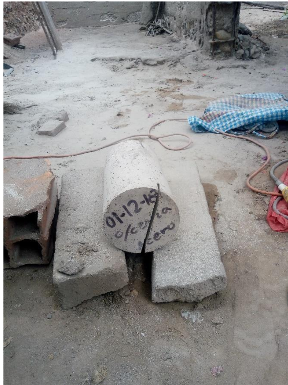
Figura 116. Corte de probetas para el ensayo de carbonatación
