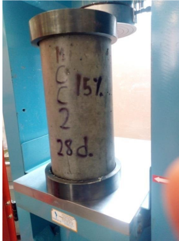
Figura 57. Ensayo de Resistencia a la Compresión (28 días)
