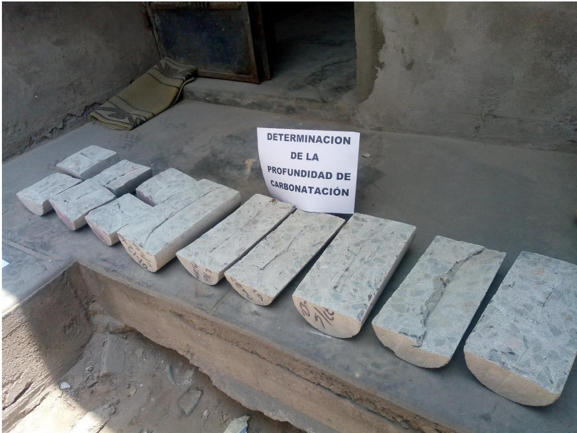
Figura 117. Probetas cortadas para el ensayo de carbonatación
