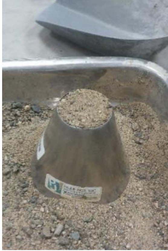
Figura 25. Razado después de apisonar la Arena Fina
