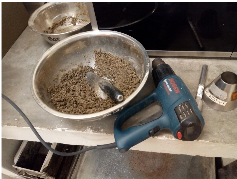
Figura 23. Materiales para la Prueba de Cono de la superficie de humedad
