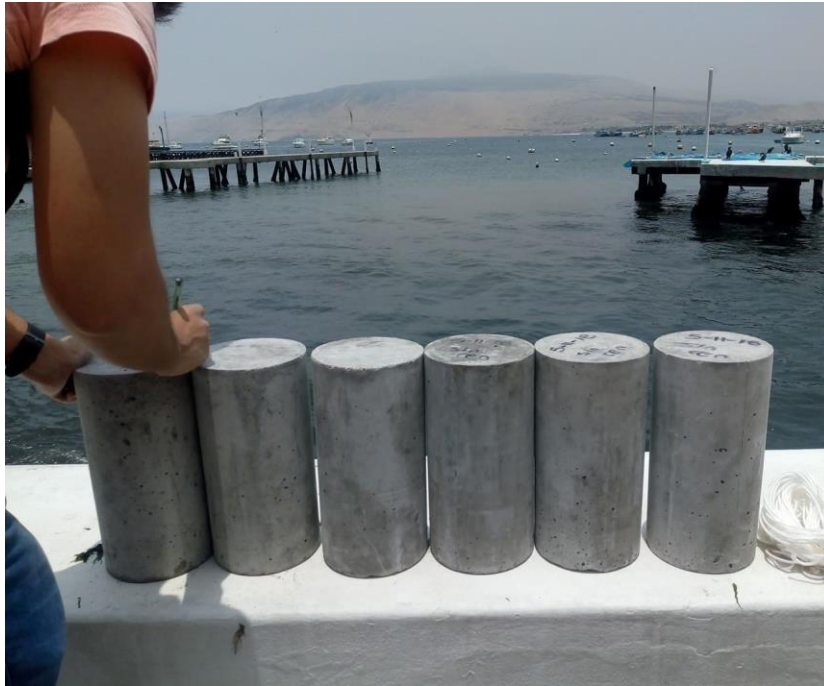
Figura 108. Probetas Cilíndricas Expuestas al Mar – Muelle el Dorado
