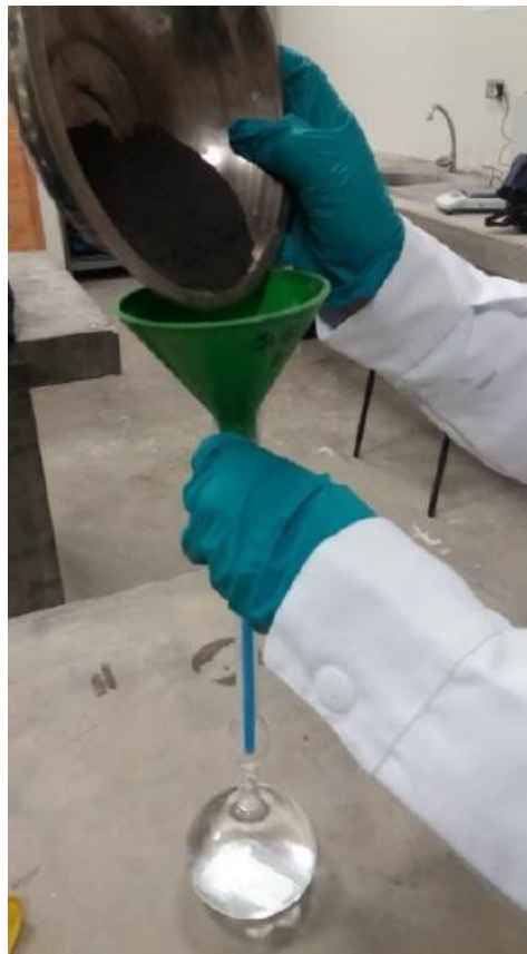
Figura 28. Ensayo para Peso Específico de la Ceniza Volante de Carbón
