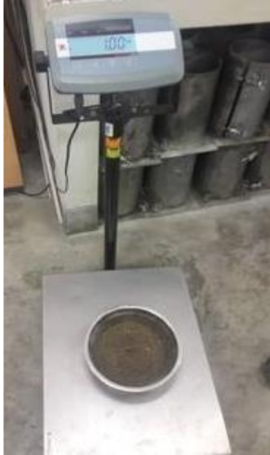
Figura 11. Muestra de agregado fino para contenido de humedad
