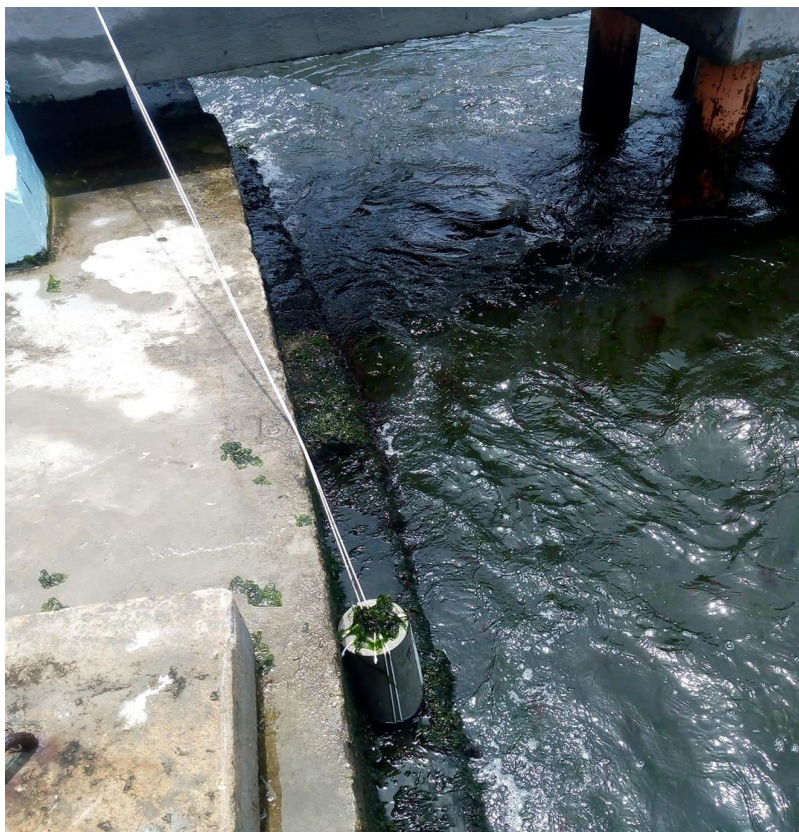
Figura 108. Probetas Cilíndricas Expuestas al Mar – Muelle el Dorado
