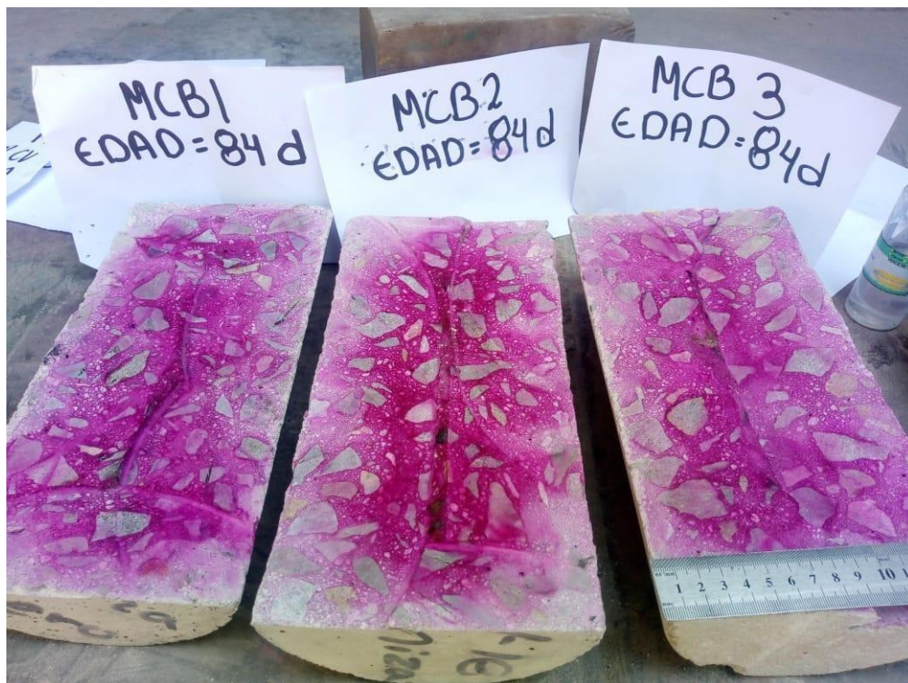
Figura 118. Probetas de concreto convencional cortada transversalmente agregado fenolftaleína para determinar nivel de profundidad de carbonatación
