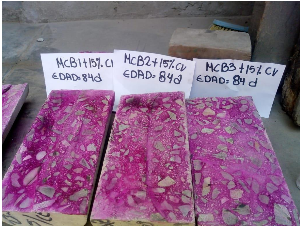
Figura 119. Probetas de concreto con adición de ceniza volante de carbón cortadas transversalmente agregado fenolftaleína para determinar nivel de profundidad de carbonatación
