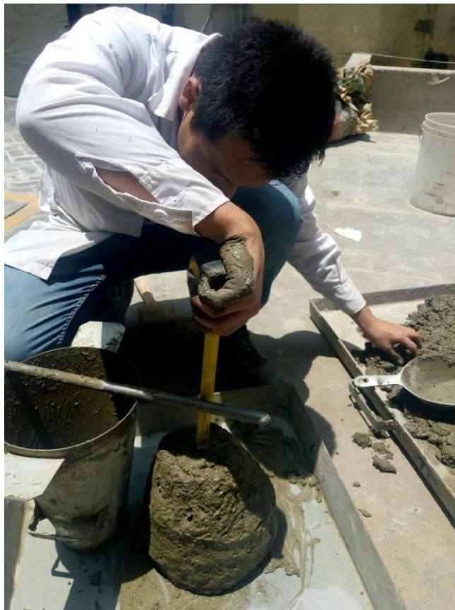
Figura 36. Medida del Slump
