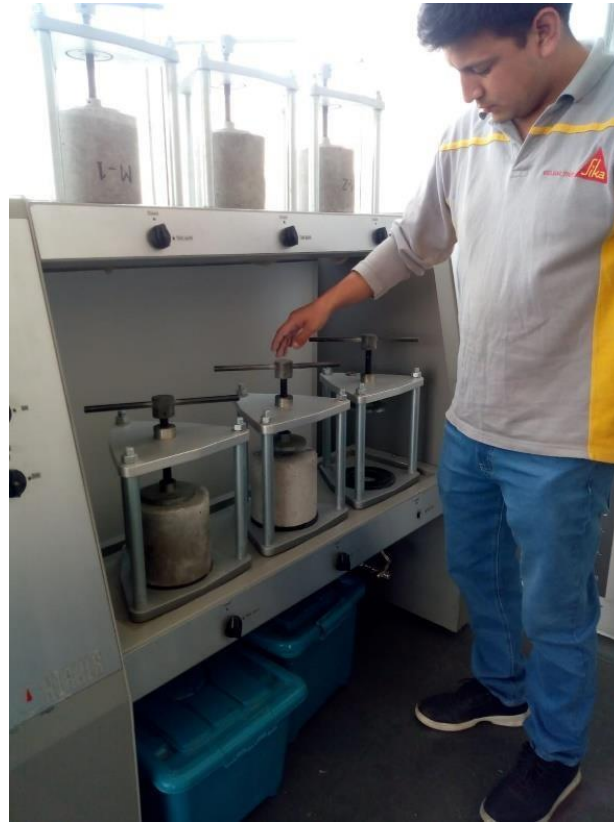
Figura 126. Probetas colocadas para dar inicio con el ensayo de permeabilidad
