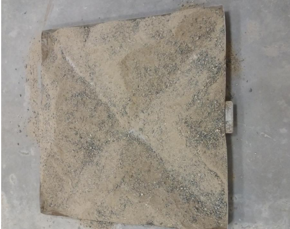
Figura 10. Cuarteo Agregado Fino
