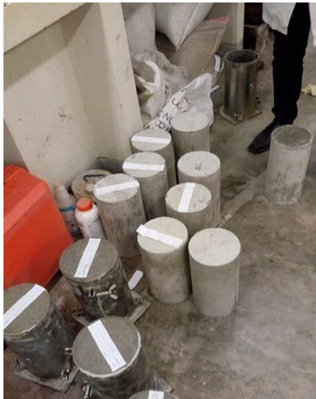
Figura 42. Desencofrado del Concreto
