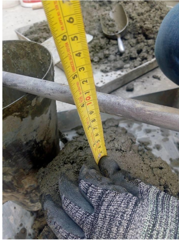
Figura 51. Medida del Slump
