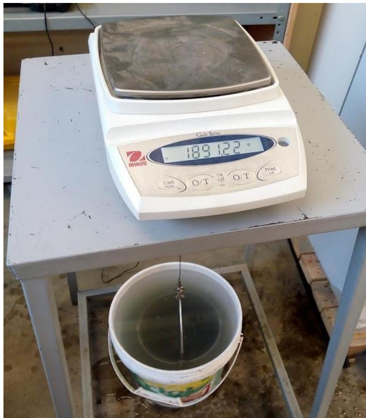
Figura 16. Peso sumergido del Agregado grueso
