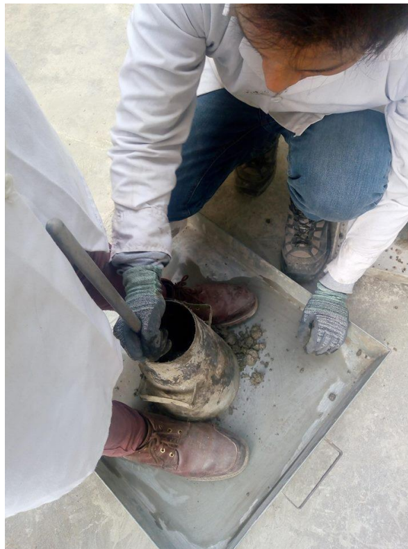
Figura 50. Prueba del Cono de Abrams
