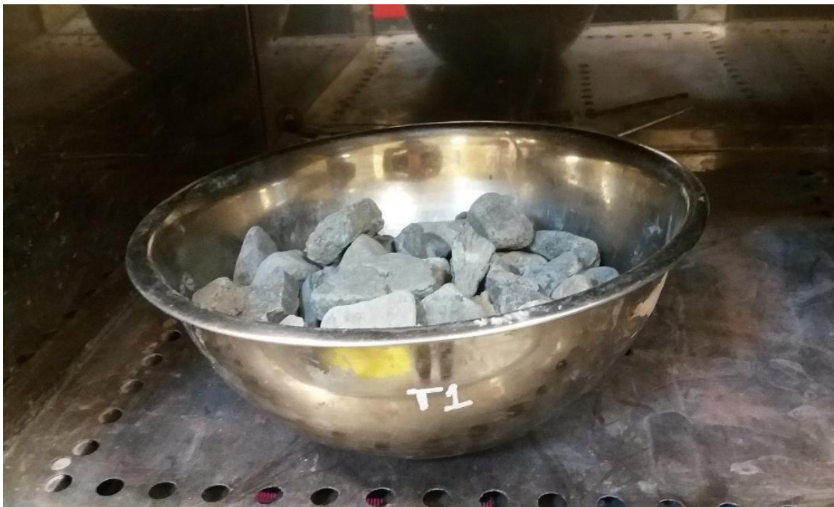
Figura 12. Muestra de agregado grueso para contenido de humedad
