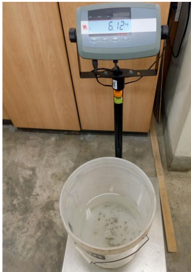
Figura 30. Peso de Agua para Mezcla de Concreto
