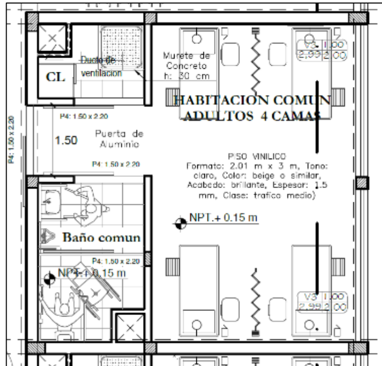
Figura 31: Dotación de servicios en hospitalización
